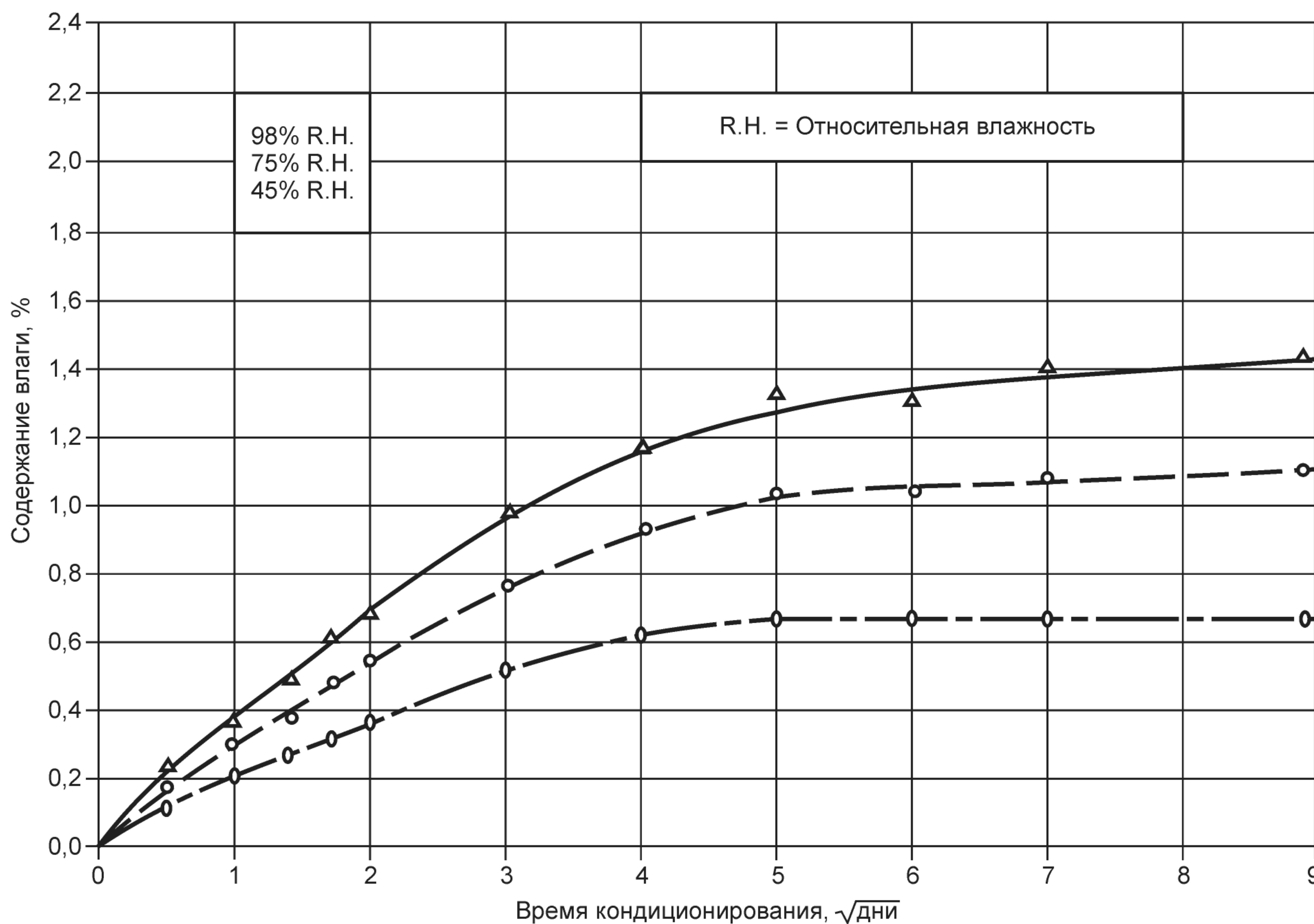
Рисунок 1 — Пример графика влагопоглощения углерод/эпоксидных (0,45—45,0)<sub>s</sub> слоистых материалов из восьми слоев при температуре 48,9 °C (8)
