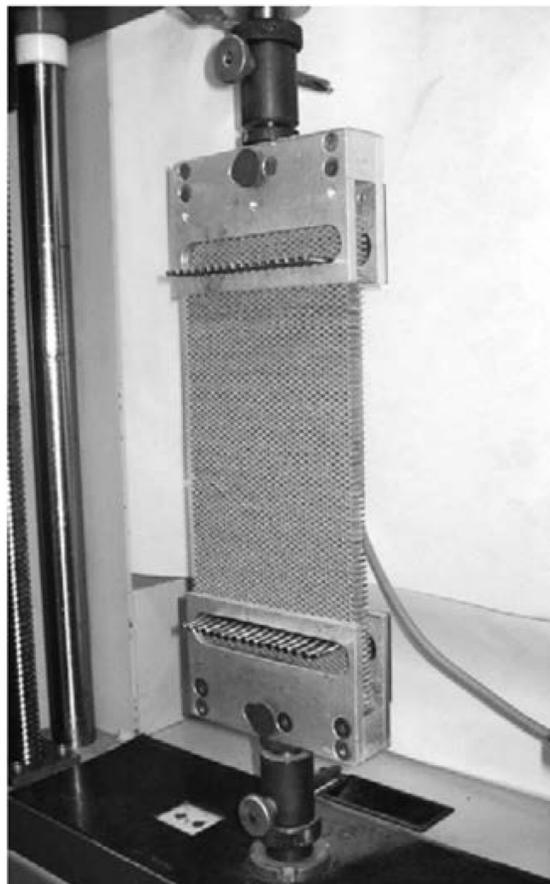
Рисунок 1 — Машина для испытания для определения предела прочности на растяжение в узлах сотового материала внутреннего слоя «сэндвич»-конструкций
