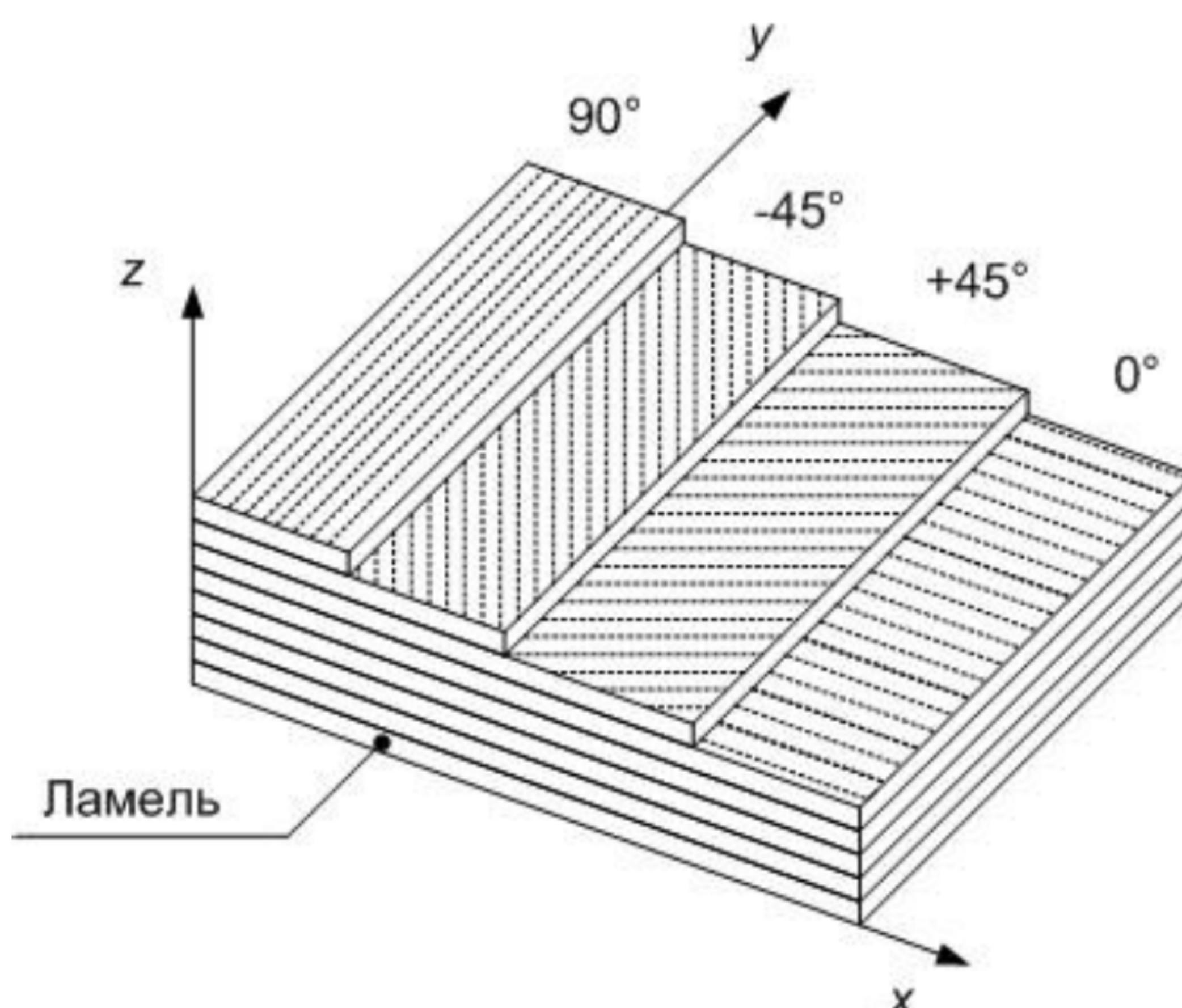
Рисунок 1 – Пример строения ламината конструктивных элементов
