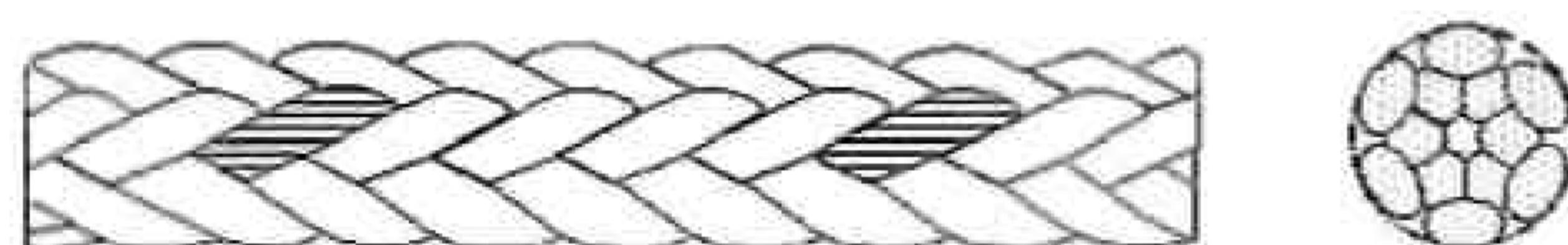
Рисунок 3 — Конфигурация 8-прядного плетёного каната (тип Л)
