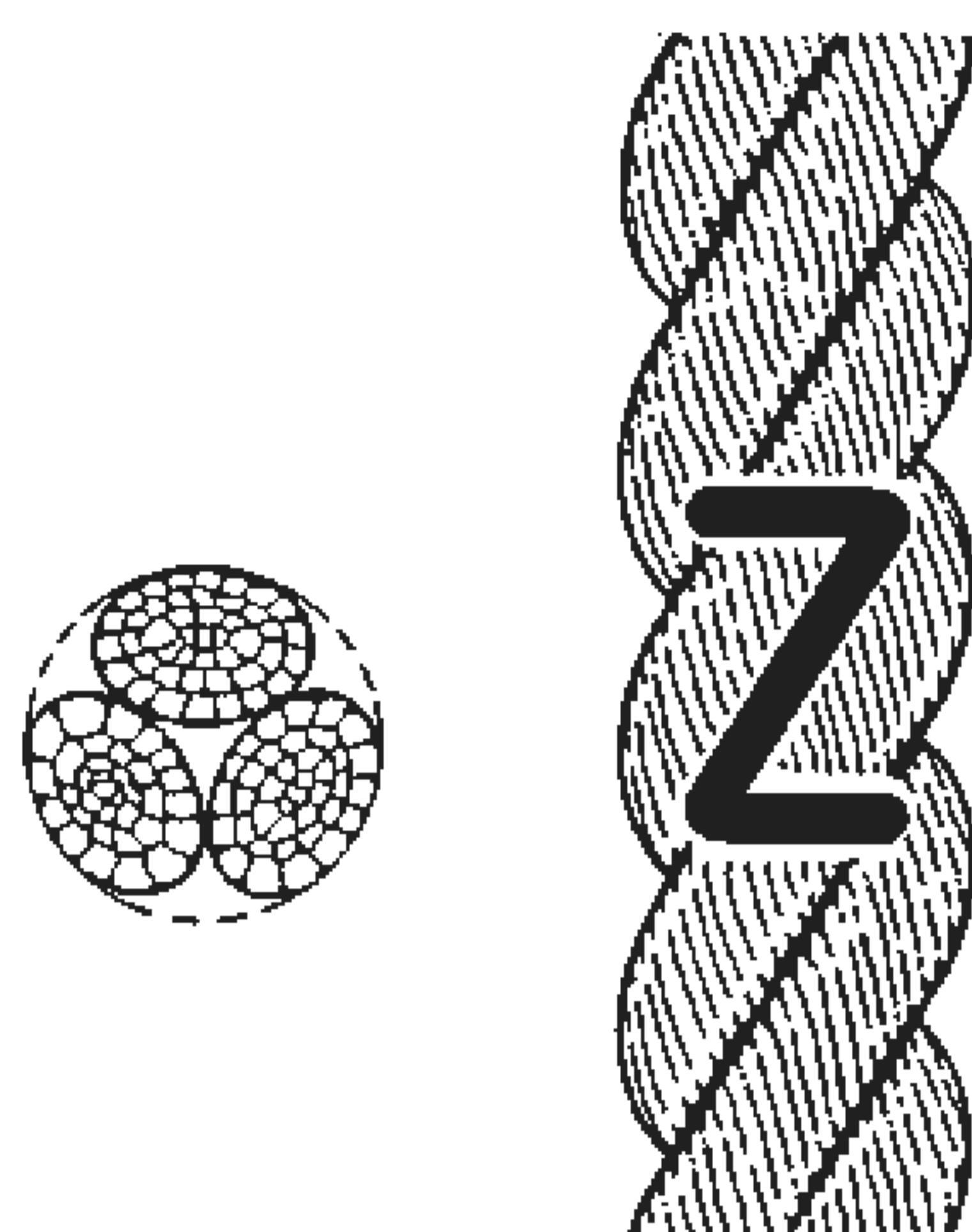
Рисунок 1 — Конфигурация 3-прядного кручёного каната (тип А)
