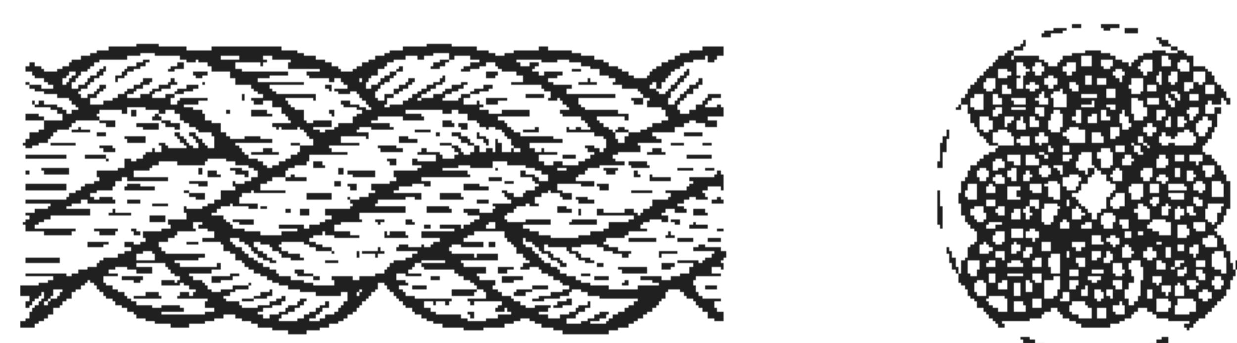
Рисунок 4 — Конфигурация 12-прядного плетёного каната (тип Т)
