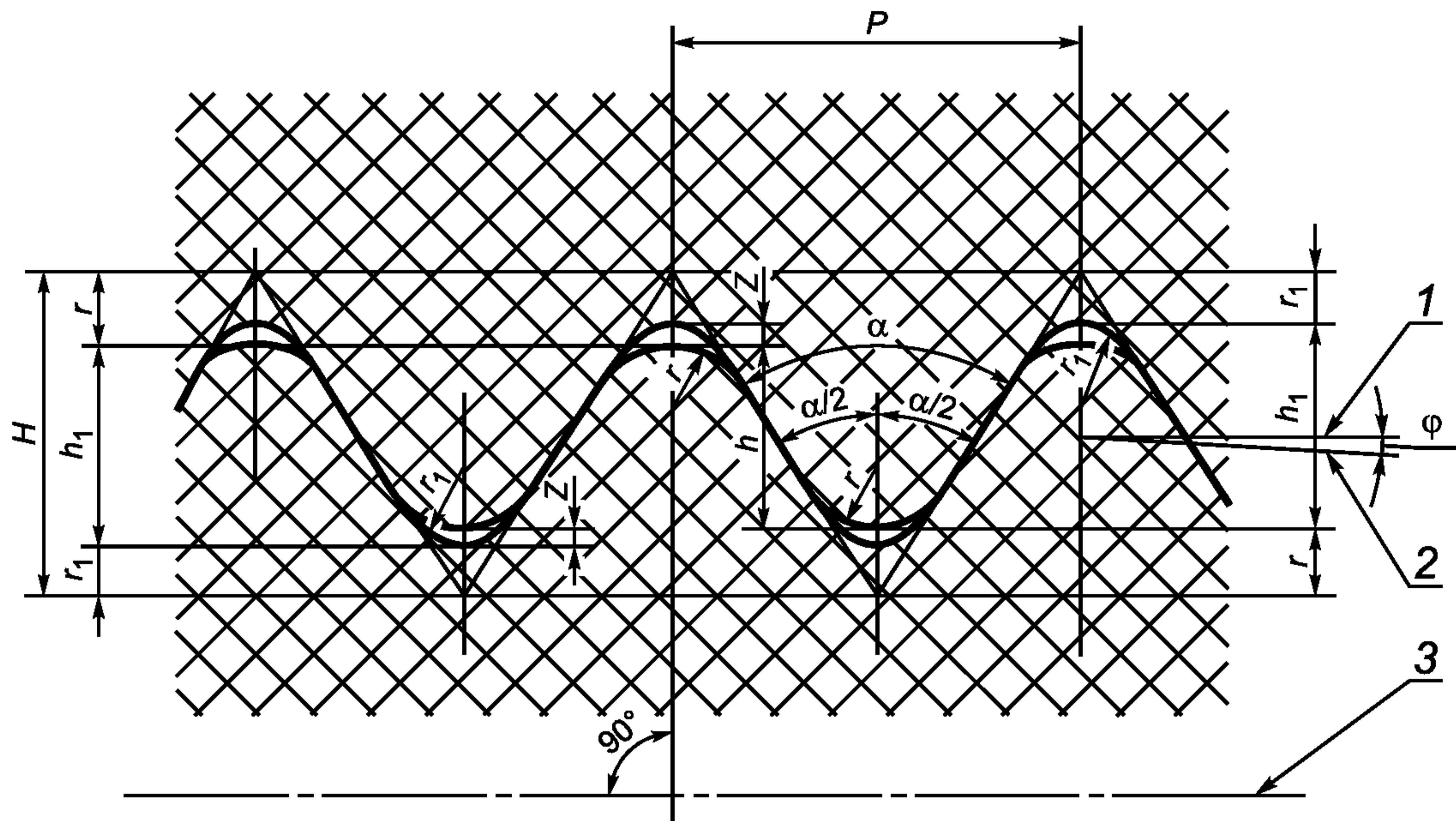
1 — линия, параллельная оси резьбы; 2 — линия среднего диаметра резьбы; 3 — ось резьбы;  $P$  — шаг резьбы (измеряется параллельно оси резьбы);  $H$  — высота исходного профиля;  $h_1$  — высота профиля;  $h$  — рабочая высота профиля;  $\alpha$  — угол профиля;  $Z$  — зазор;  $\phi$  — угол наклона;  $r$ ,  $r_1$  — радиус закругления
