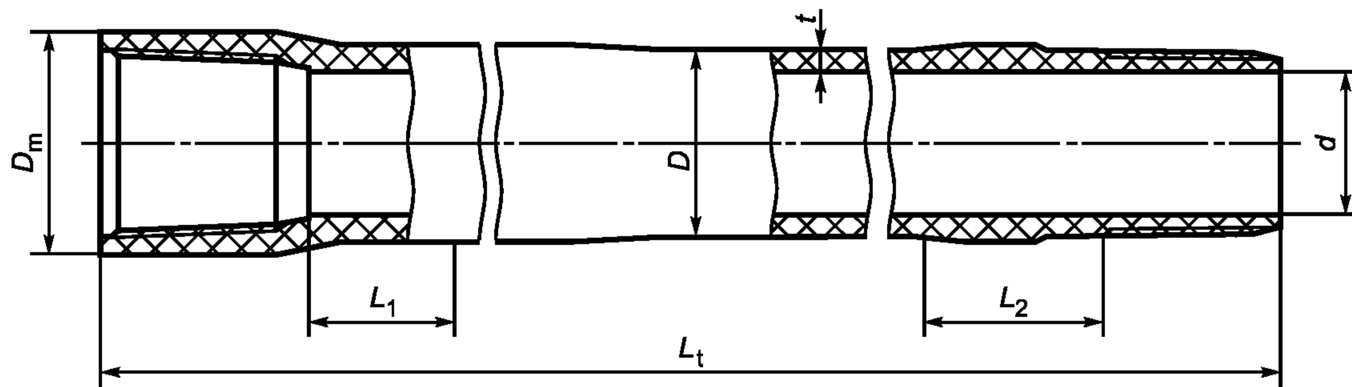
$L_t$  — длина трубы;  $D$  — наружный диаметр трубы;  $D_m$  — диаметр раструба;  $d$  — внутренний диаметр;  $t$  — толщина стенки трубы;  $L_1$  и  $L_2$  — длина зон, на которых разрешено работать цепными, ременными ключами и другим инструментом
