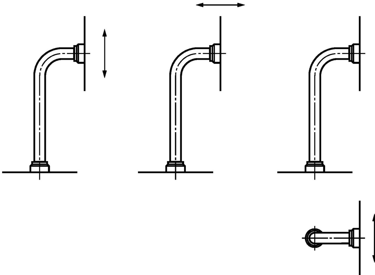
Рисунок С.1 — Направления вибрации испытуемого образца
