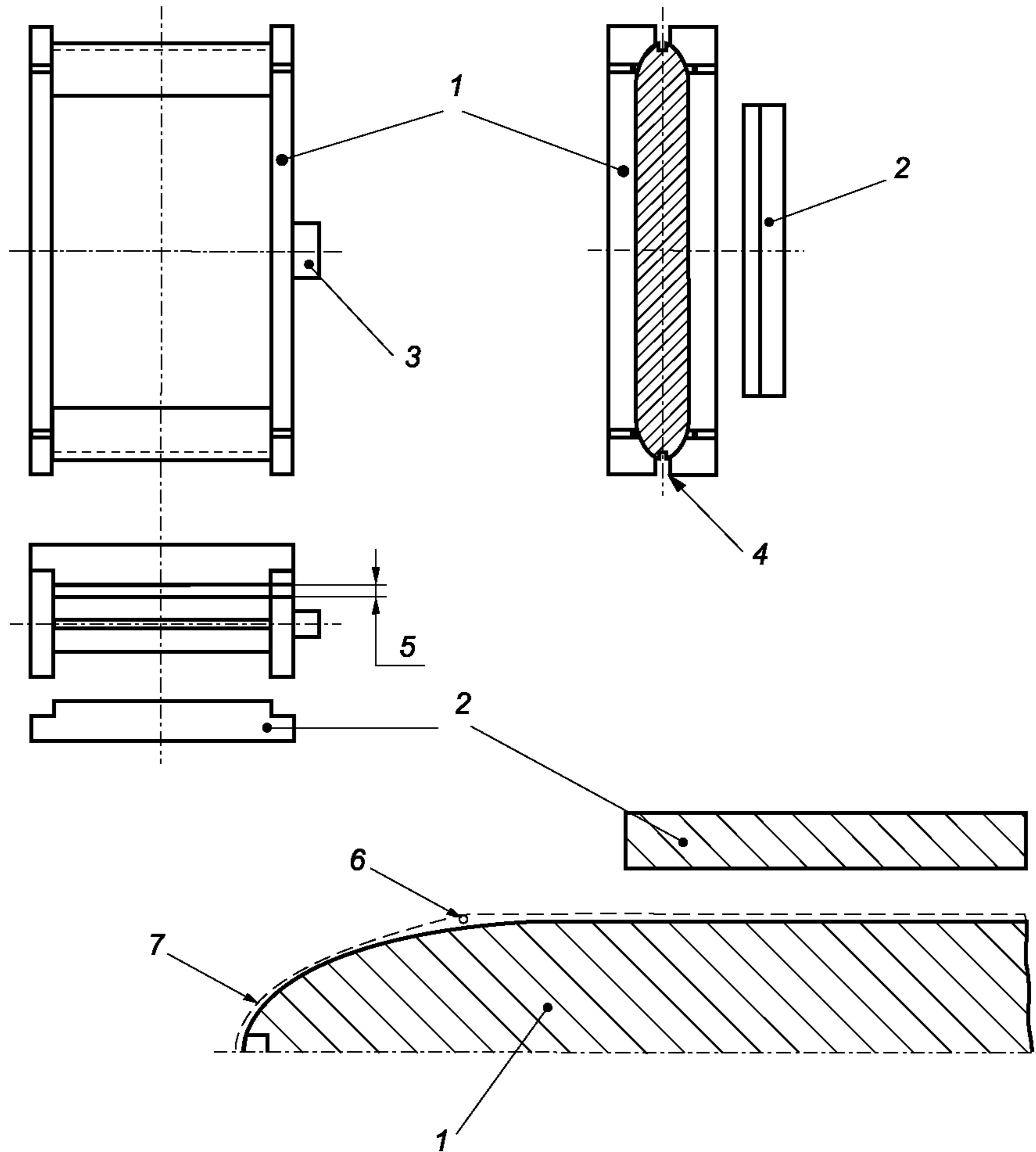
1 – плита; 2 – внешние части; 3 – шпиндельный узел; 4 – паз; 5 – толщина намотки;
