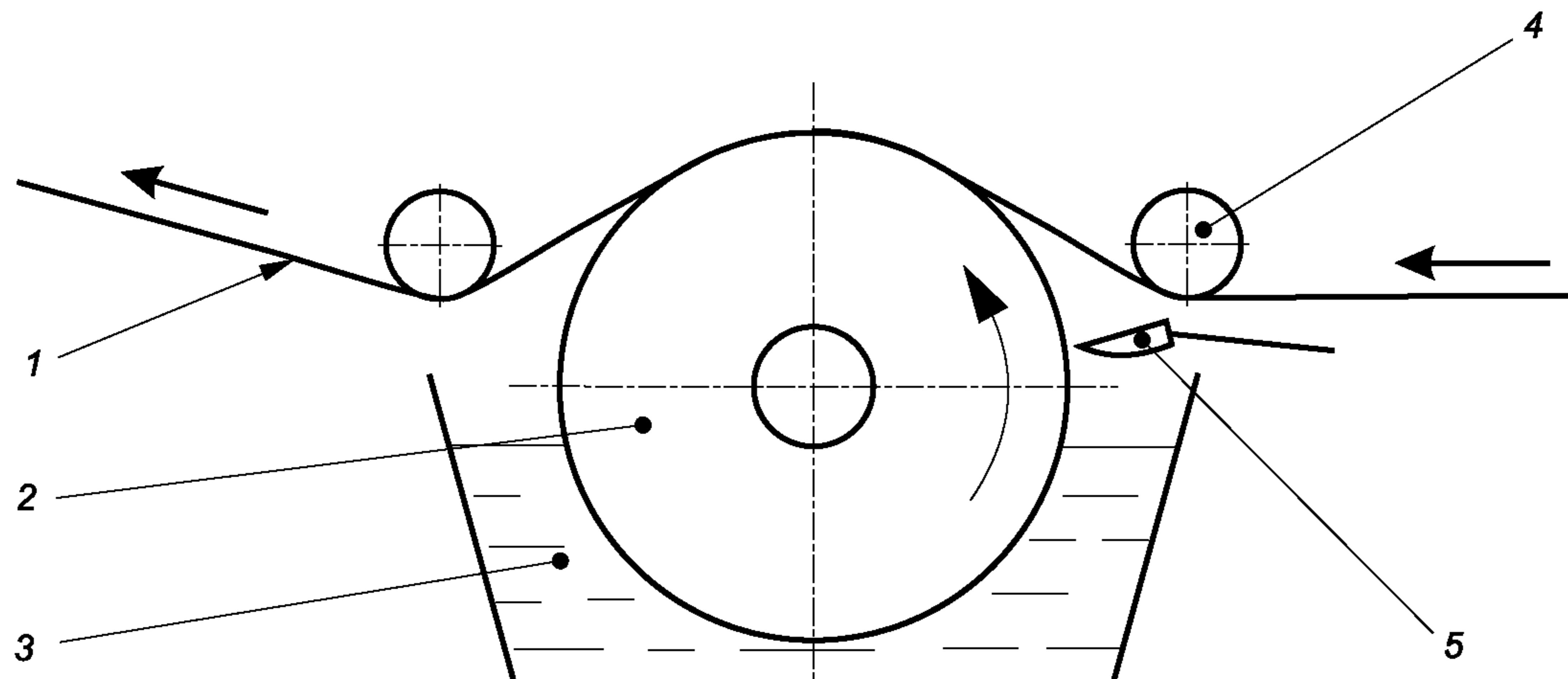
1 – ровинг; 2 – вал; 3 – смола; 4 – направляющий ролик; 5 – ракельный нож
