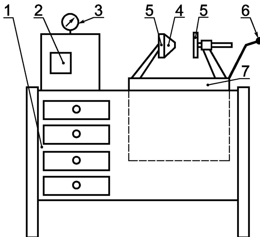
1 — рабочий стол; 2 — пульт управления; 3 — манометр; 4 — уплотнительная прокладка; 5 — клешни (упоры) для зажима испытываемого образца тары; 6 — рукоятка подъема клешней; 7 — испытательная ванна
