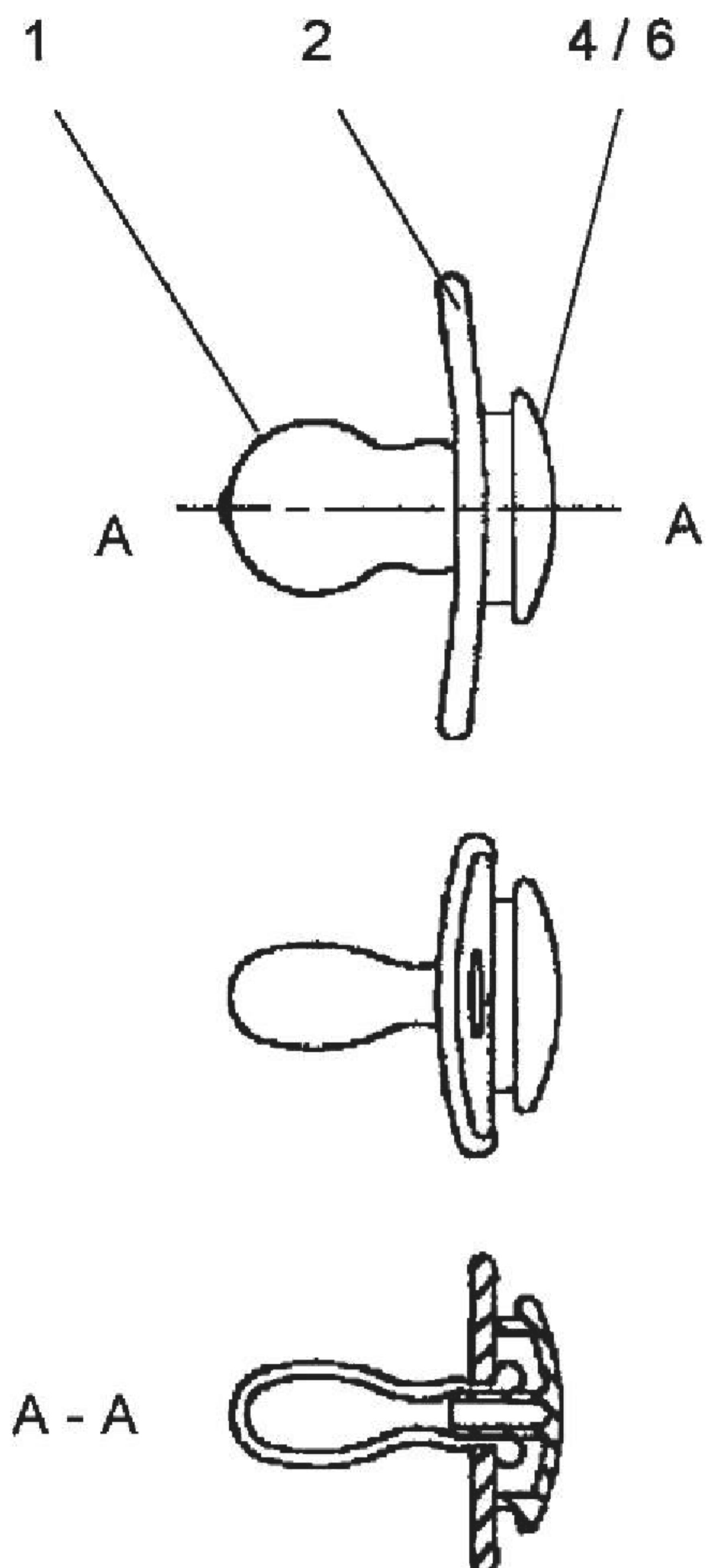
1 – баллончик; 2 – защитный диск; 4 – пробка; 6 – головка
