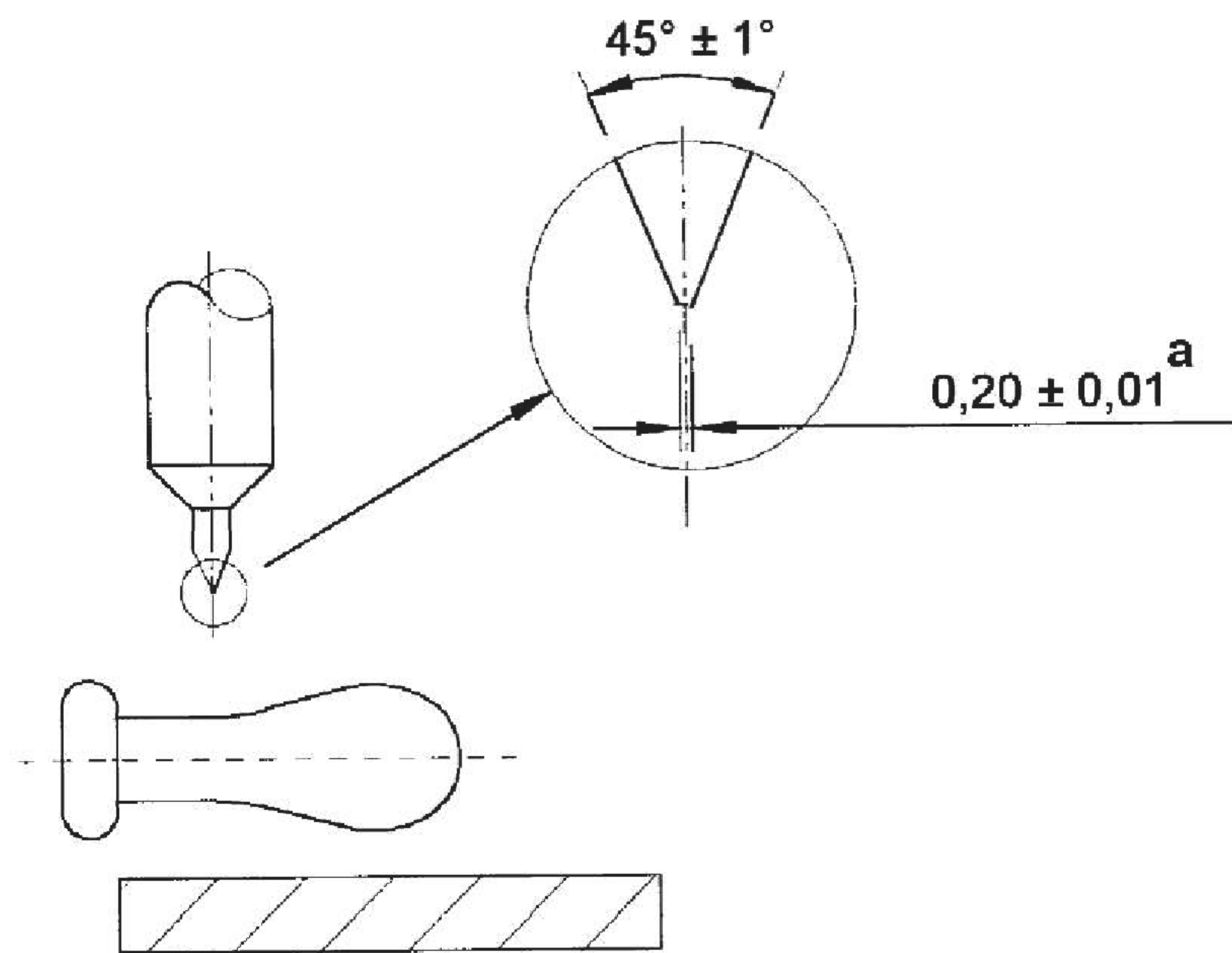
Рисунок 7 – Расположение баллончика соски при определении сопротивления проколу
