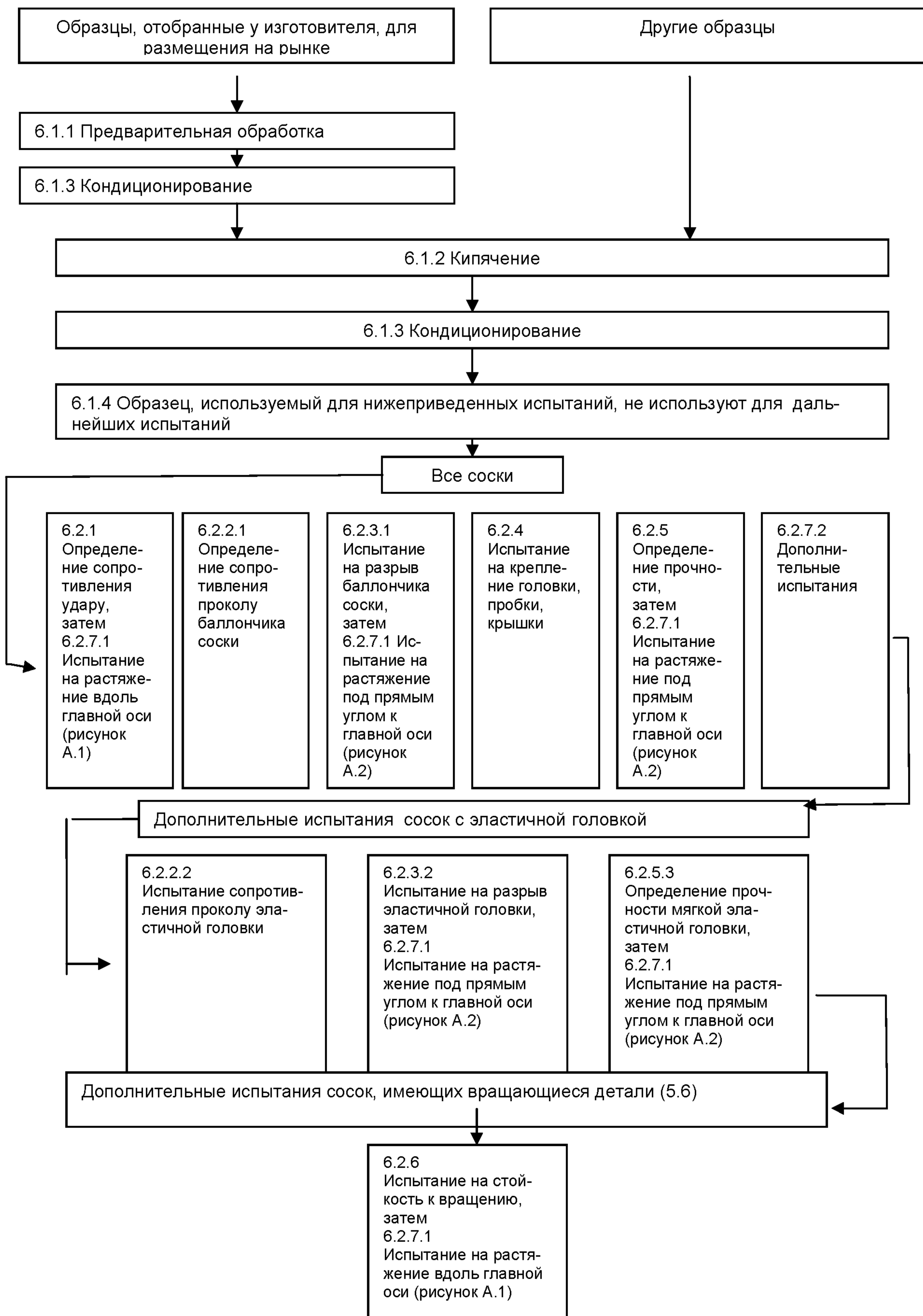
Рисунок 5 – Схема проведения испытания
