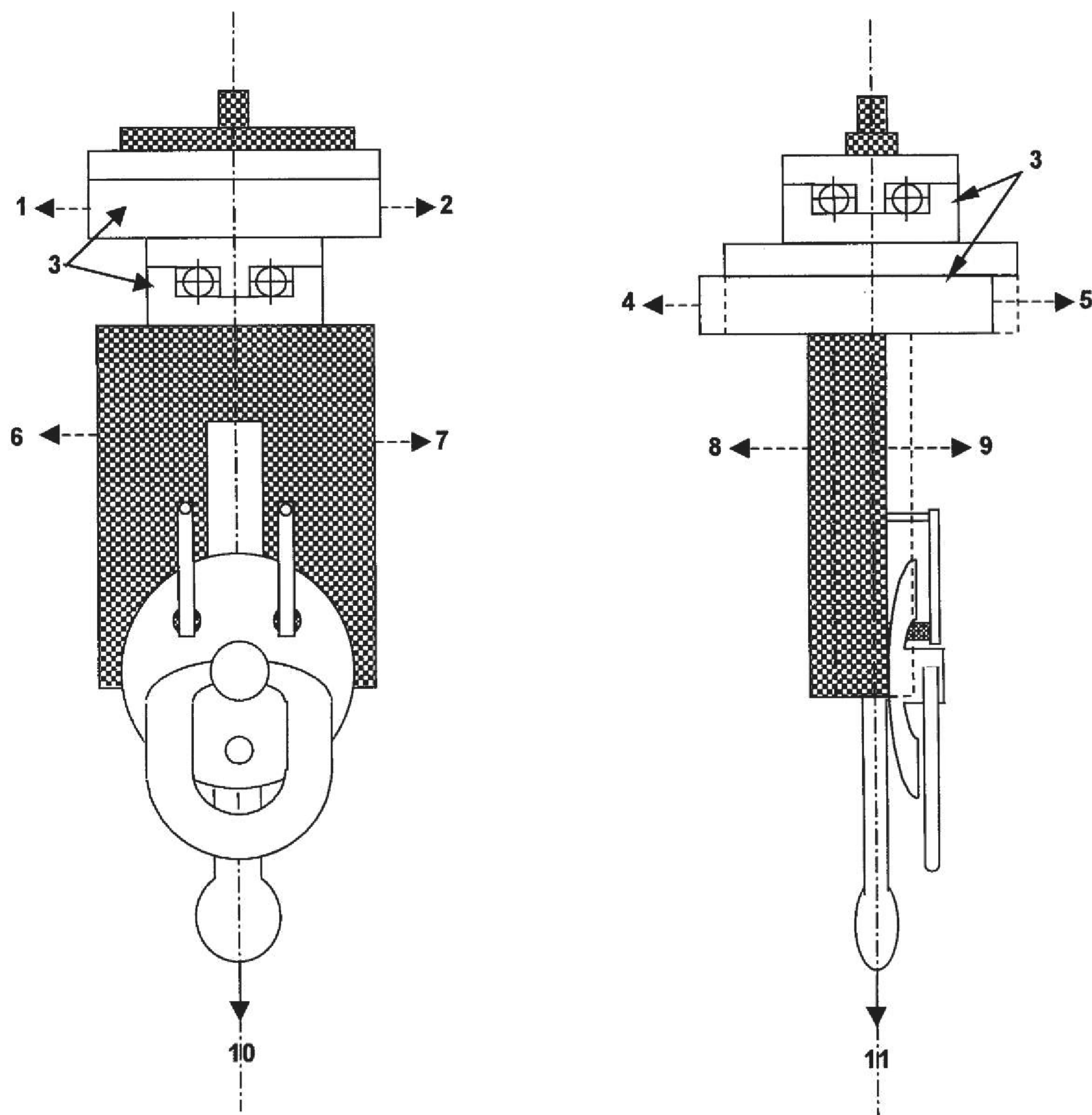
1 –  $Y=$  осевое движение; 2 –  $+Y=$ осевое движение; 3 – подвижная платформа; 4 –  $X=$  осевое движение; 5 –  $+X=$  осевое движение; 6 –  $Y=$  осевое движение зажима; 7 –  $+Y=$ осевое движение зажима; 8 –  $X=$ осевое движение зажима; 9 –  $+X=$  осевое движение зажима; 10 – растягивающее усилие (вид спереди); 11 – растягивающее усилие (вид сбоку)
