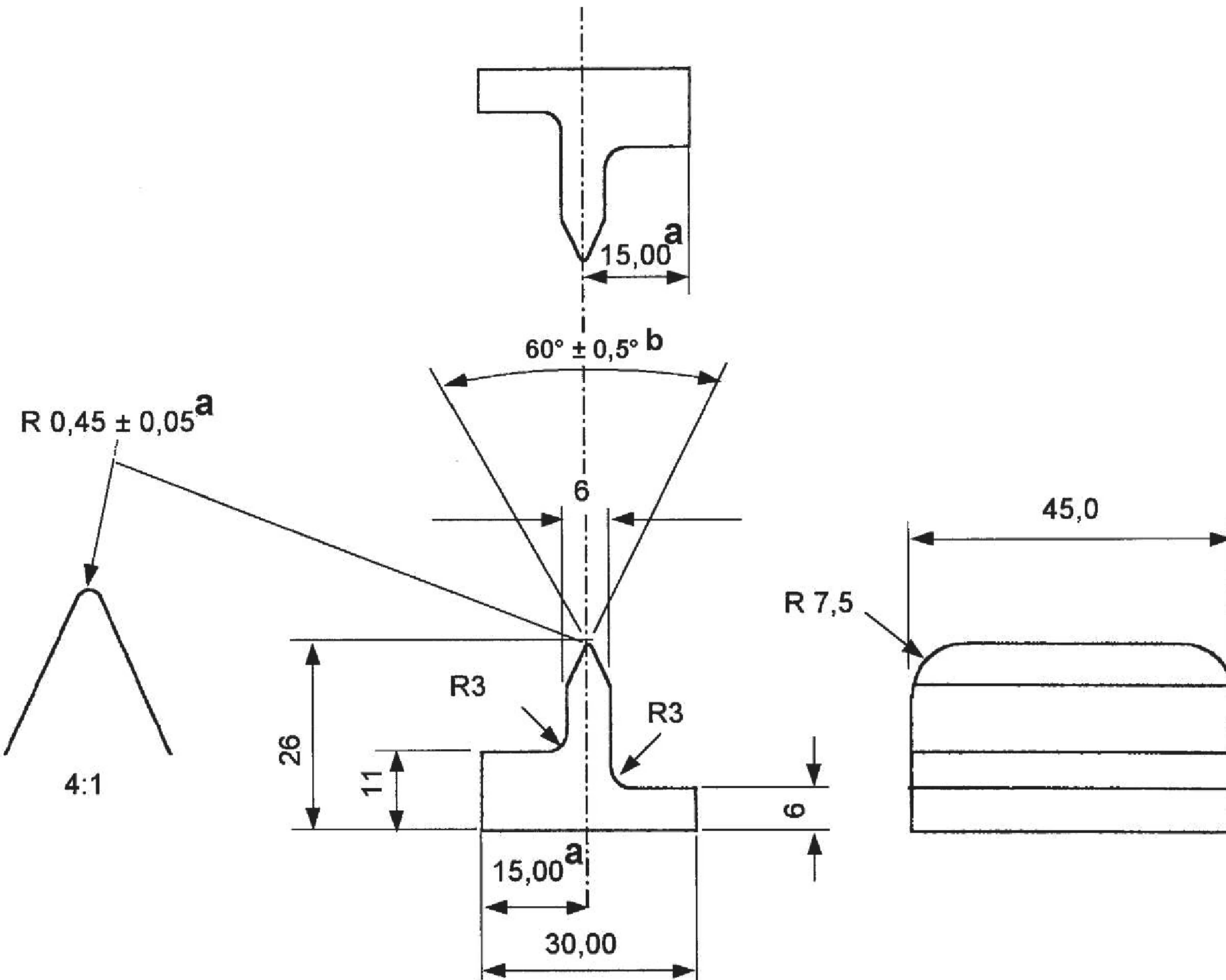
Рисунок 11 – Верхний и нижний зажимы для определения прочности
