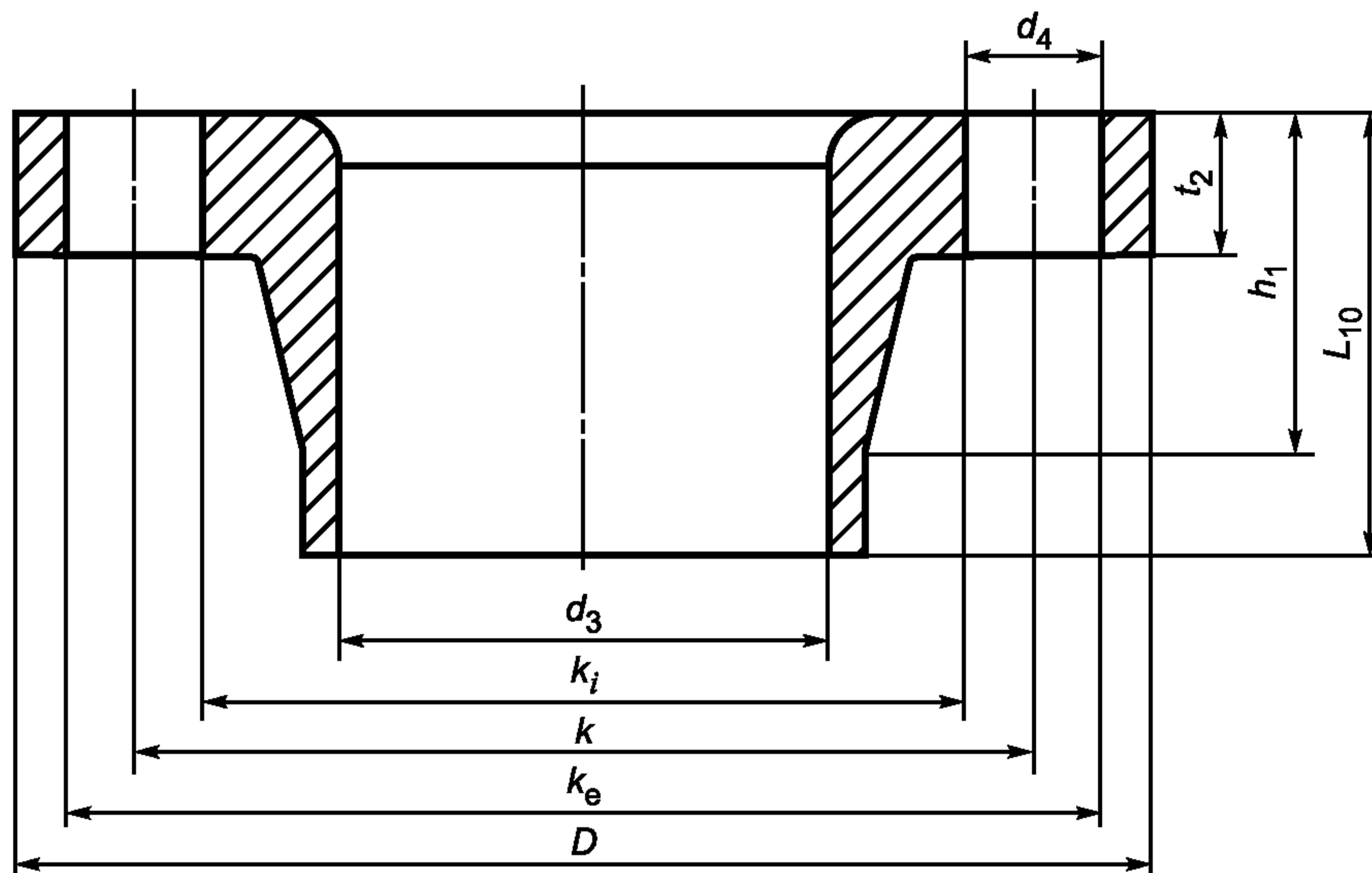
Рисунок 6 — Размеры фланцевой втулки
