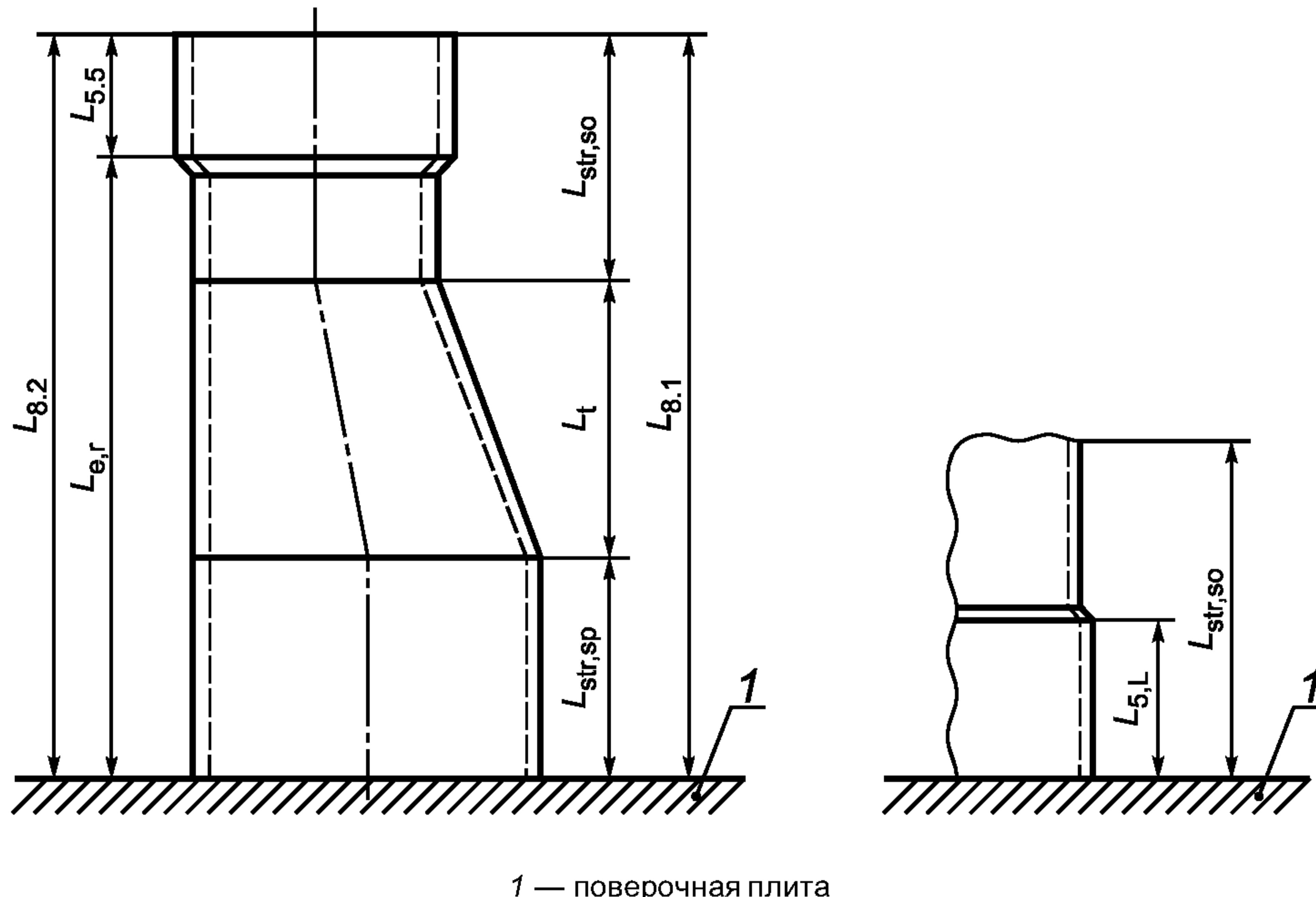
Рисунок 5 — Определение эффективной длины перехода
