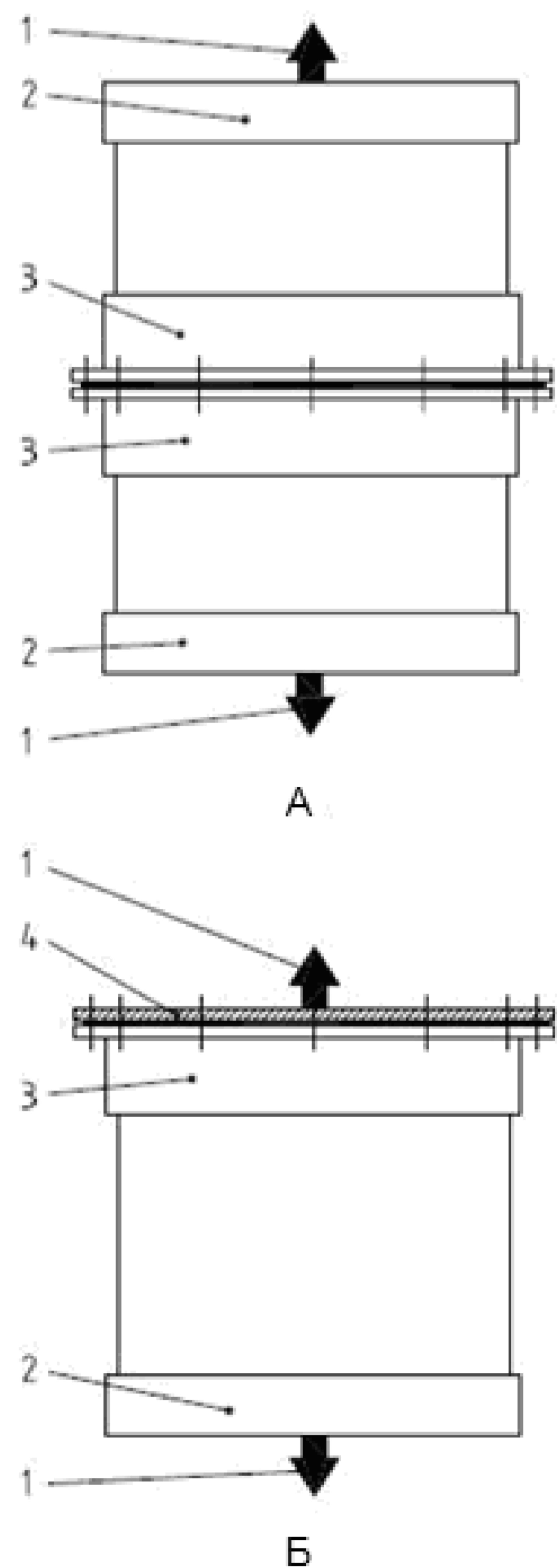
1 – осевая нагрузка, действующее на образец; 2 – жесткие заглушки; 3 – фиксированные стеклопокомпозитные фланцы; 4 – металлическая фланцевая заглушка; А – испытуемое соединение, находящееся в середине образца; Б – испытуемое соединение, находящее на конце образца
