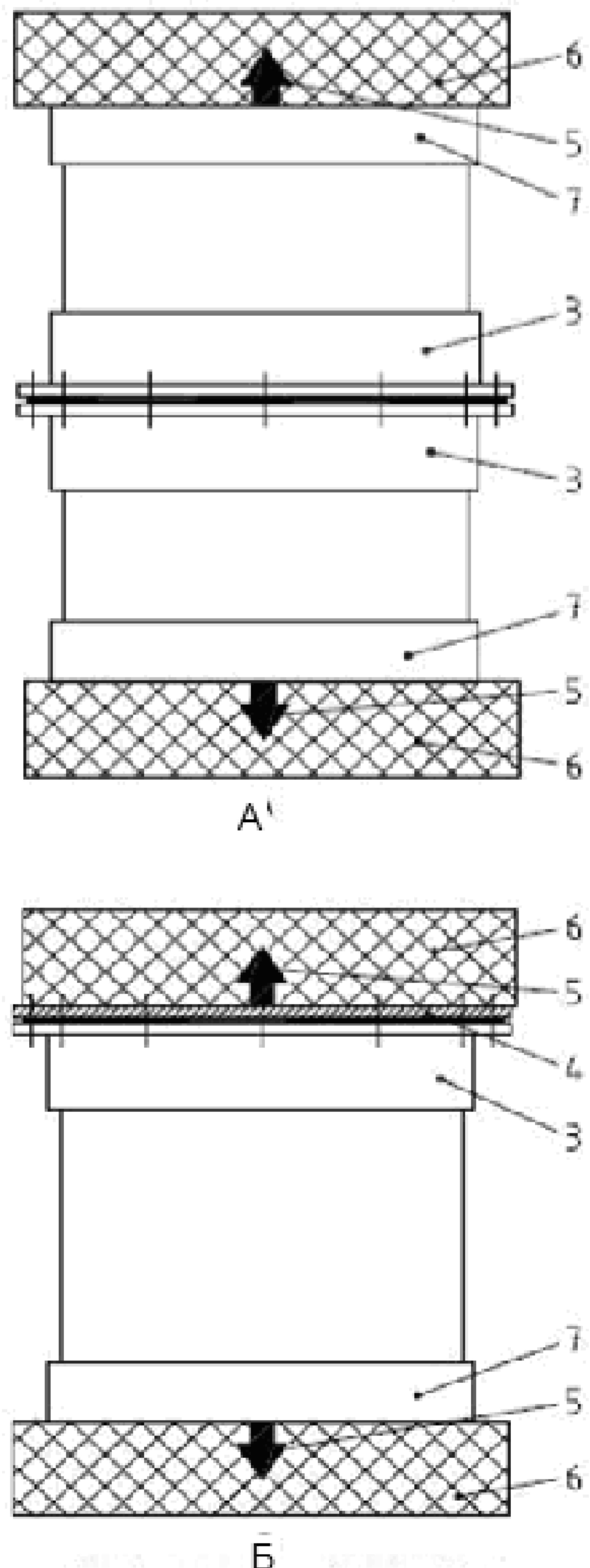
5 – нагрузка, действующая на концевые упоры испытательного комплекта; 6 – концевые упоры; 7 – подвижные заглушки
