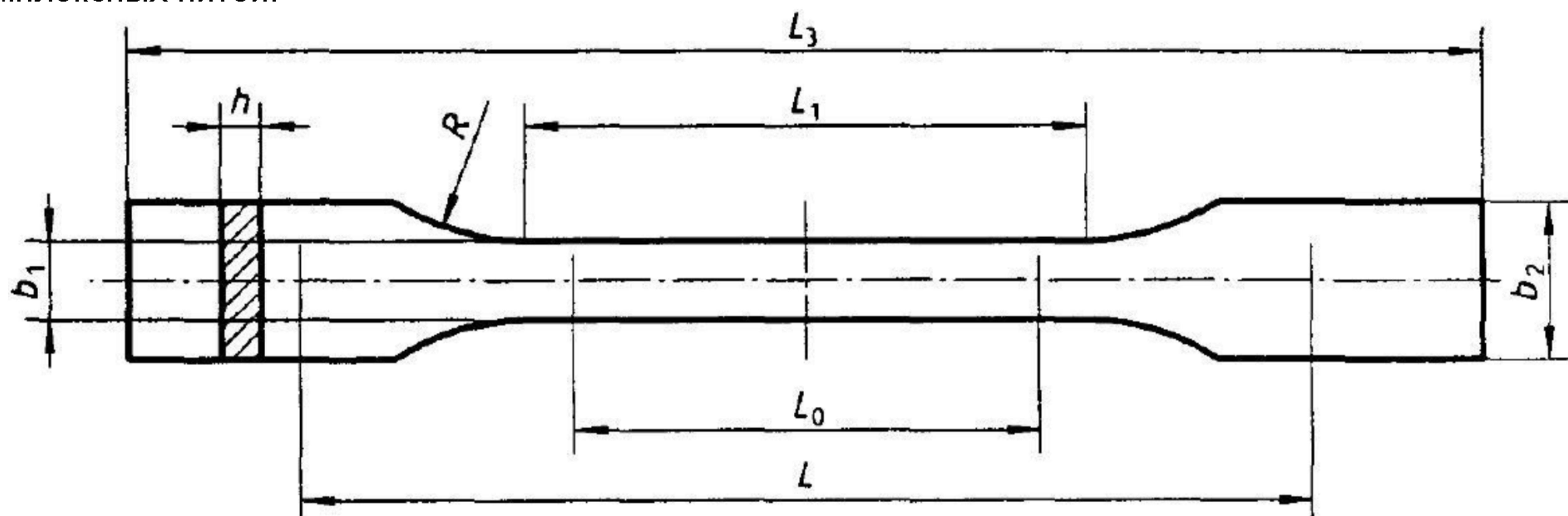
$L$  – исходное расстояние между захватами;  $L_0$  – измерительная база;  $L_3$  – общая длина;  $L_1$  – длина узкой параллельной части;  $R$  – радиус;  $b_2$  – ширина на концах;  $b_1$  – ширина узкой части;  $h$  – толщина
