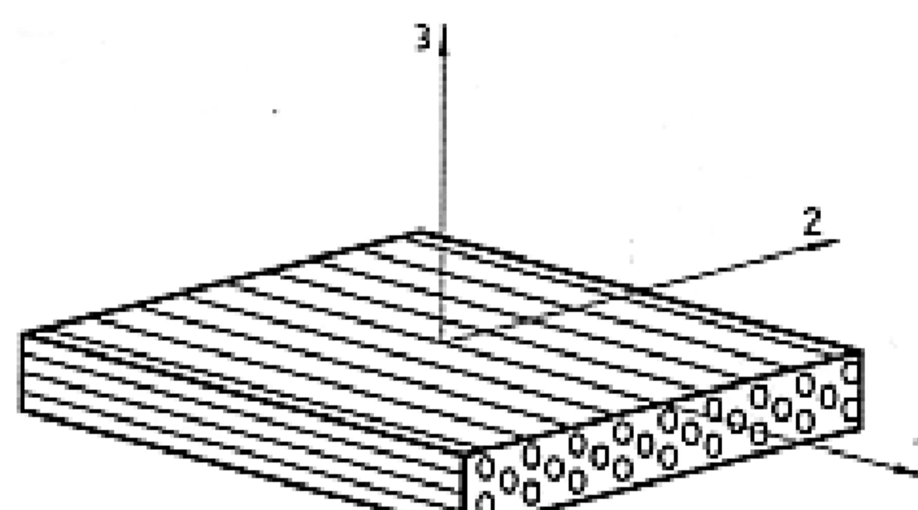
Рисунок 2 – Оси симметрии пластического композиционного материала, армированного волокнами
