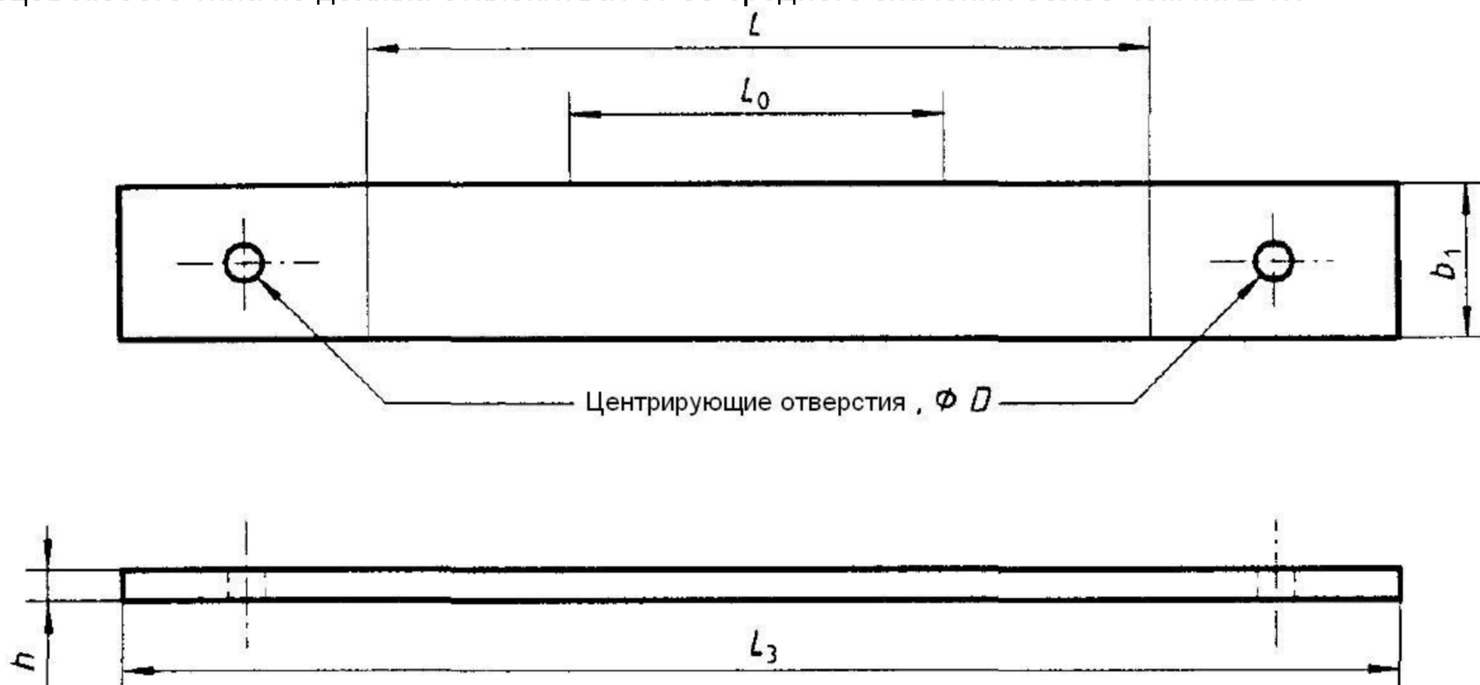
$L$  – исходное расстояние между захватами;  $L_0$  – измерительная база;  $L_3$  – общая длина;  $h$  – толщина;  $b_1$  – ширина;  $D$  – диаметр центрирующих отверстий для штифтов
