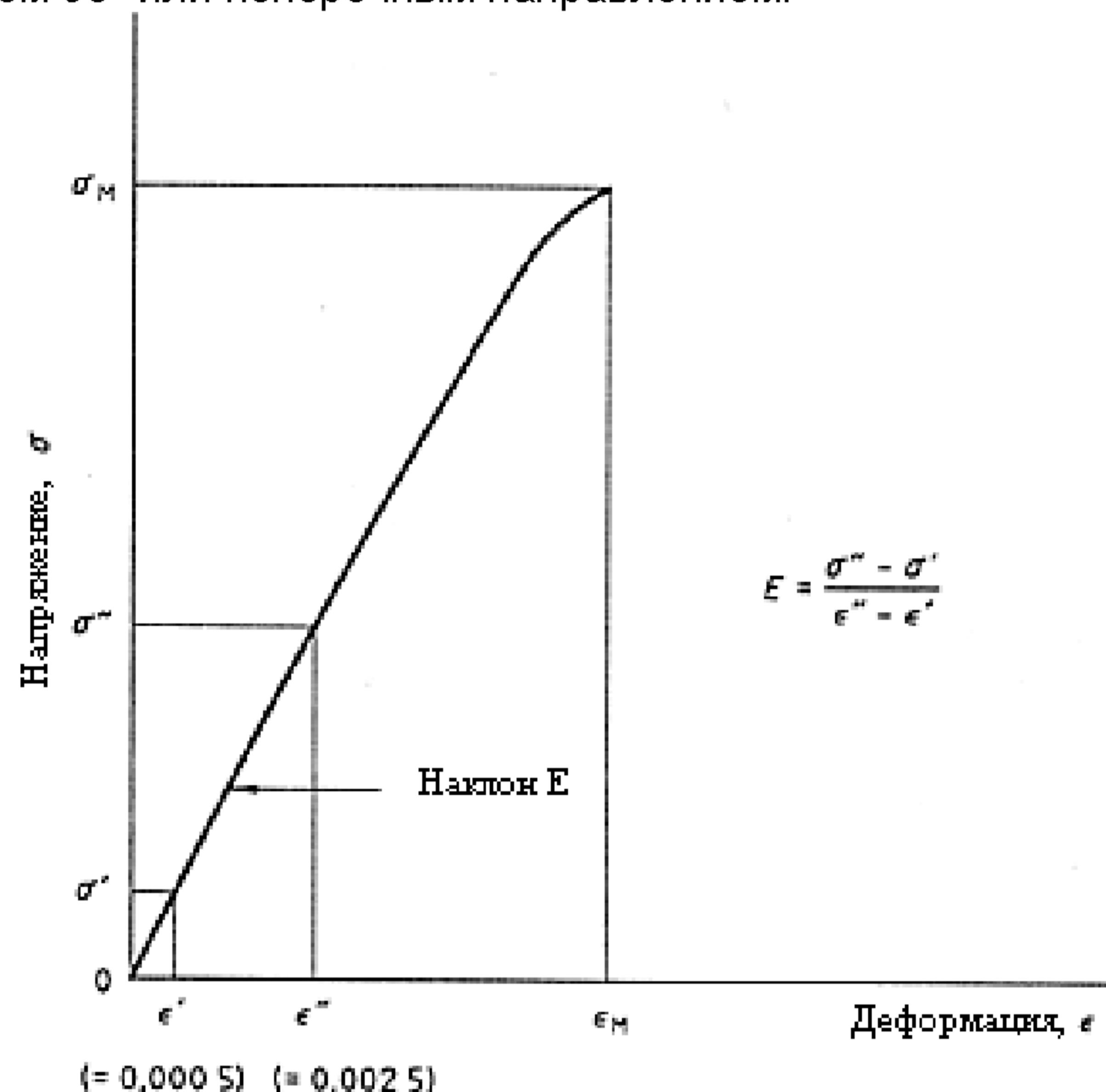
Рисунок 1 – Кривая напряжение – деформация
