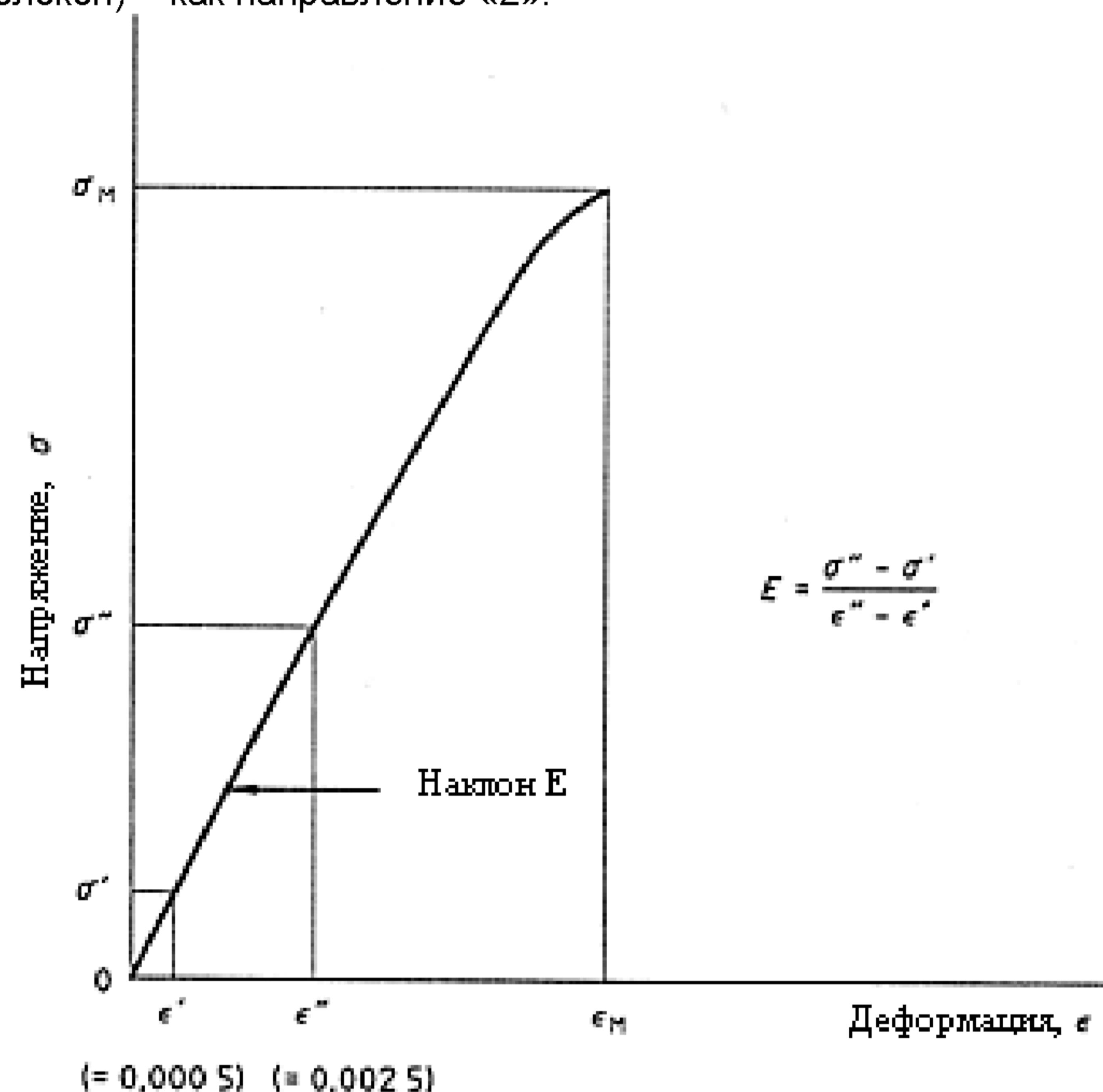
Рисунок 1 – Кривая напряжение – деформация
