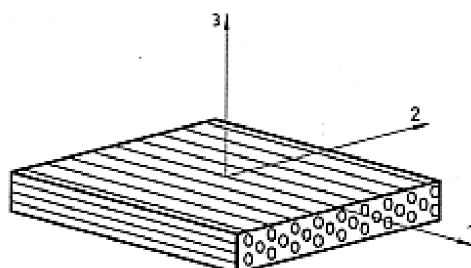
Рисунок 2 – Оси симметрии пластического композиционного материала, армированного волокнами
