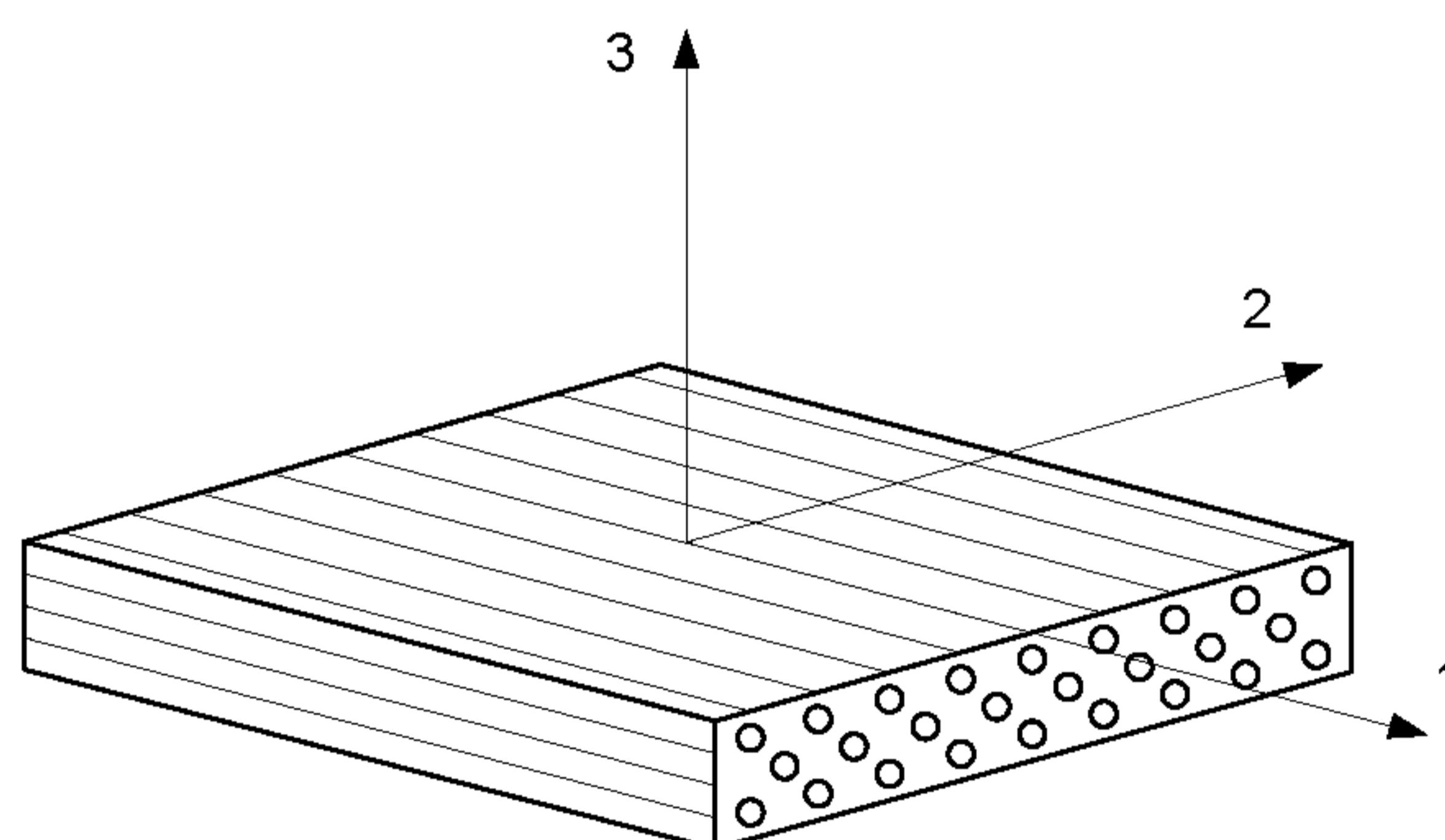
Рисунок 1 – Оси симметрии полимерного композита, армированного волокнами
