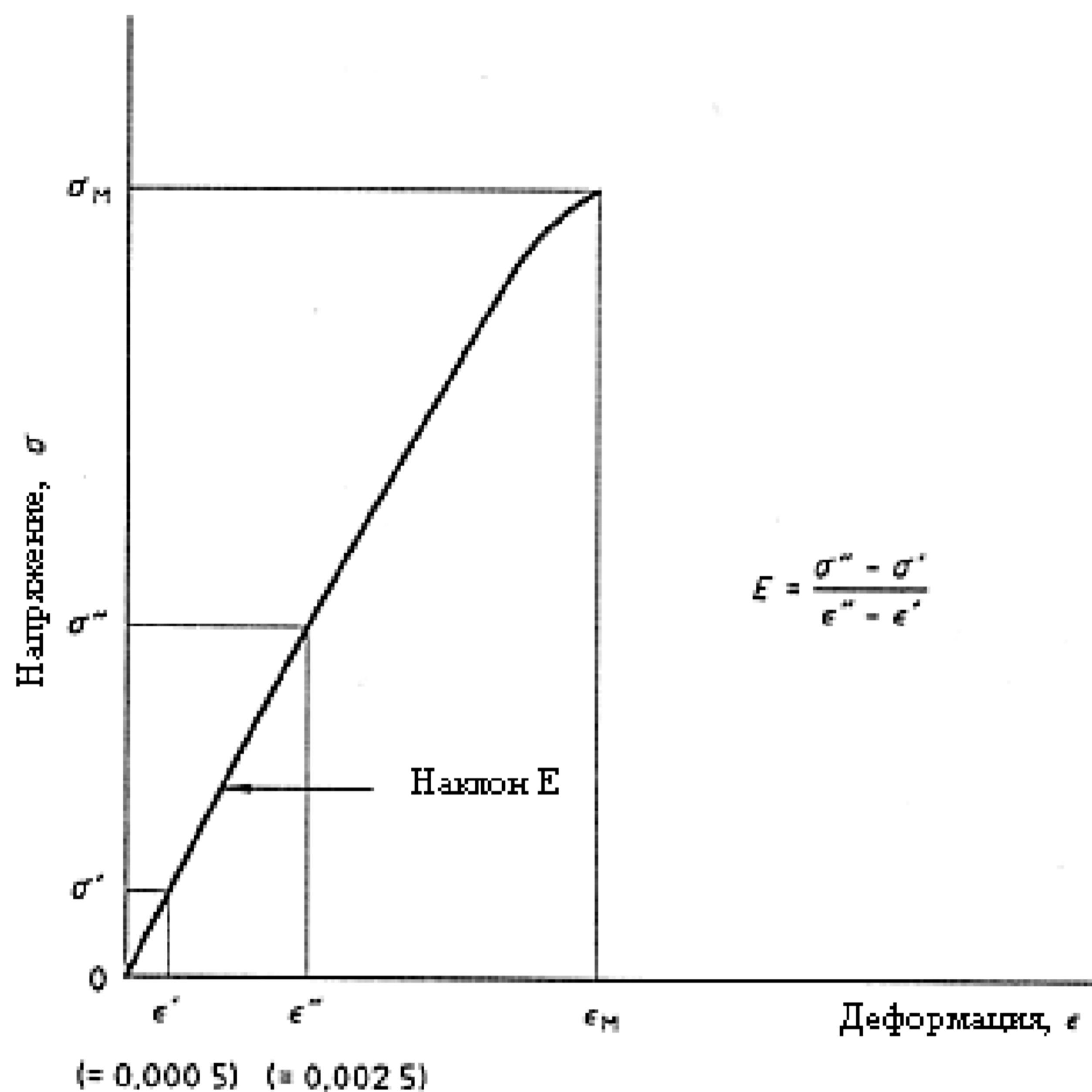
Рисунок 2 – Диаграмма напряжение-деформация
