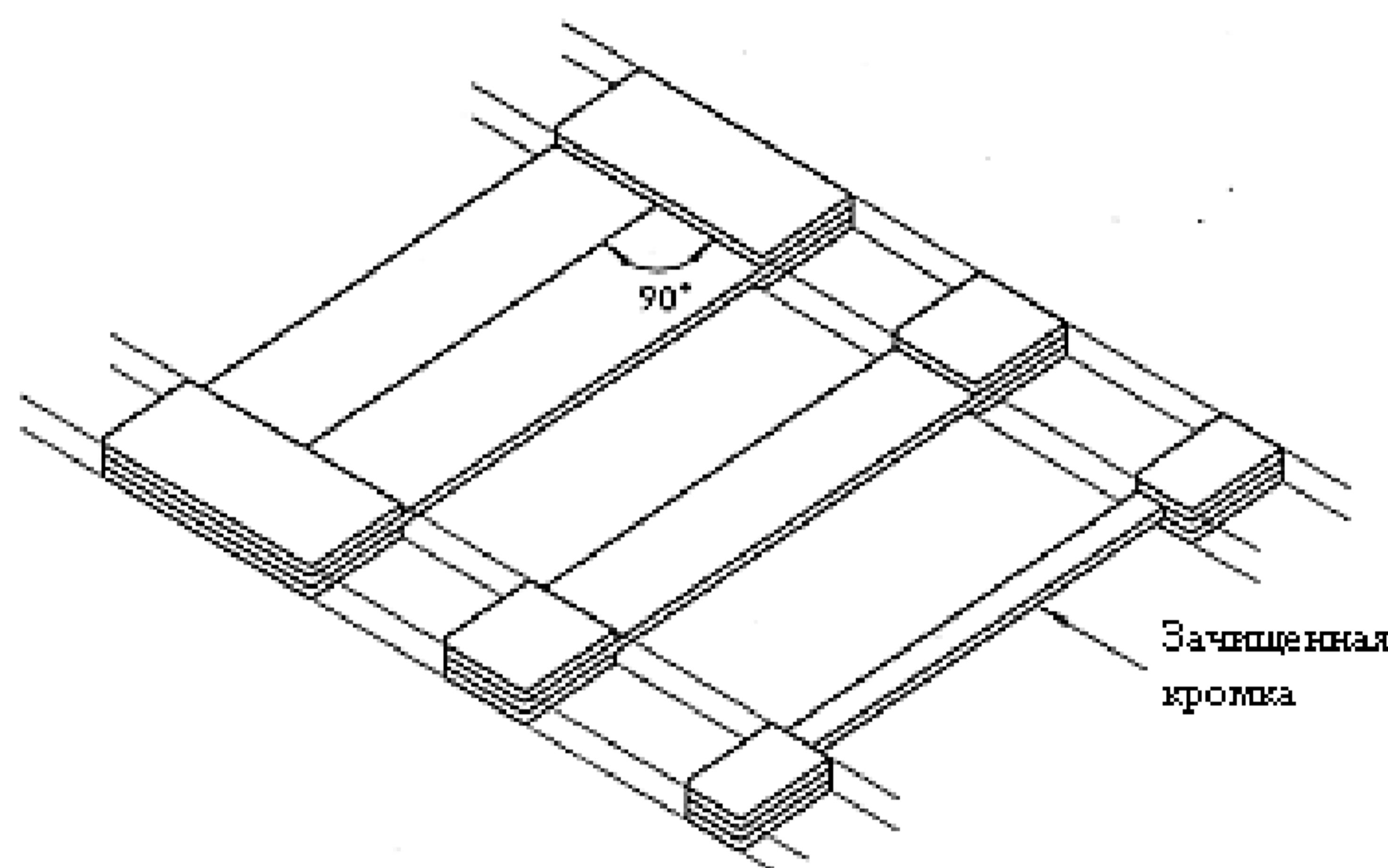
Рисунок А.1 – Панель с выступами для подготовки образцов
