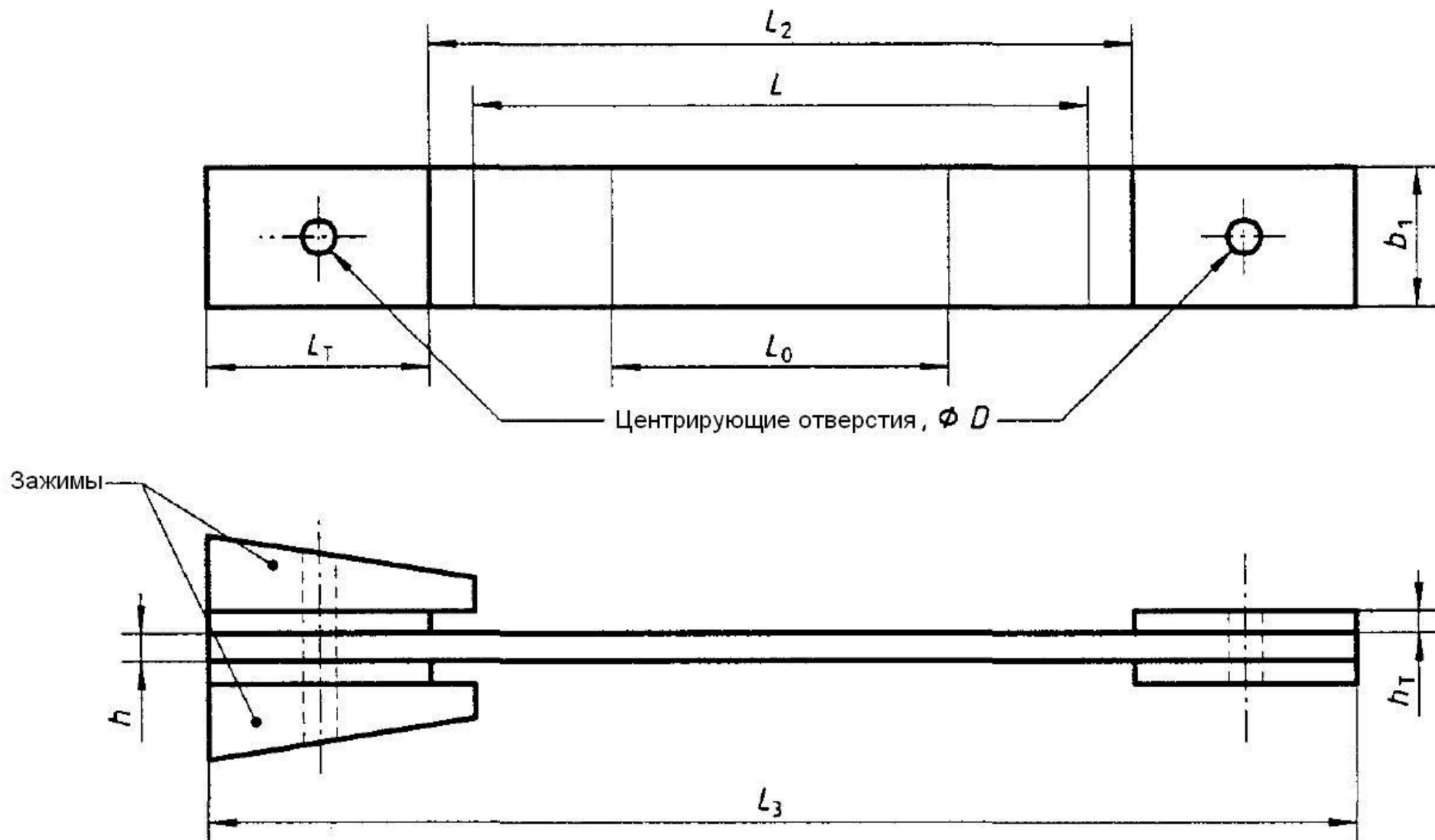
$L$  – исходное расстояние между захватами;  $L_0$  – измерительная база;  $L_2$  – расстояние между накладками;  $L_3$  – общая длина;  $L_T$  – длина накладок;  $b_1$  – ширина;  $h_T$  – толщина накладки;  $D$  – диаметр центрирующих отверстий для штифтов
