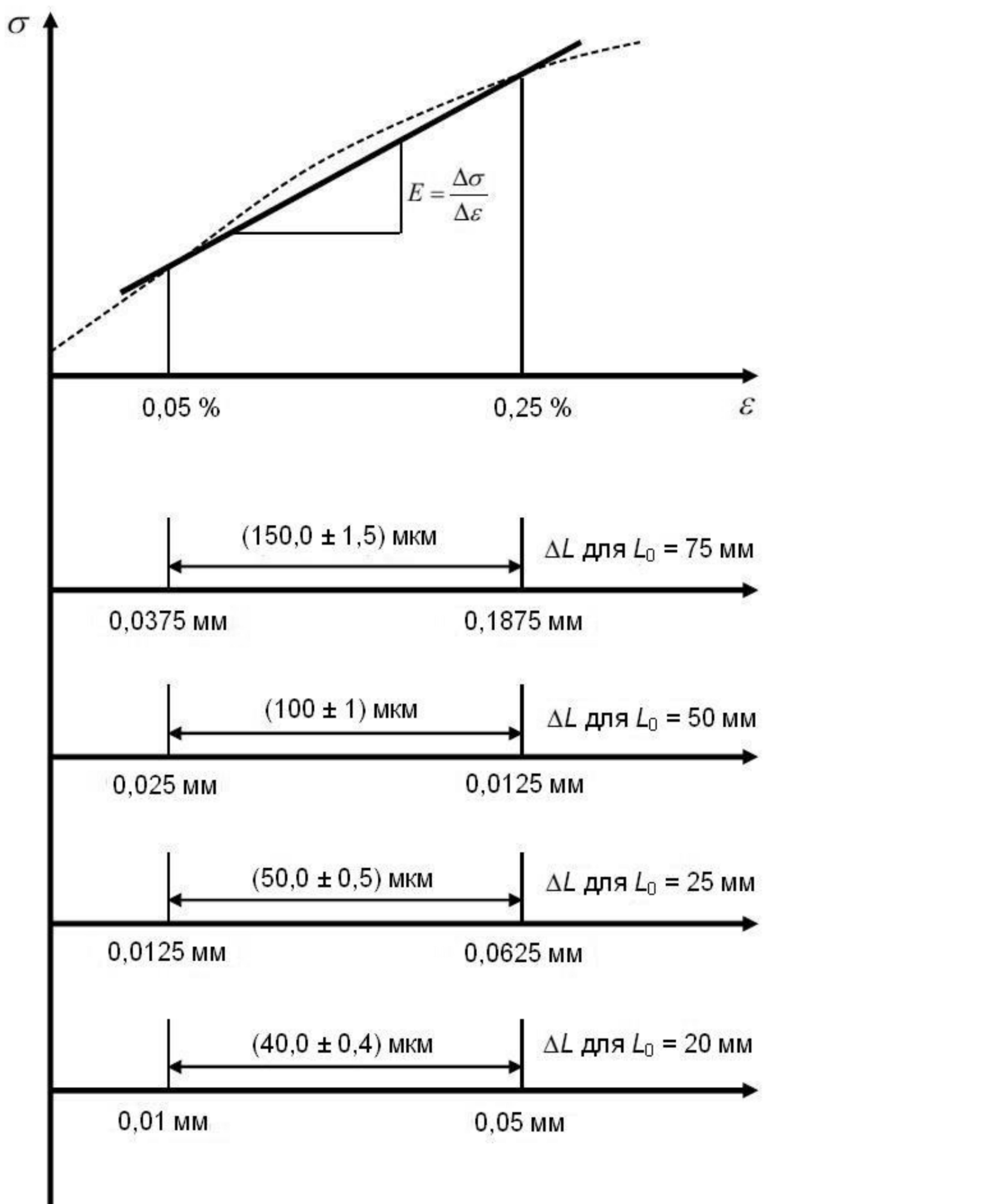
Рисунок 3 – Требования к точности экстензометров при измерении модуля упругости в зависимости от измерительной базы
