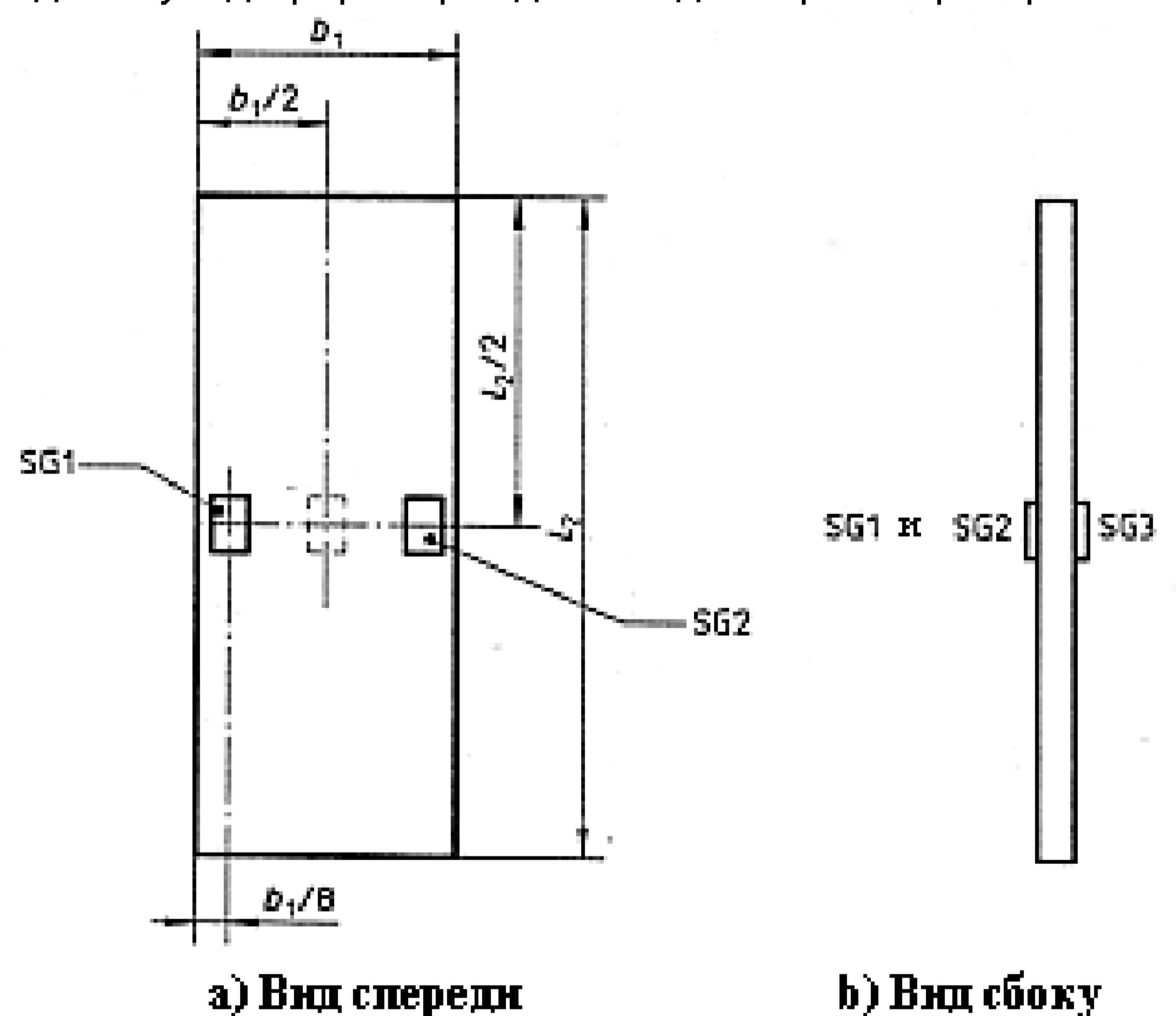
Рисунок Б.1 –Размещение тензодатчиков (SG1, SG2 и SG3) для проверки центрирования системы
