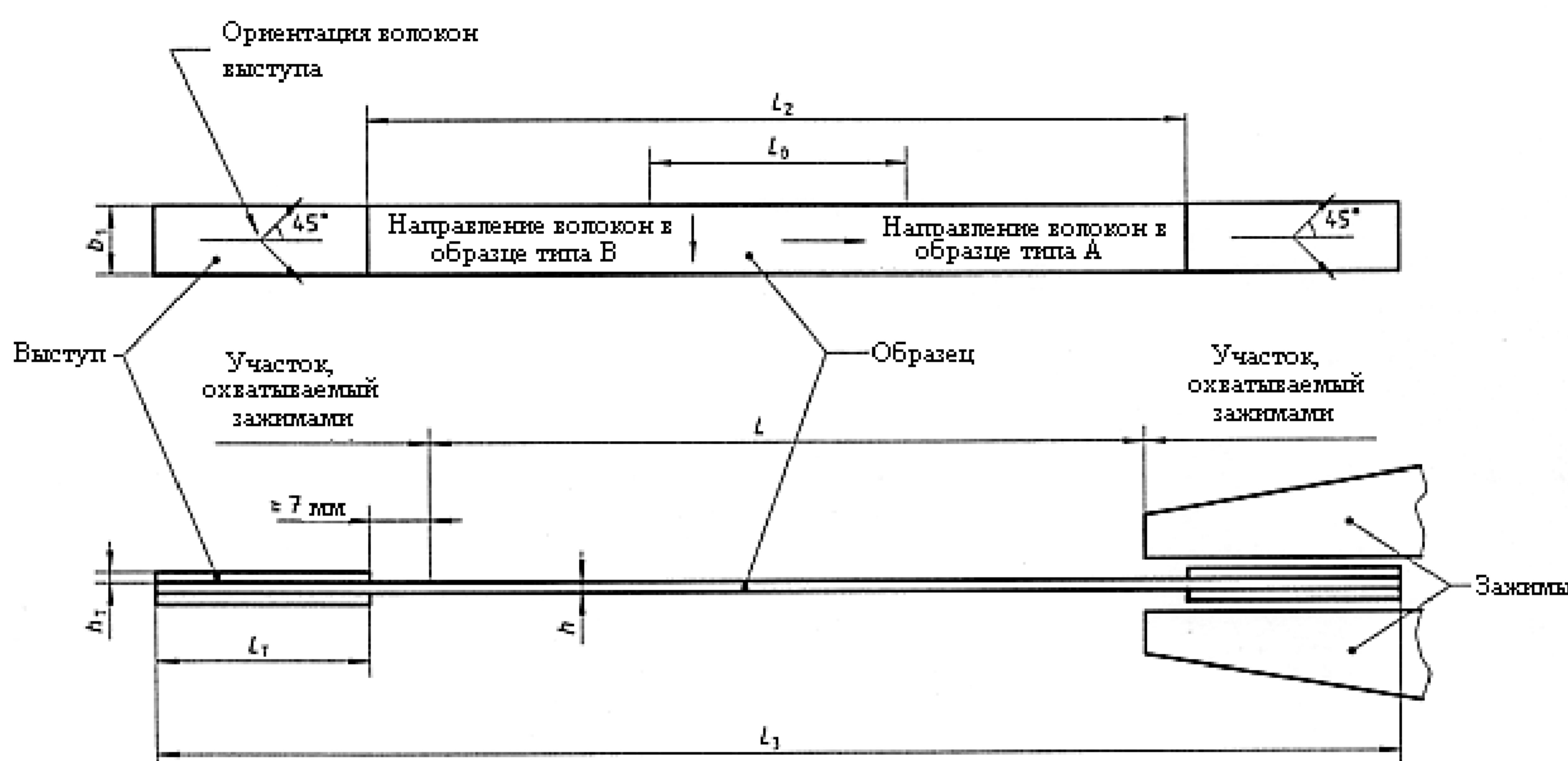
Рисунок 7 – Образцы типов А и В
