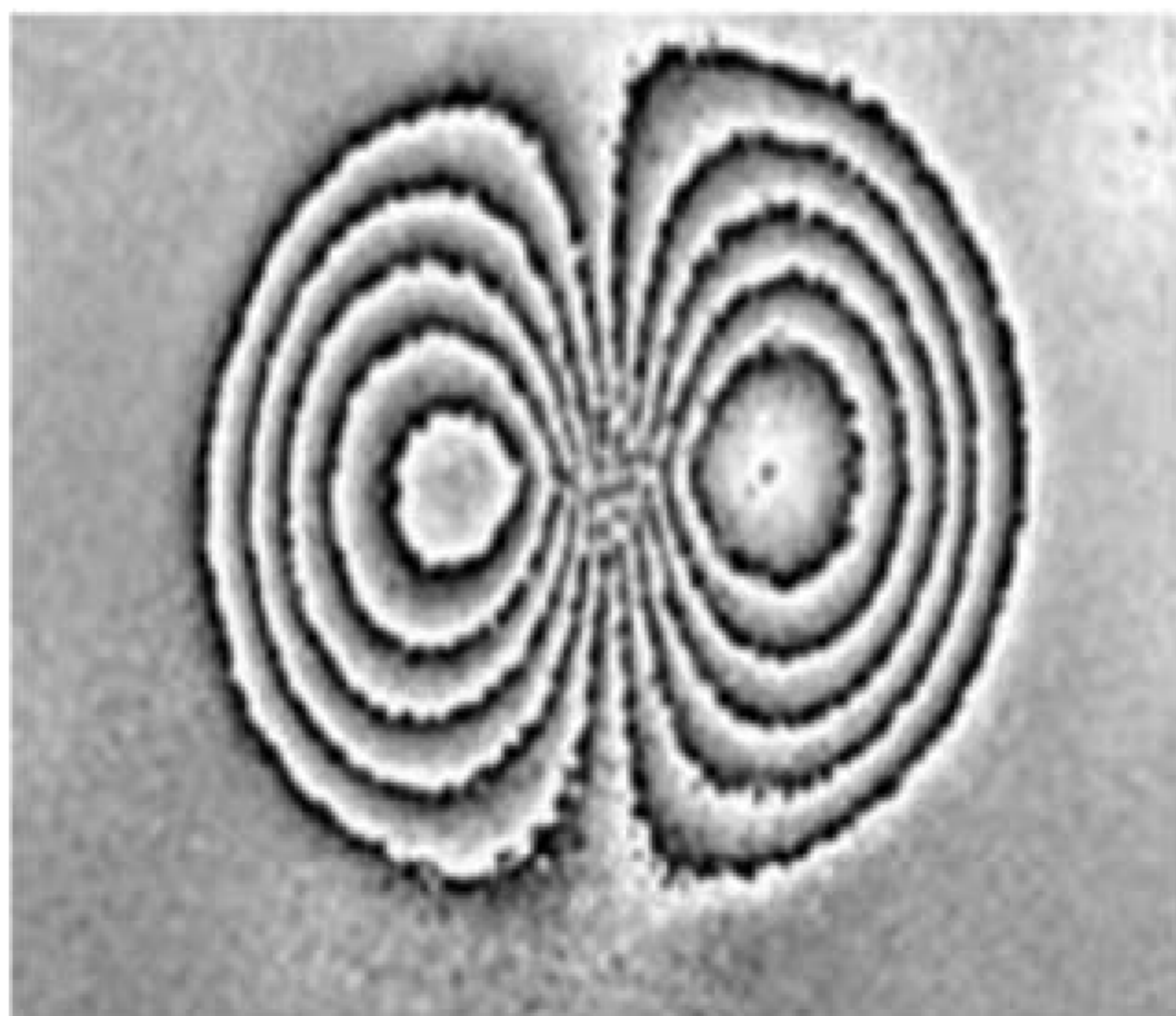
Рисунок 3 — Шерограмма с областью локального перемещения
