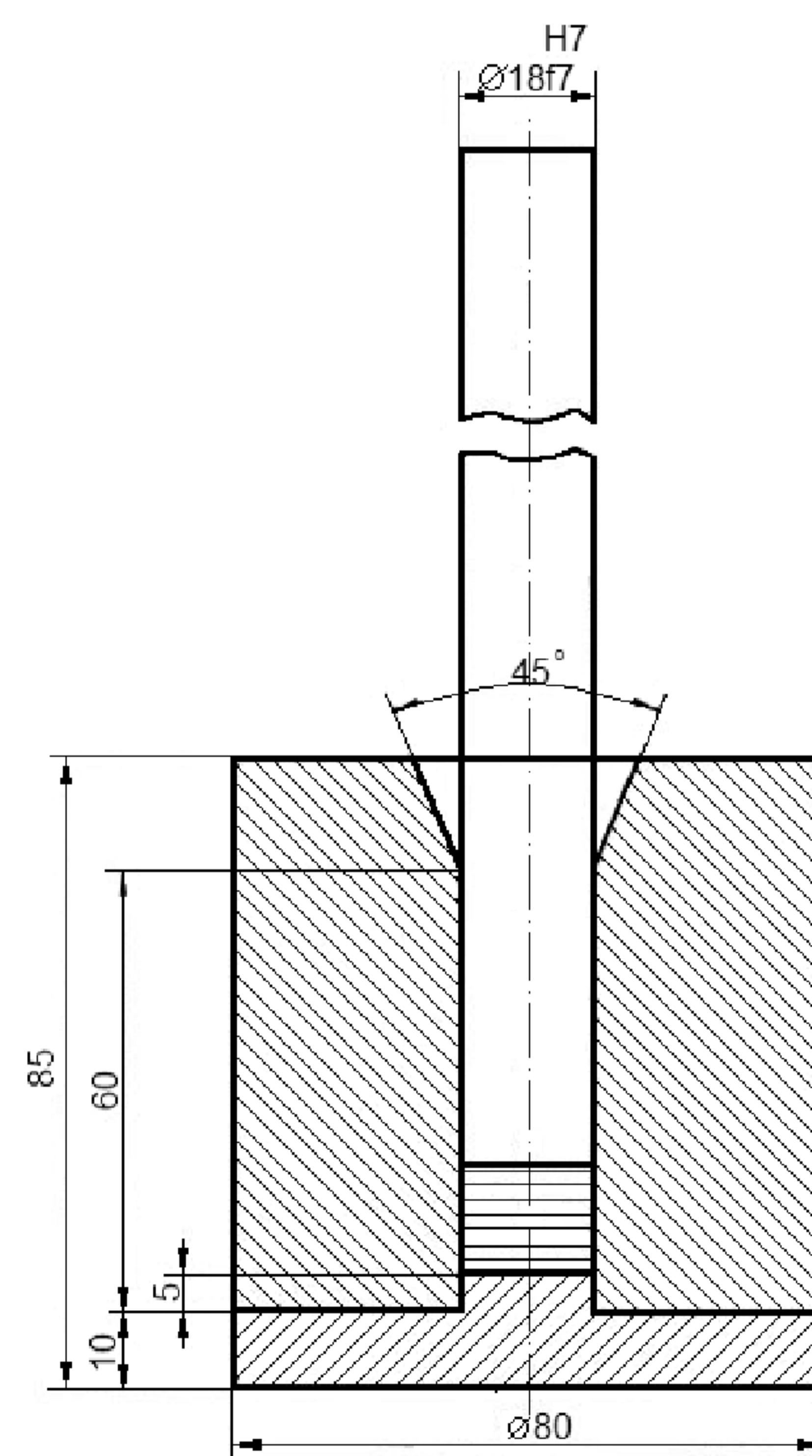
Рисунок 3 – Устройство подготовки образцов для испытания из премиксов
