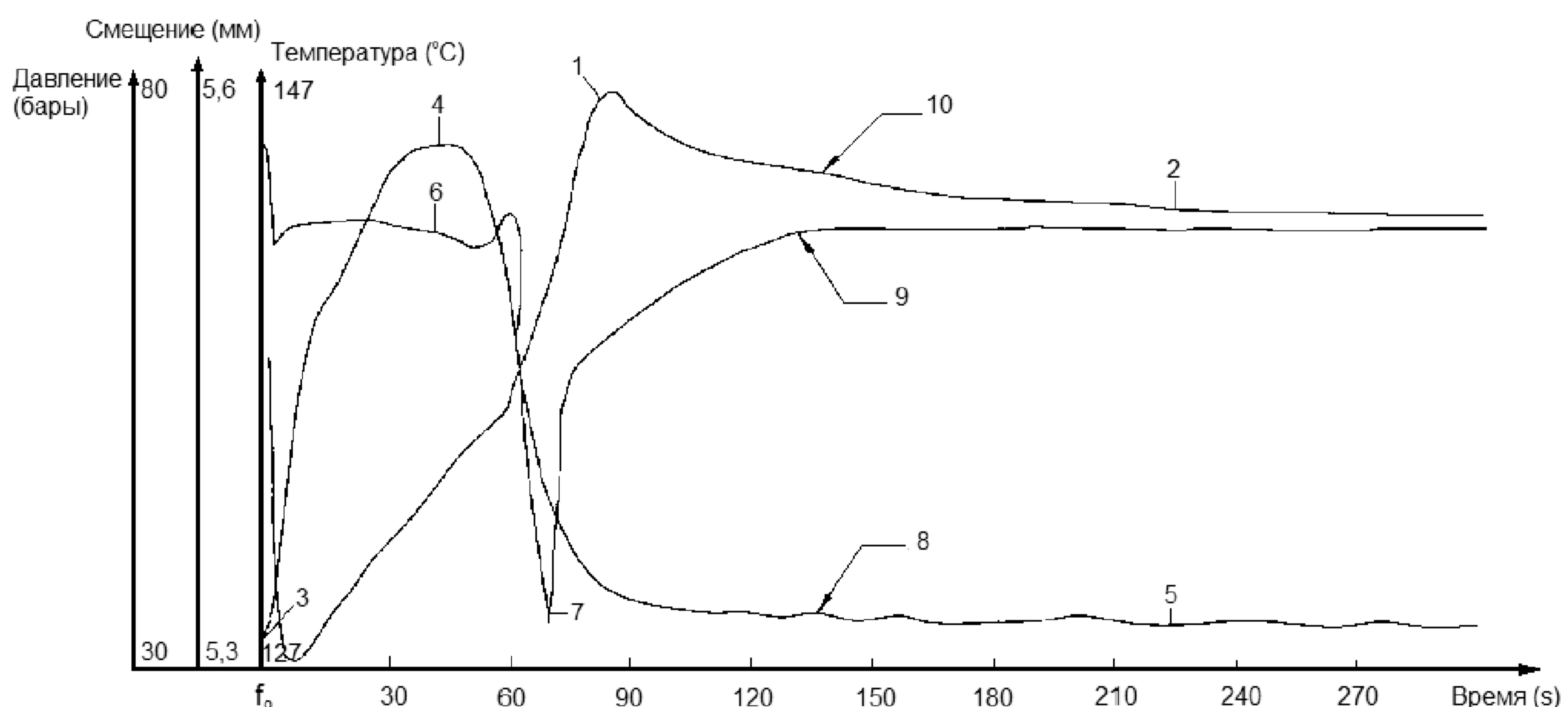
1 - максимальная температура; 2 - температура формования; 3 - начало теплового расширения; 4 - максимальное расширение; 5 - окончание усадки; 6 - давление формования; 7 - время отверждения в зависимости от давления; 8 – кривая «смещение от времени»; 9 – кривая «давление от времени»; 10 – кривая «температура от времени».
