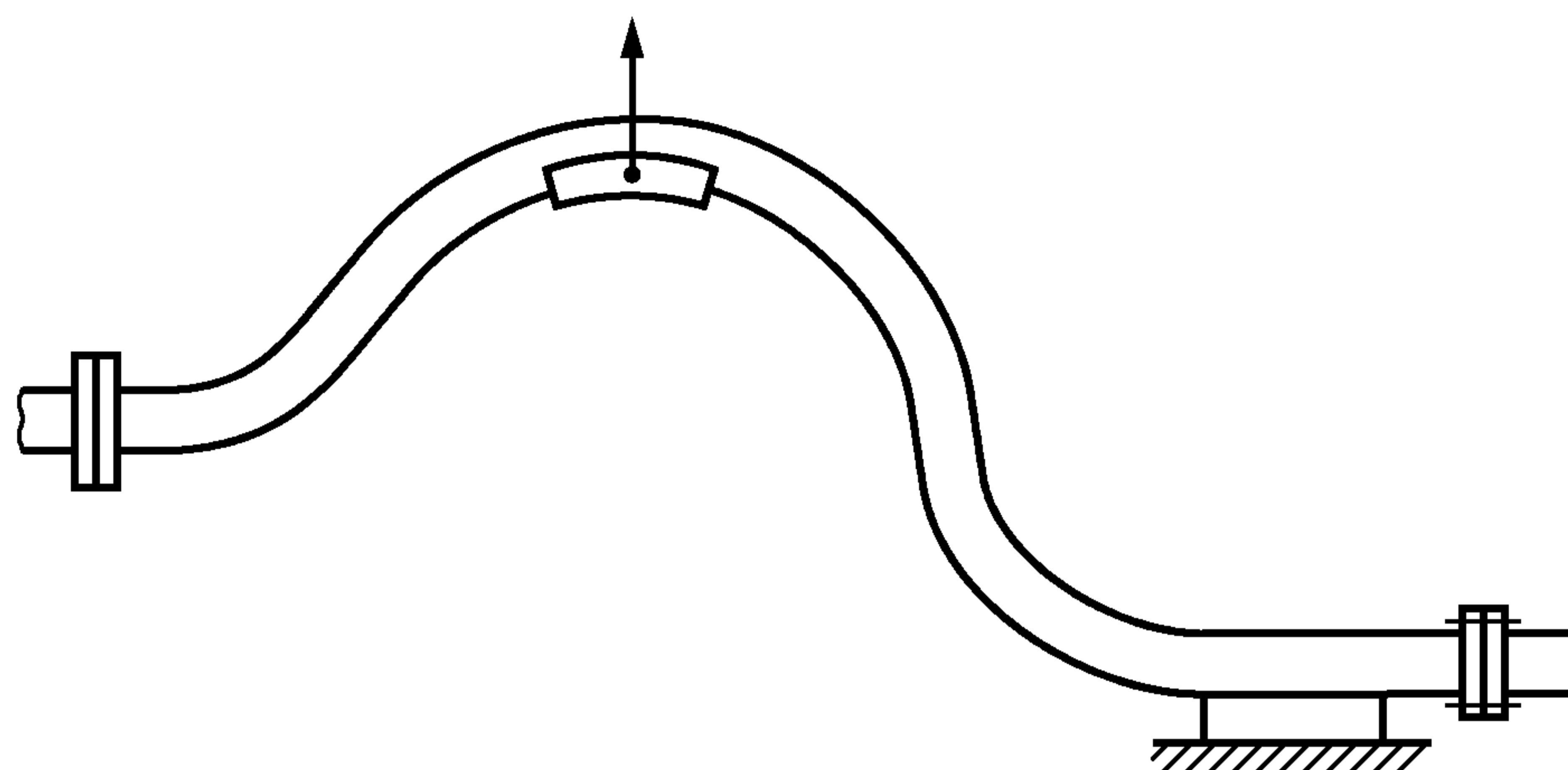
Рисунок 1 — Опоры для рукава при временной установке
