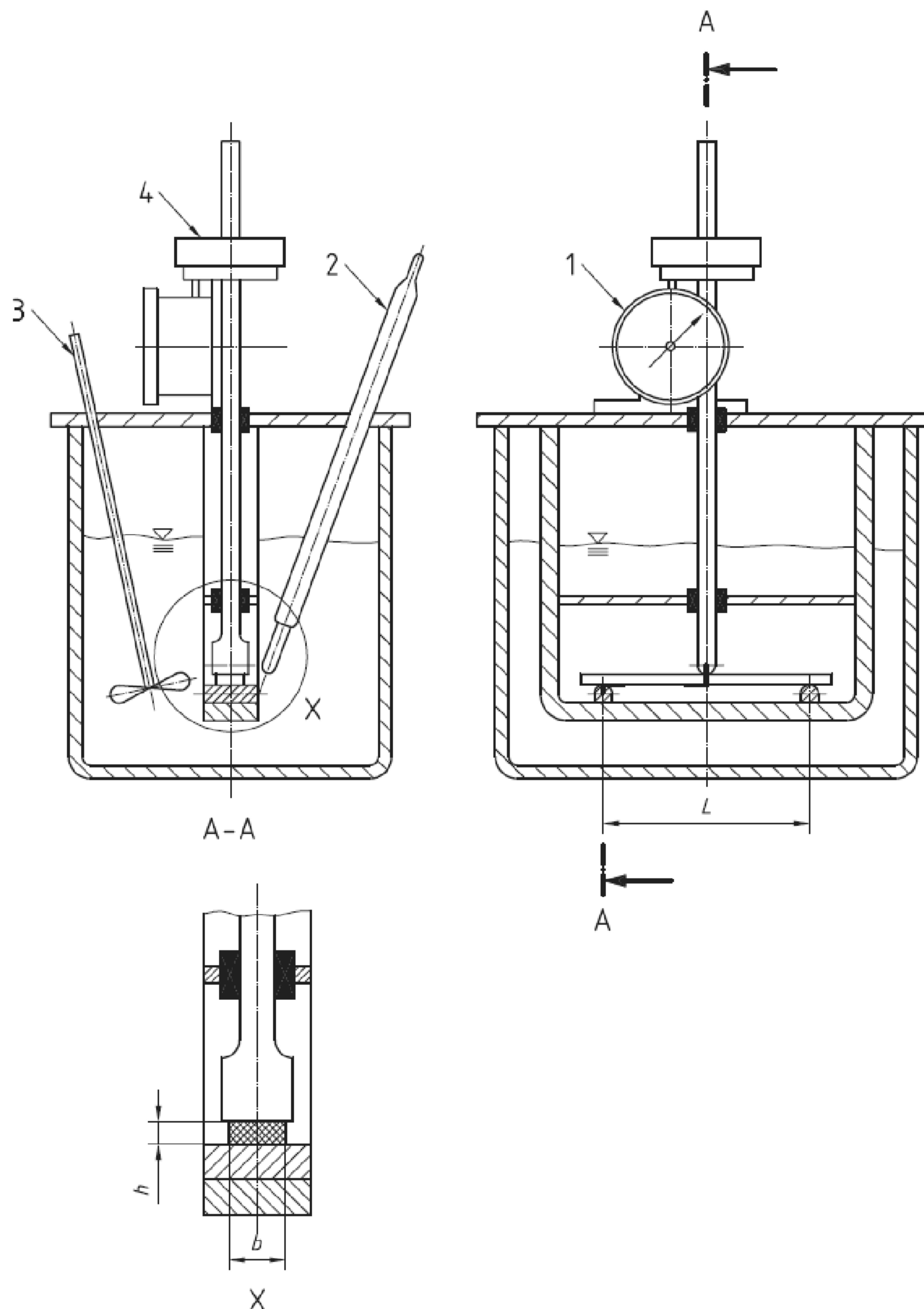
1 – прибор с круговой шкалой; 2 – термометр; 3 – мешалка; 4 – нагрузка;
