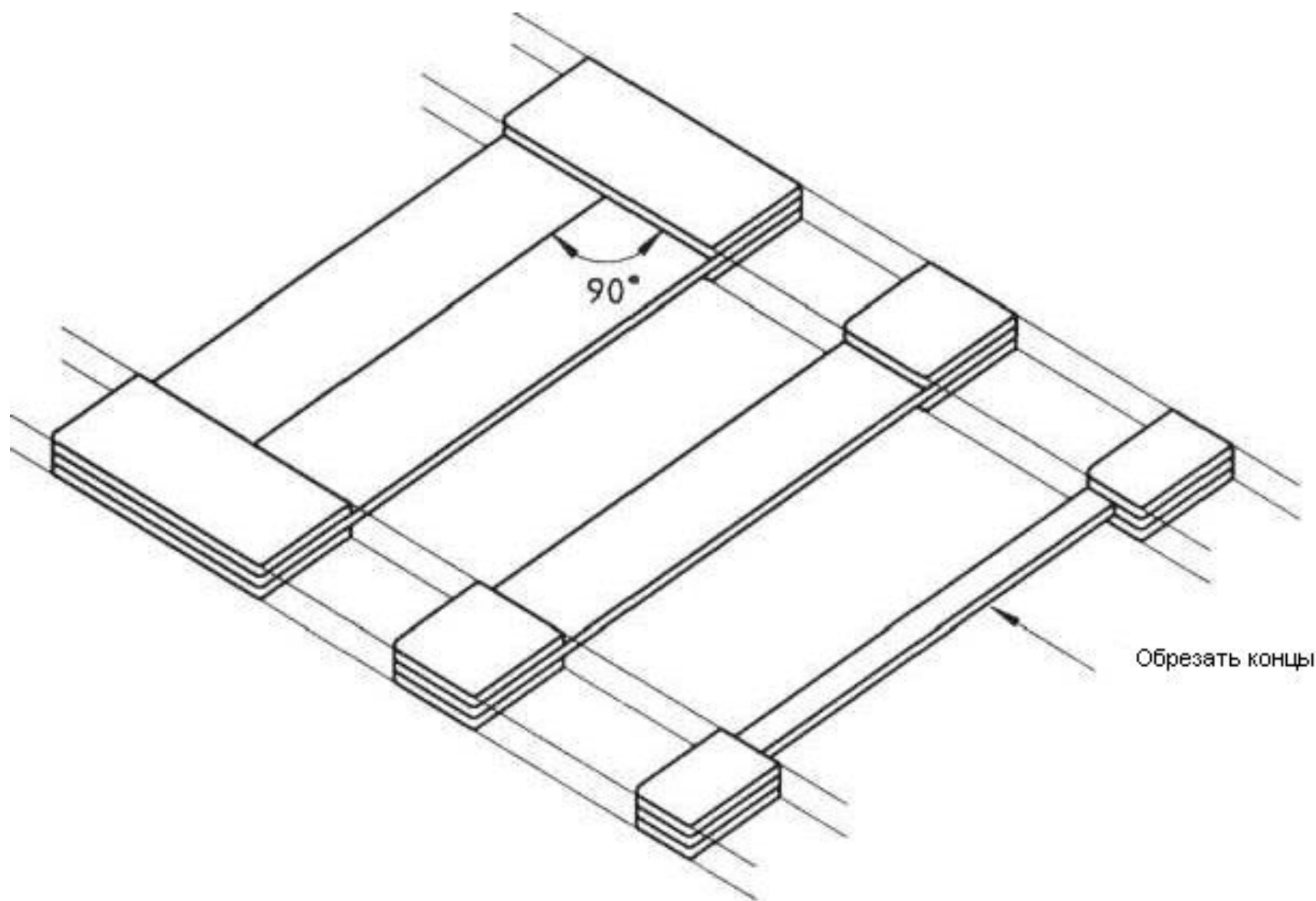
Рисунок А.1 – Прямоугольная панель для подготовки образцов
