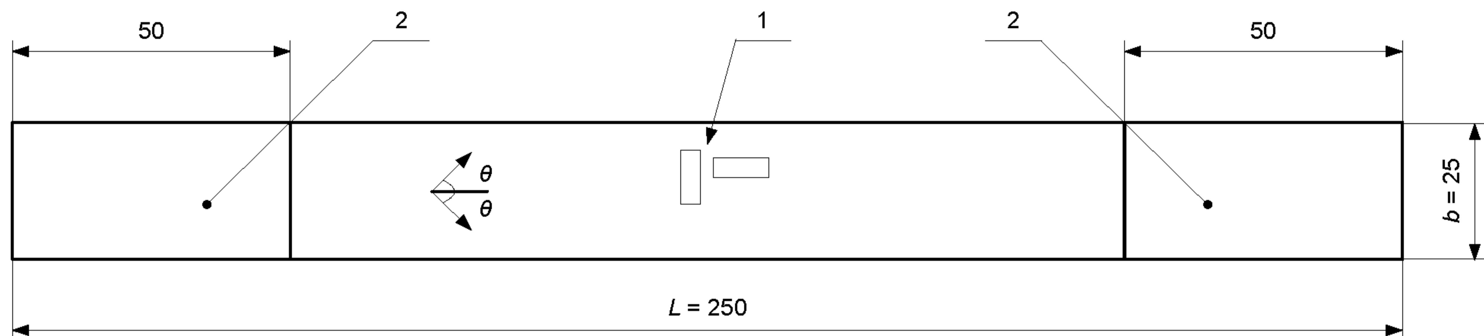
1 – датчики деформации; 2 – концевые участки;  $\theta$  – угол ориентации волокон
