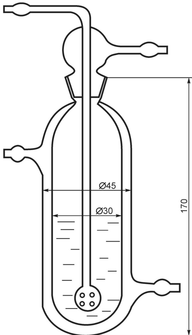
Рисунок 18 — Термостатированная склянка Дрекслея
