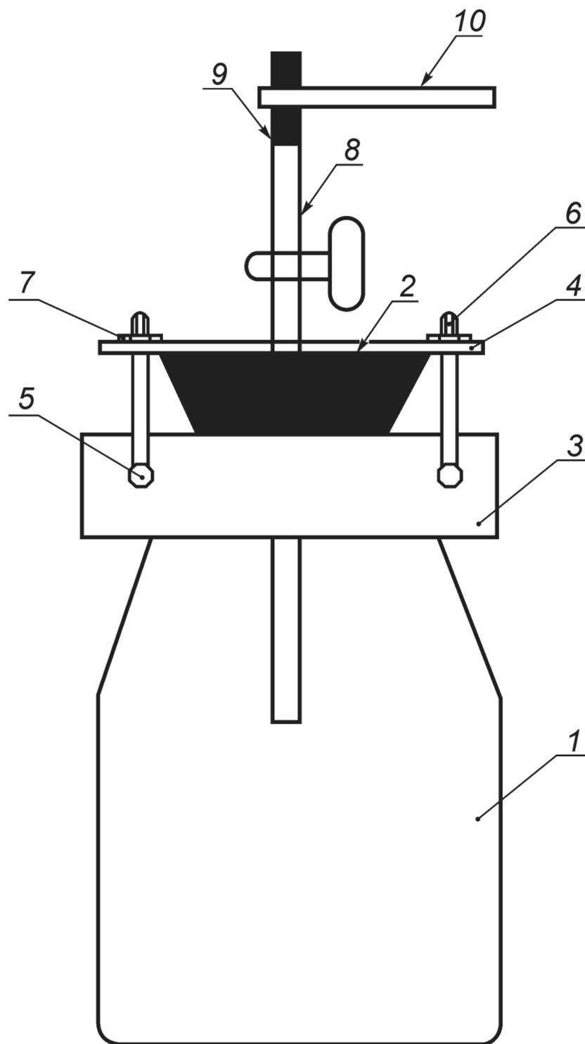
1 — толстостенная склянка вместимостью 250 см<sup>3</sup>; 2 — резиновая пробка № 22 с отверстием; 3 — полумуфта (хомут) высотой 17 мм; 4 — держатель пробки; 5 — болты для крепления полумуфты болтом и гайкой; 6 — болты для крепления держателя пробки; 7 — гайки для крепления держателя пробки; 8 — стеклянная трубка диаметром 8 мм с краном; 9 — каучуковая трубка диаметром 8 мм; 10 — зажим Мора
