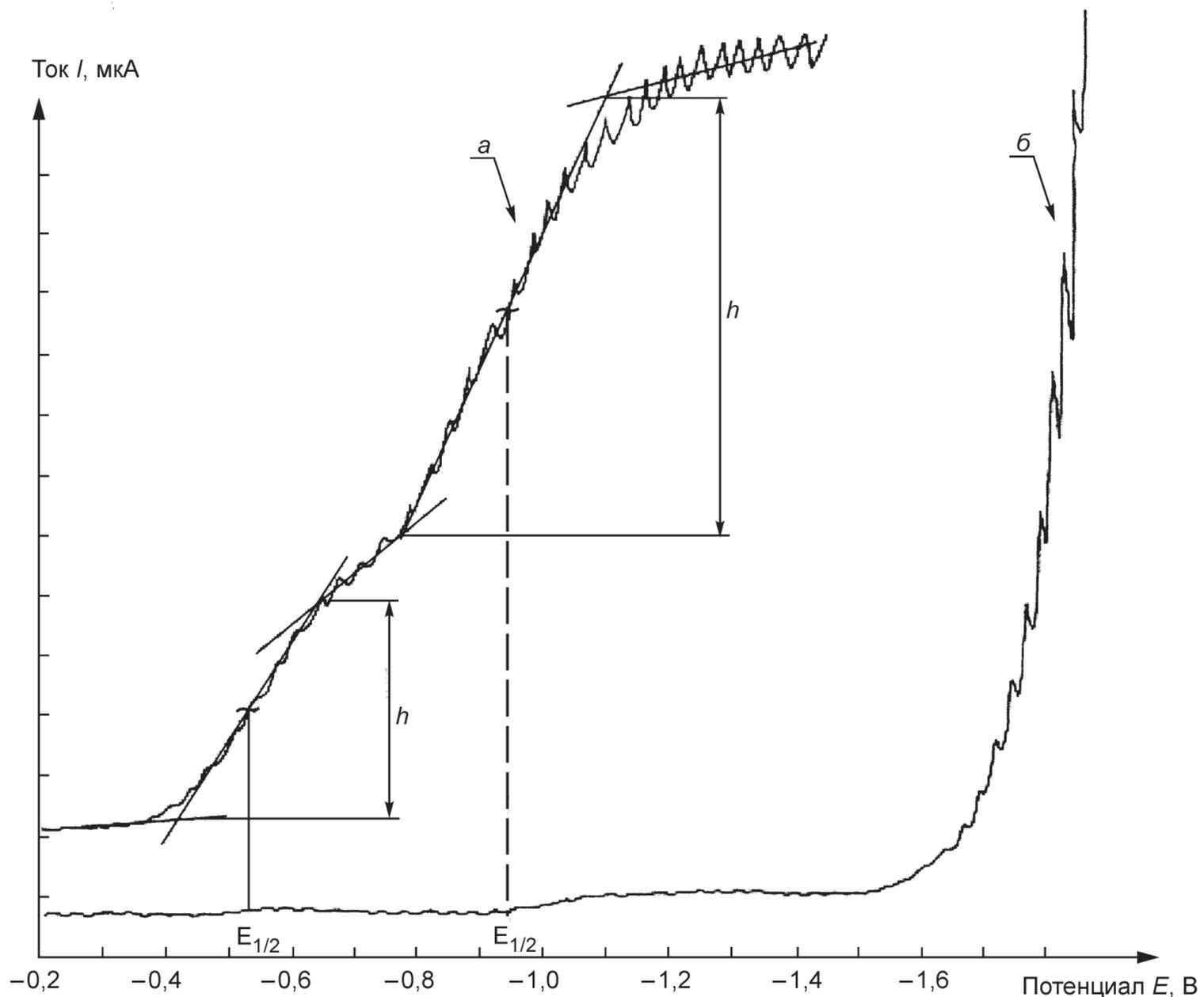
а — полярограмма модельной смеси ингибитора ИПОН и гидроперекиси изопропилбензола в бутадиене-1,3 на фоне хлористого лития молярной концентрации  $c(\text{LiCl}) = 0,3$  моль/дм<sup>3</sup> в смеси бензол-метанол (1:1);
