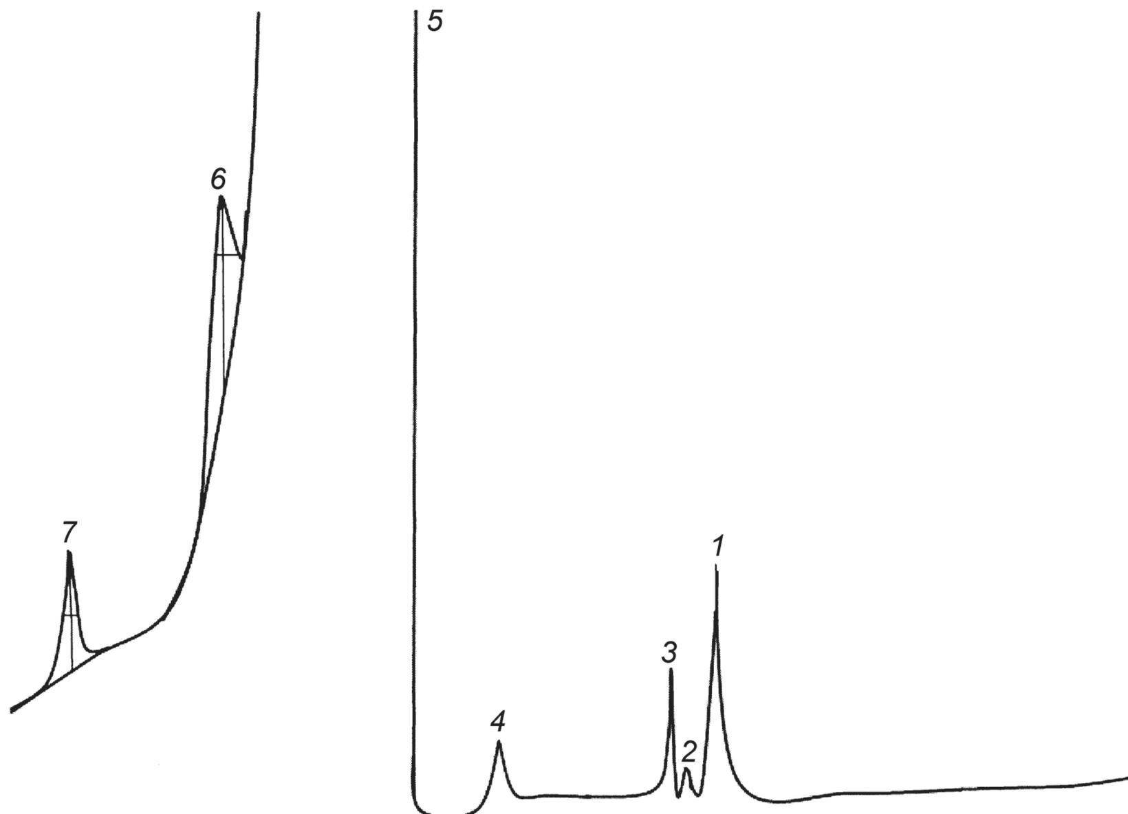
1 — пропилен; 2 — метилацетилен; 3 — аллен; 4 — изобутан; 5 — бутадиен-1,3; 6 — цис- $\beta$ -бутилен; 7 — метилаллен
