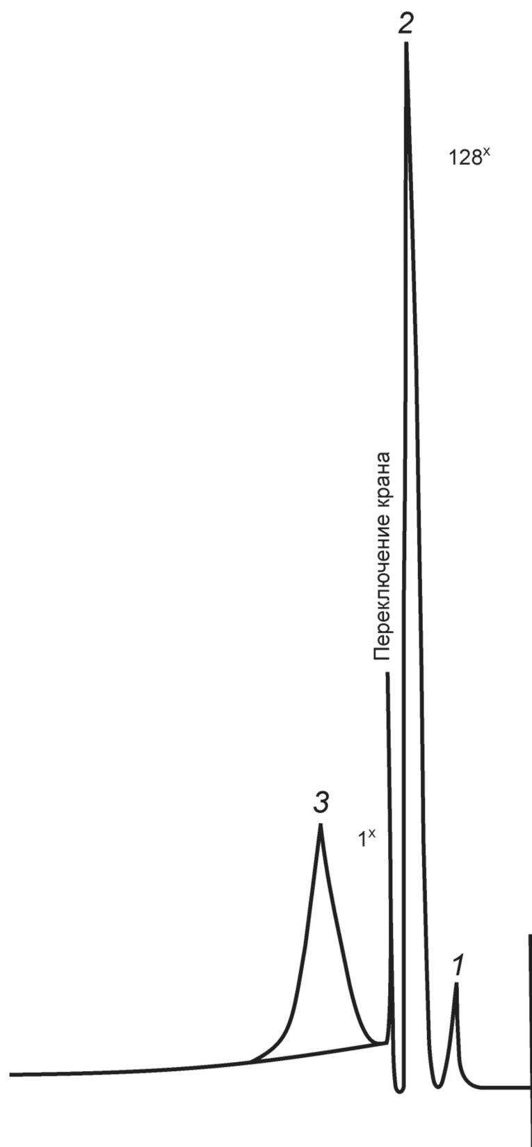
1 — сумма углеводородов C<sub>3</sub>—C<sub>4</sub>; 2 — сумма углеводородов C<sub>4</sub>; 3 — тяжелый остаток
