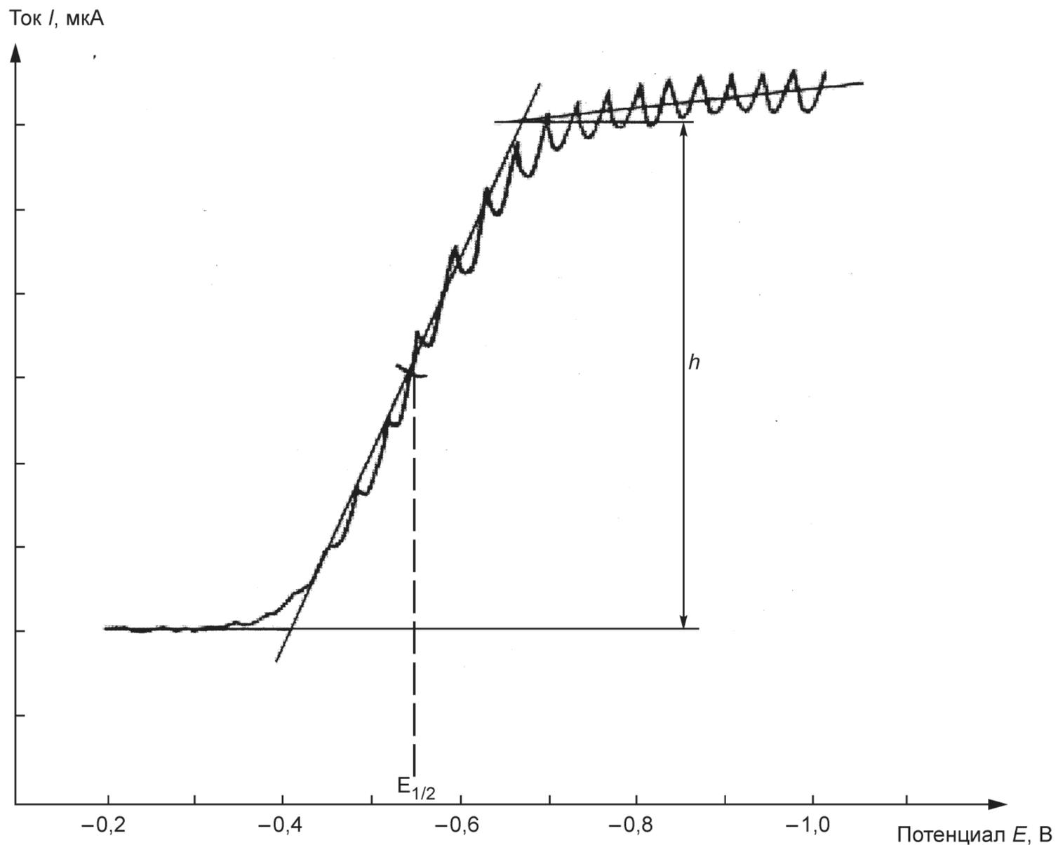
Рисунок 21 — Полярограмма ингибитора ИПОН на фоне хлористого лития молярной концентрации  $c(\text{LiCl}) = 0,3$  моль/дм<sup>3</sup> в смеси бензол-метанол (1:1)
