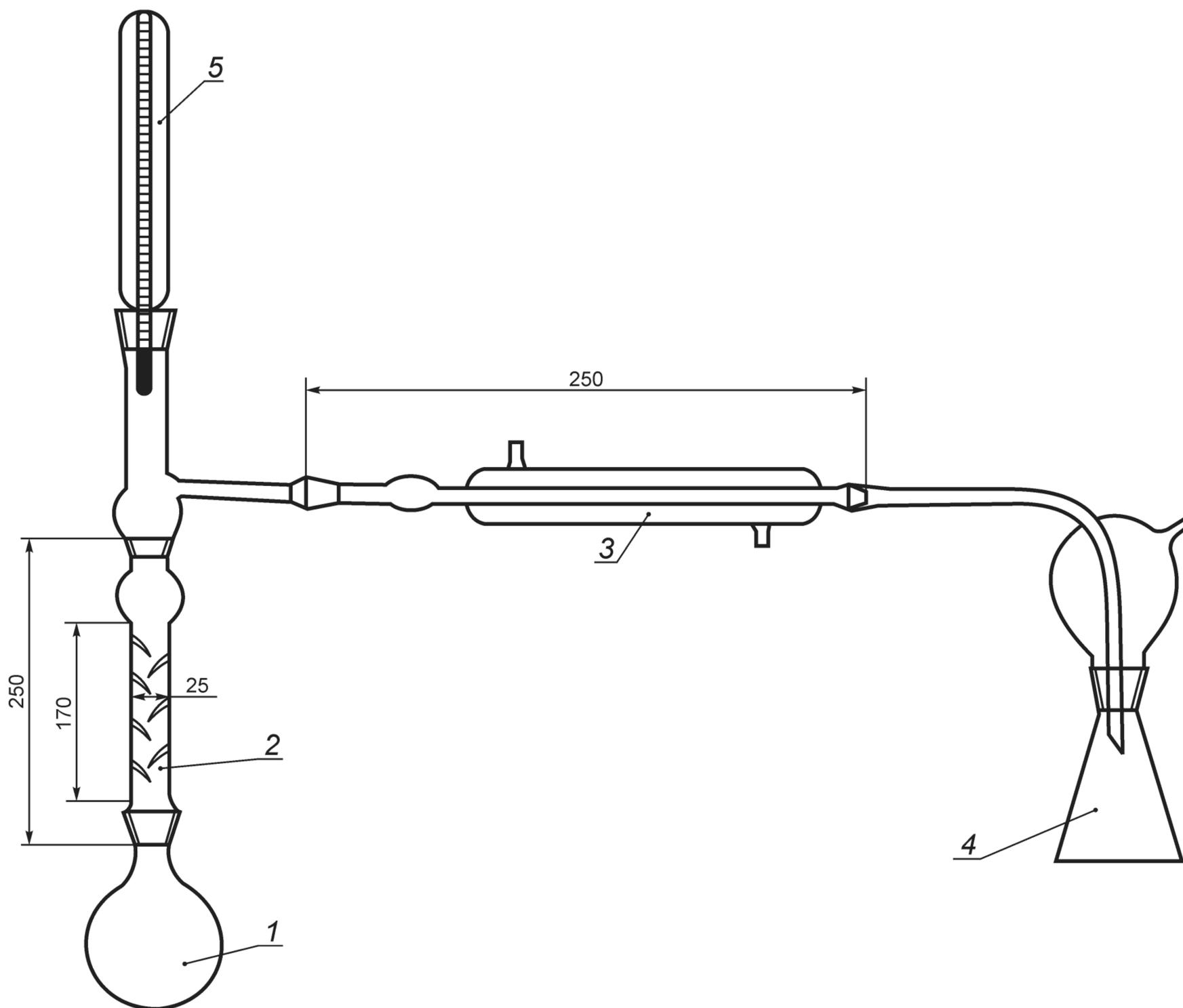
1 — колба; 2 — елочный дефлегматор; 3 — холодильник; 4 — колба-приемник; 5 — термометр
