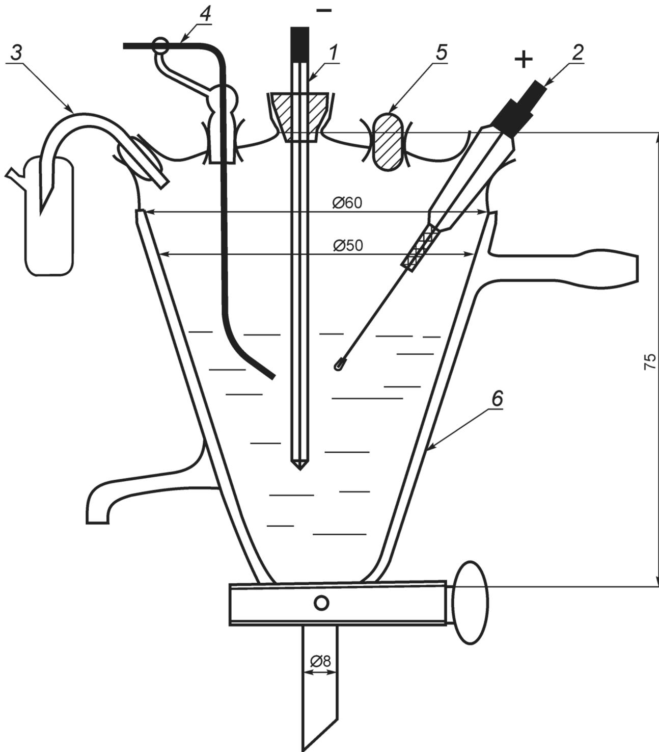
1 — ртутный капающий электрод; 2 — хлорсеребряный электрод; 3 — гидрозатвор; 4 — трубка для подачи азота;
