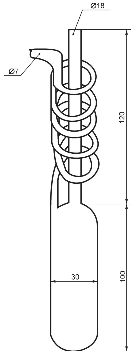
Рисунок 5 — Ампула со змеевиком
