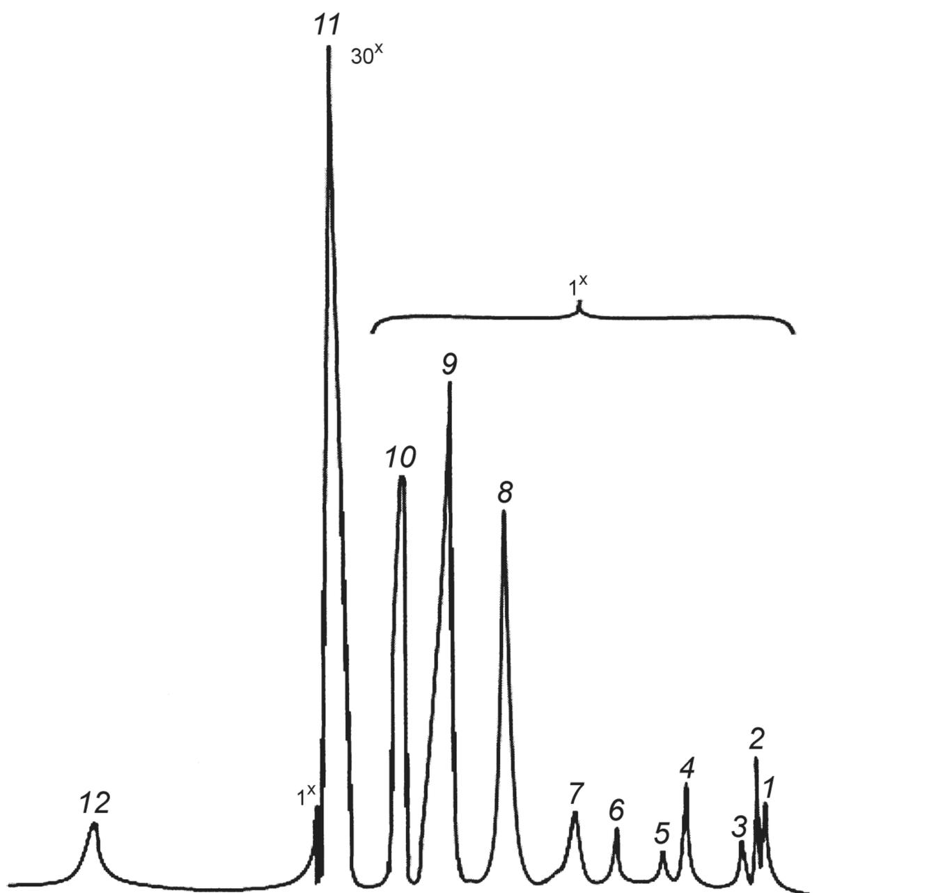
1 — метан; 2 —  $\Sigma C_2$  (этан + этилен); 3 — углекислый газ; 4 — пропан; 5 — пропен; 6 — изобутан; 7 — *n*-бутан;
