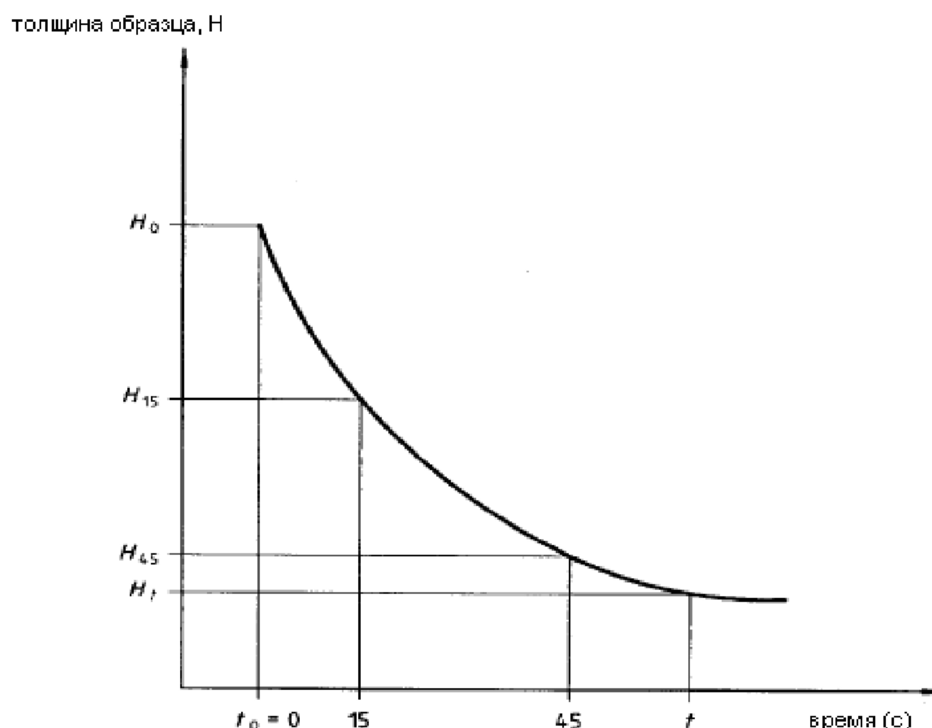
$H_0$  – толщина при первоначальной нагрузке;  $H_1$  – толщина по истечении времени  $t$
