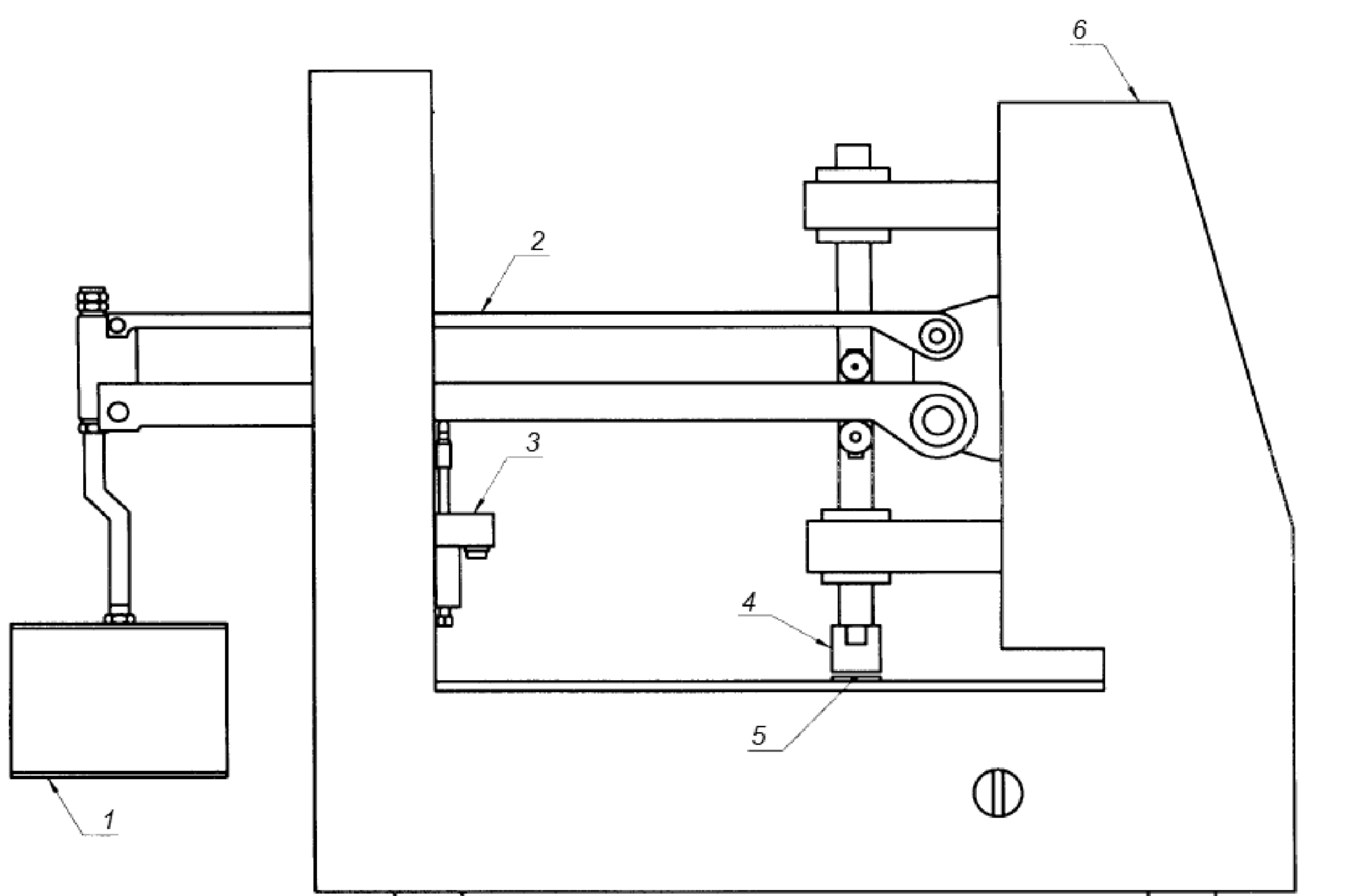
1 – груз; 2 – рычаги, предназначенные для передачи нагрузки; 3 – датчик перемещения; 4 – пуансон; 5 – плита; 6 – рама
