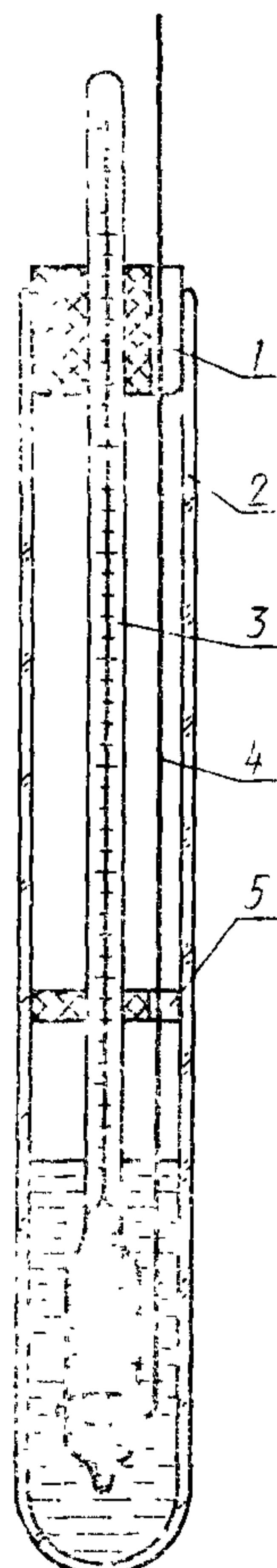
1 — пробка; 2 — пробирка; 3 — термометр;
