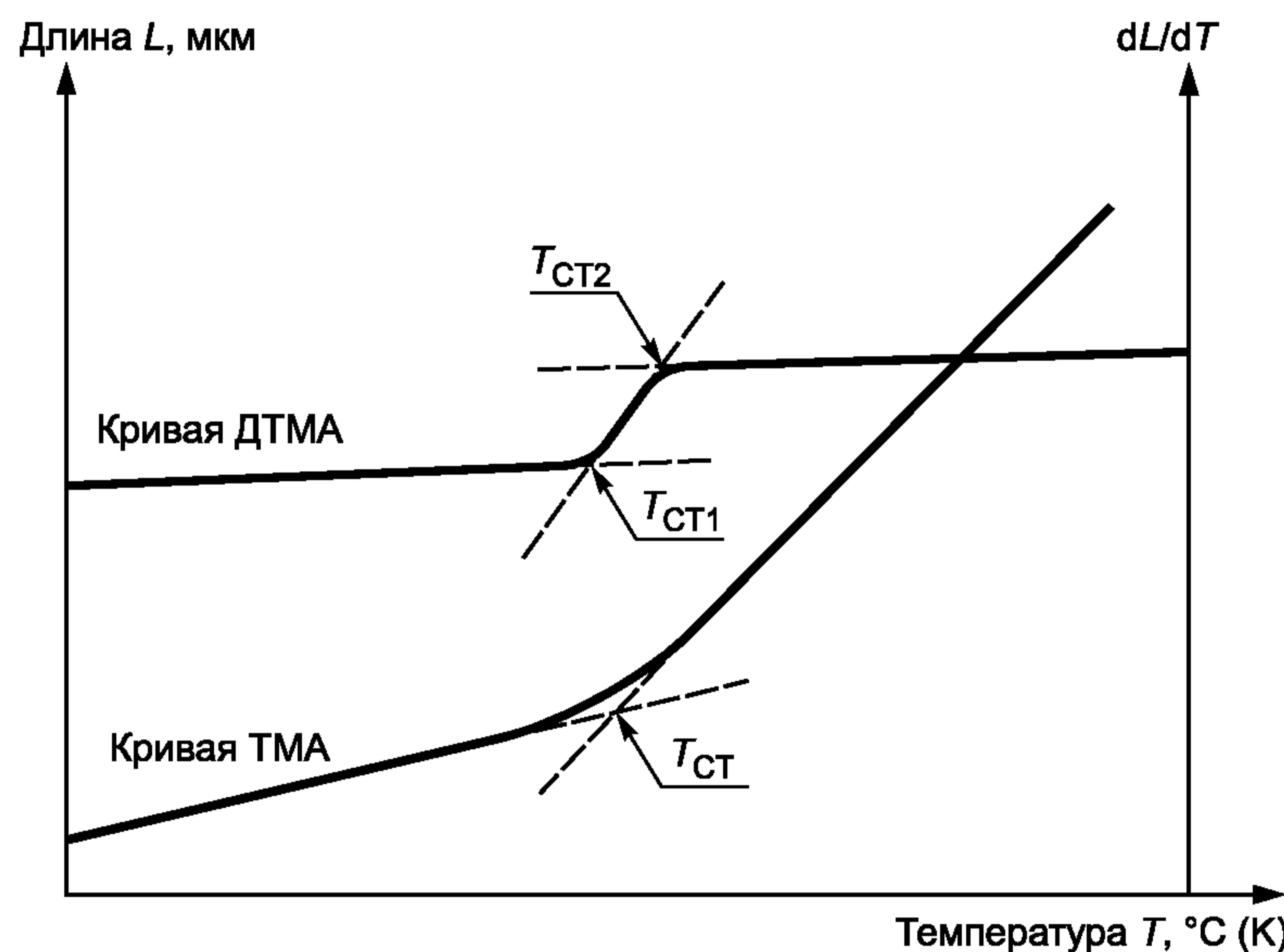
Рисунок 7.3 — Определение температуры стеклования
