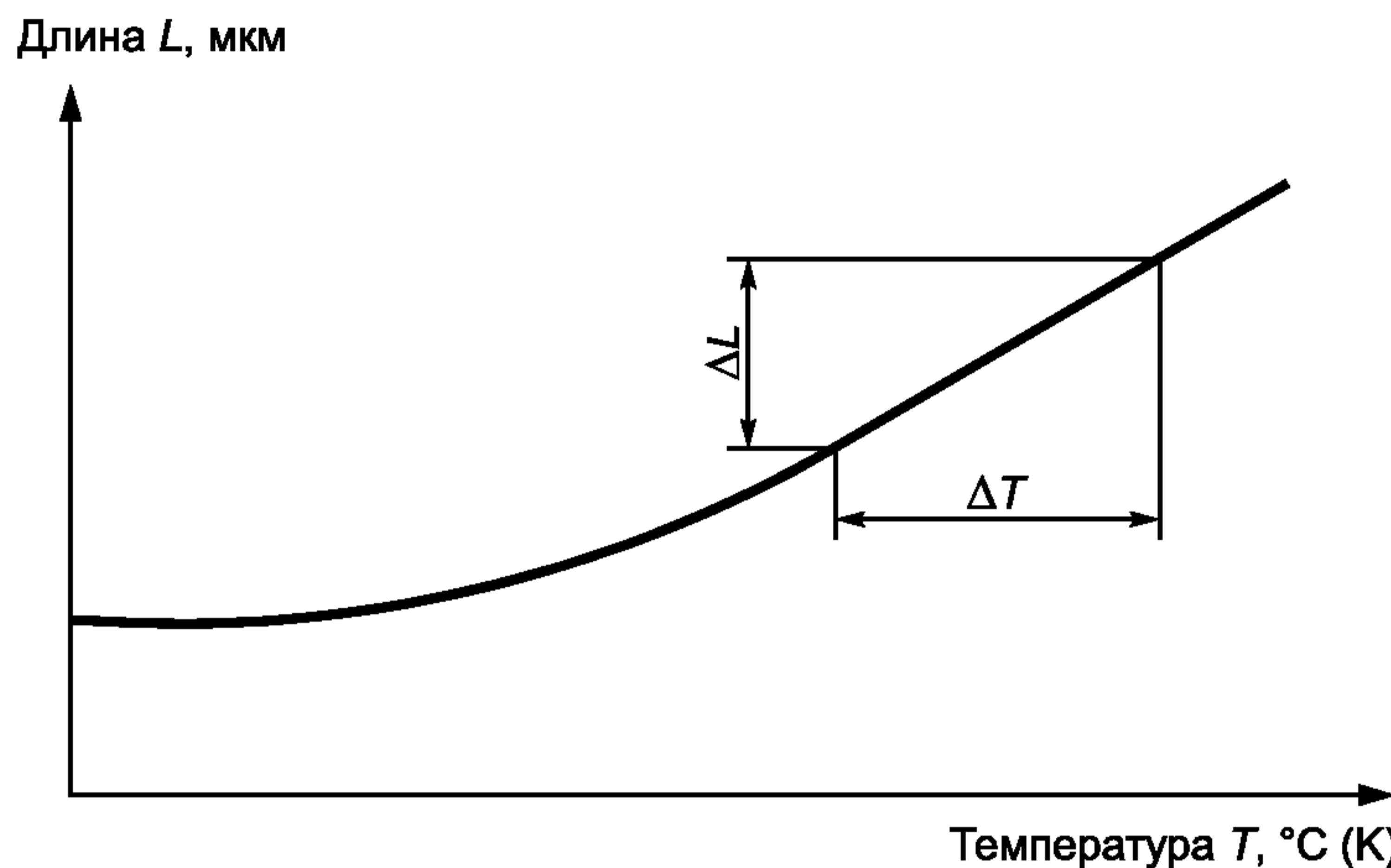
Рисунок 7.2 — Определение среднего коэффициента линейного теплового расширения  $\bar{\alpha}$
