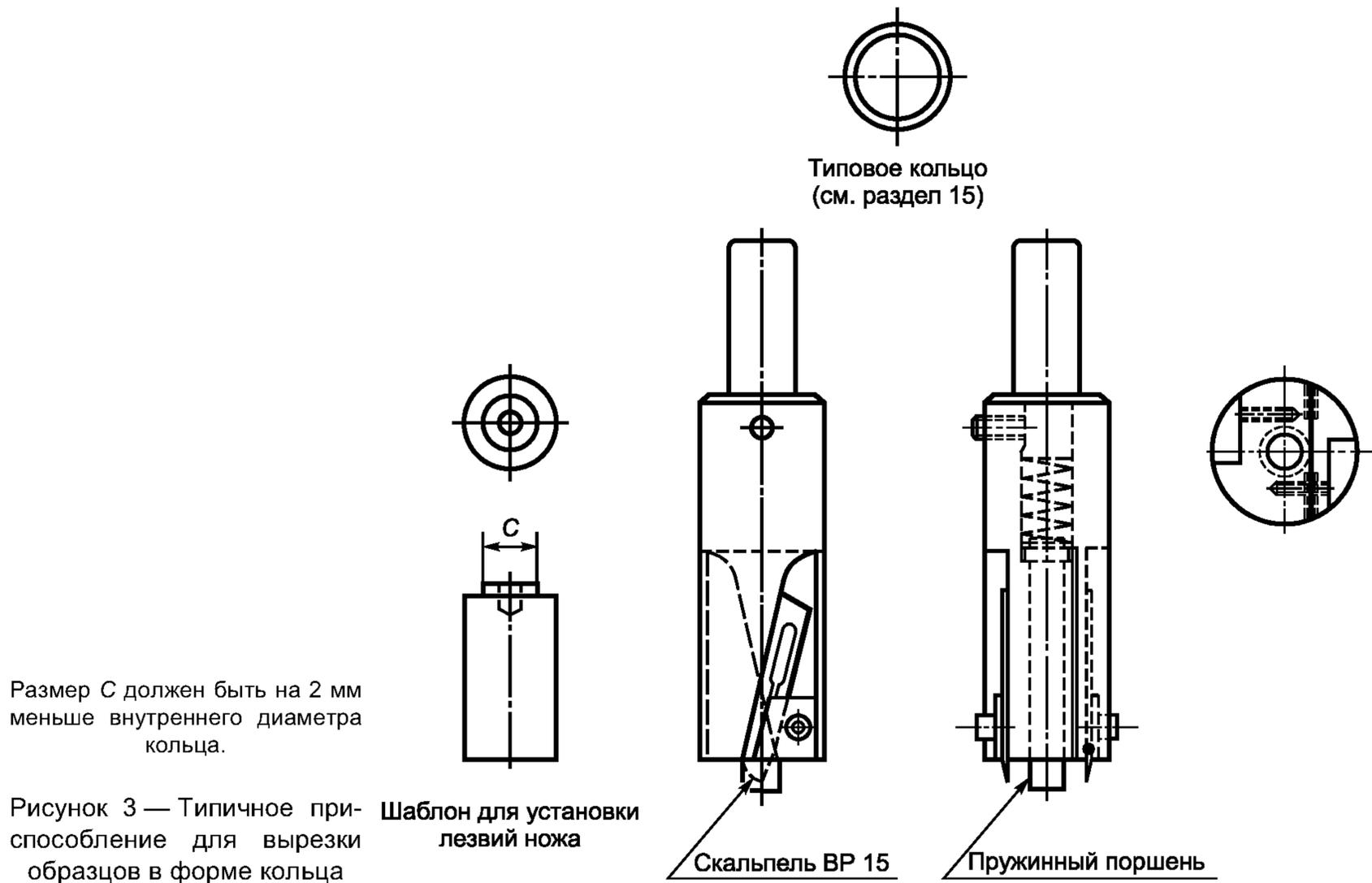
Для вырезания образцов в форме кольца из плоских пластин резины используют вращающиеся ножи, которые опускаются на пластину, закрепленную на плите, как показано на рисунке 4.
