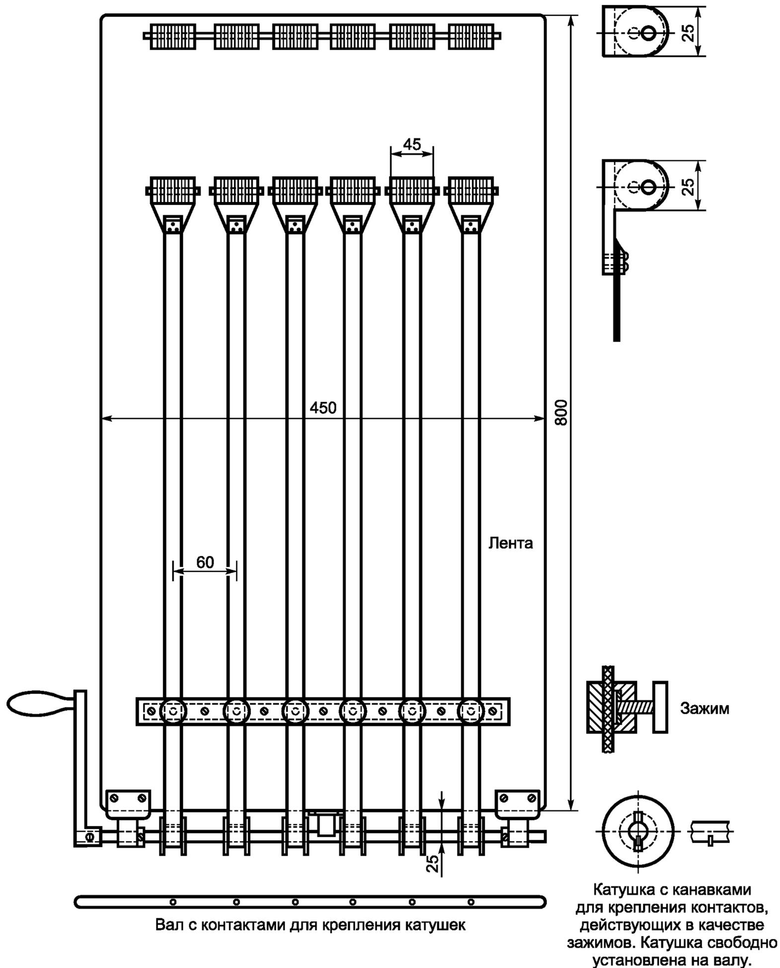
Рисунок 1 — Устройство для определения остаточной деформации при растяжении
