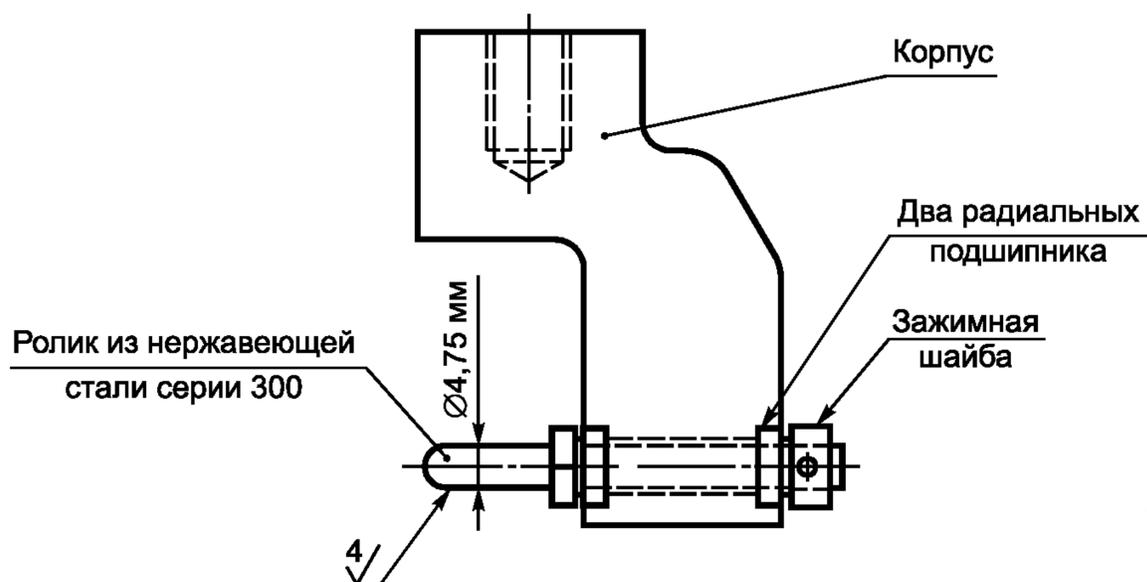
Рисунок 5 — Приспособление для зажима образца в форме кольца при проведении испытания на растяжение
