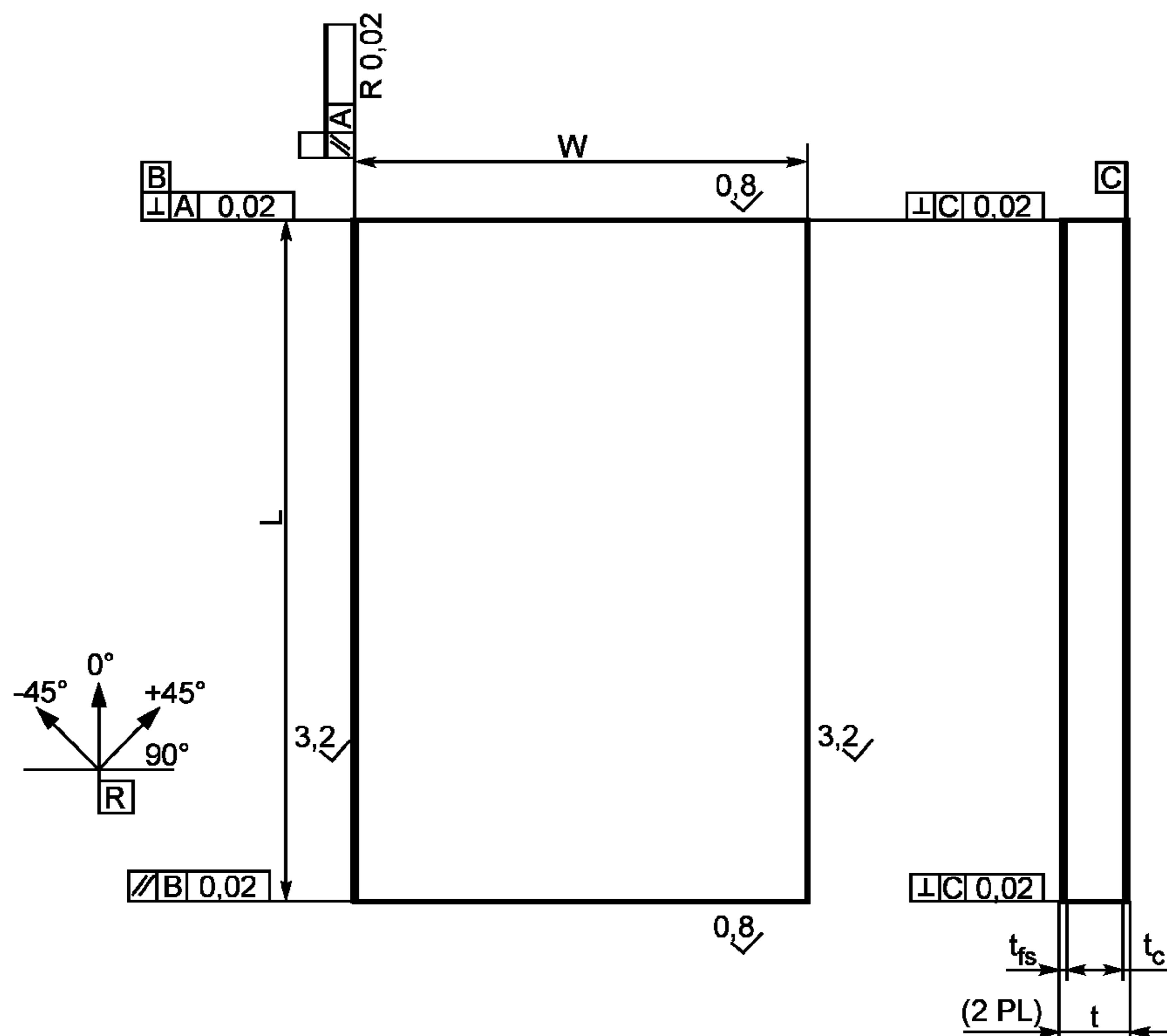
Рисунок 1 — Размеры образцов
