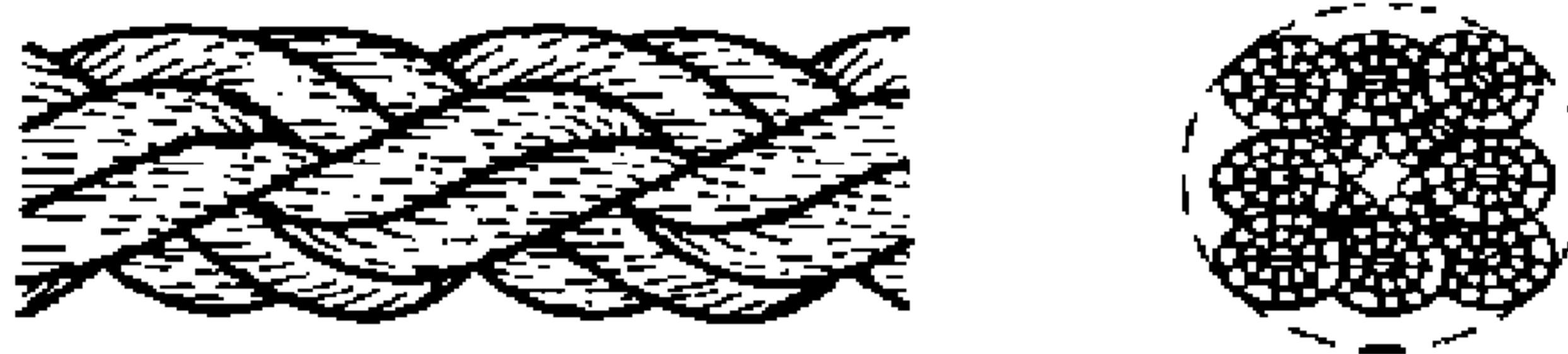
Рисунок 3 — Конфигурация 8-прядного плетеного каната (тип L)
