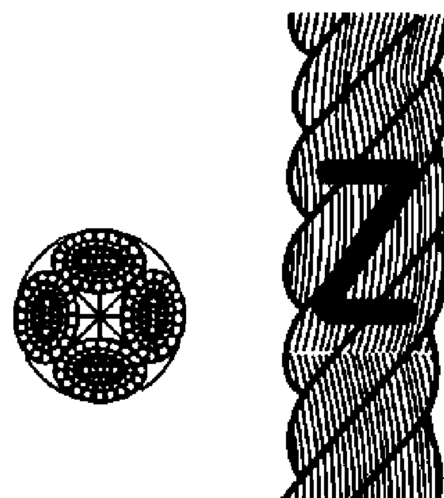
Рисунок 2 — Конфигурация 4-прядного крученого каната (тип В)
