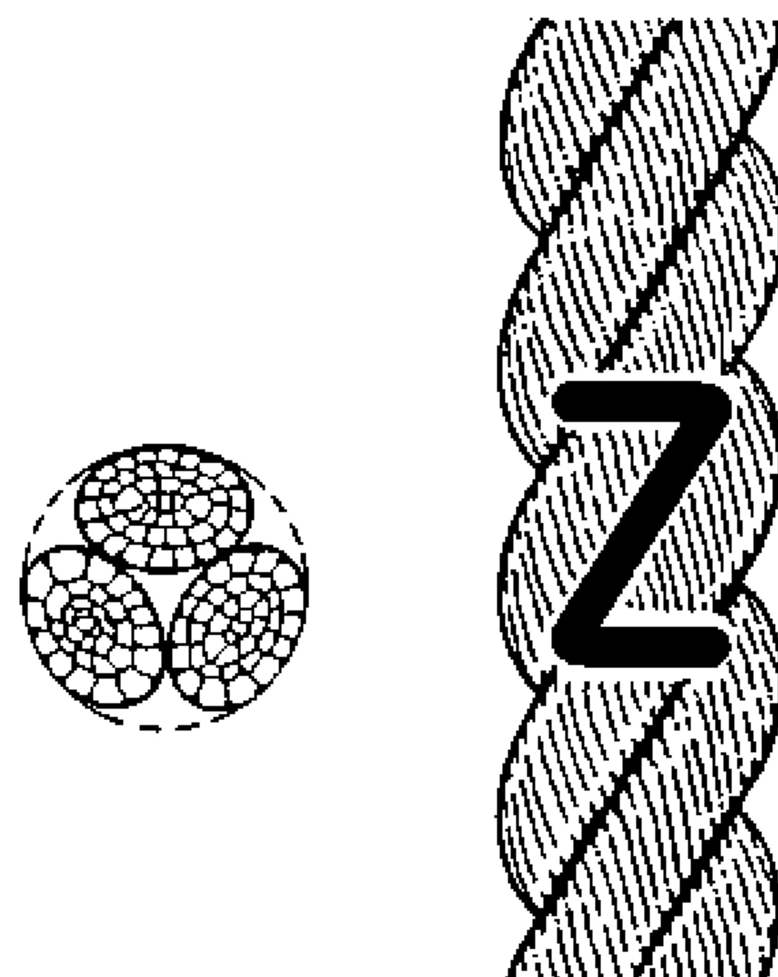
Рисунок 1 — Конфигурация 3-прядного крученого каната (тип А)
