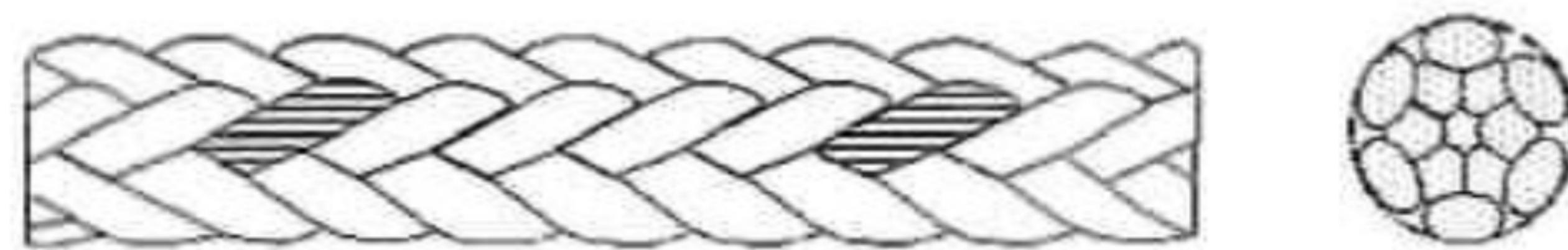
Рисунок 4 — Конфигурация 12-прядного плетеного каната (тип Т)
