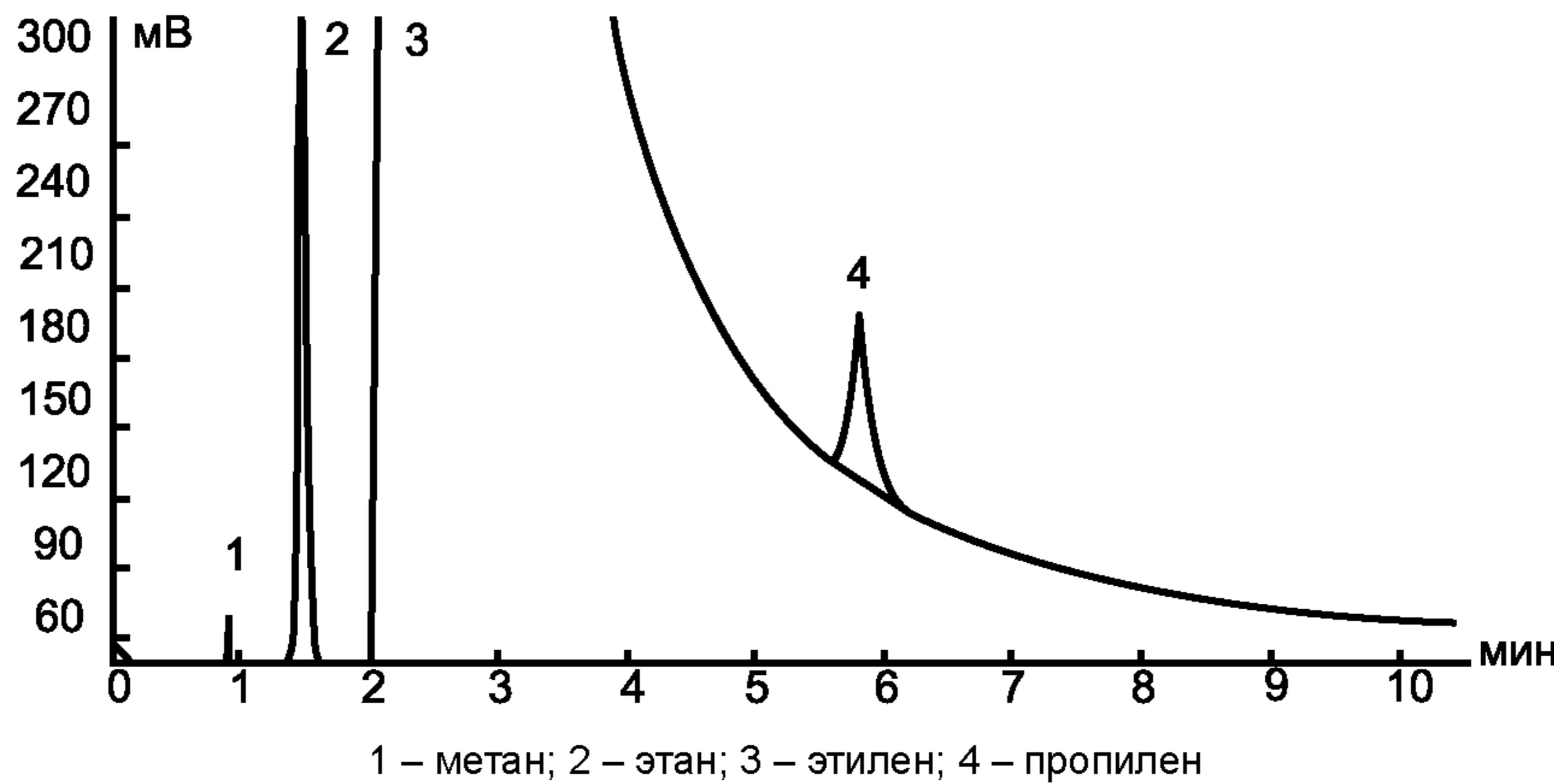
Рисунок 2 – Типовая хроматограмма этилена на насадочной колонке с  $\text{Al}_2\text{O}_3$
