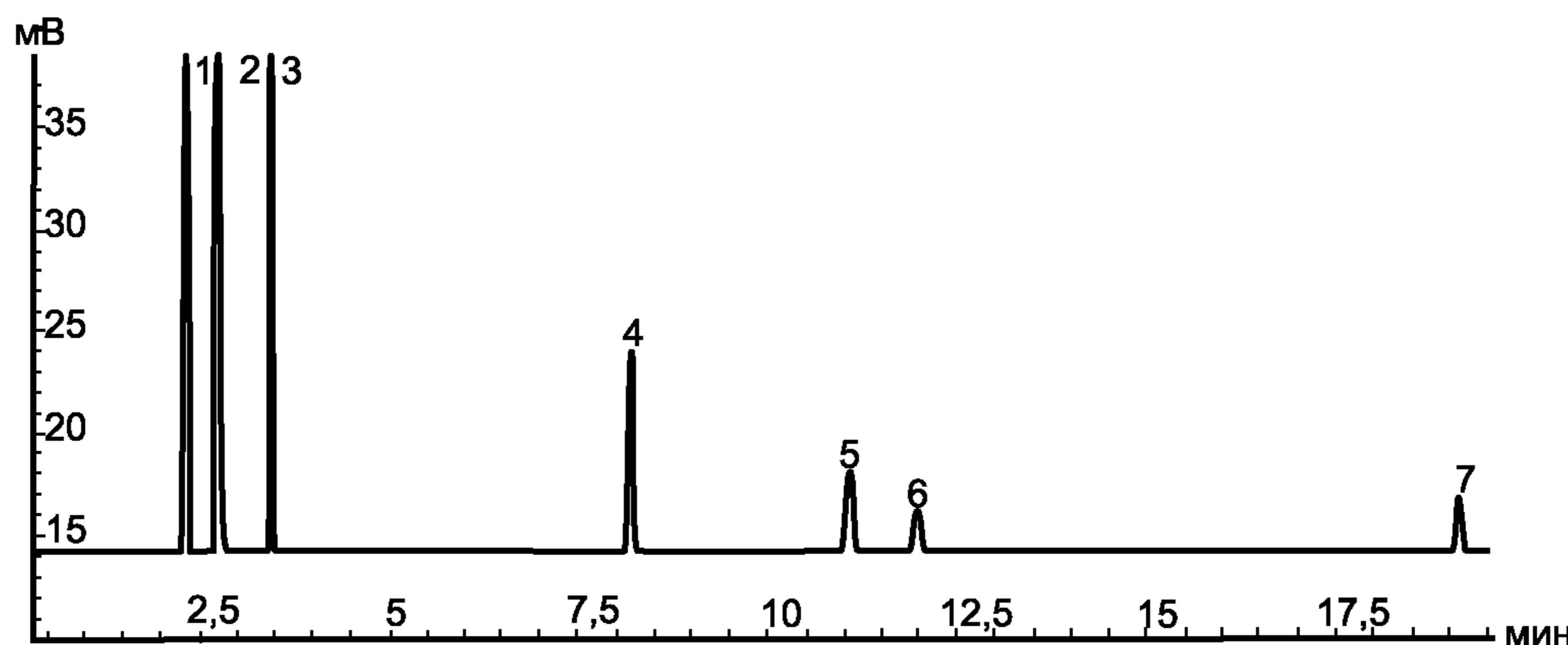
1 – метан; 2 – этан; 3 – этилен; 4 – пропилен; 5 – пропадиен, 6 – ацетилен; 7 – бутадиен-1,3
