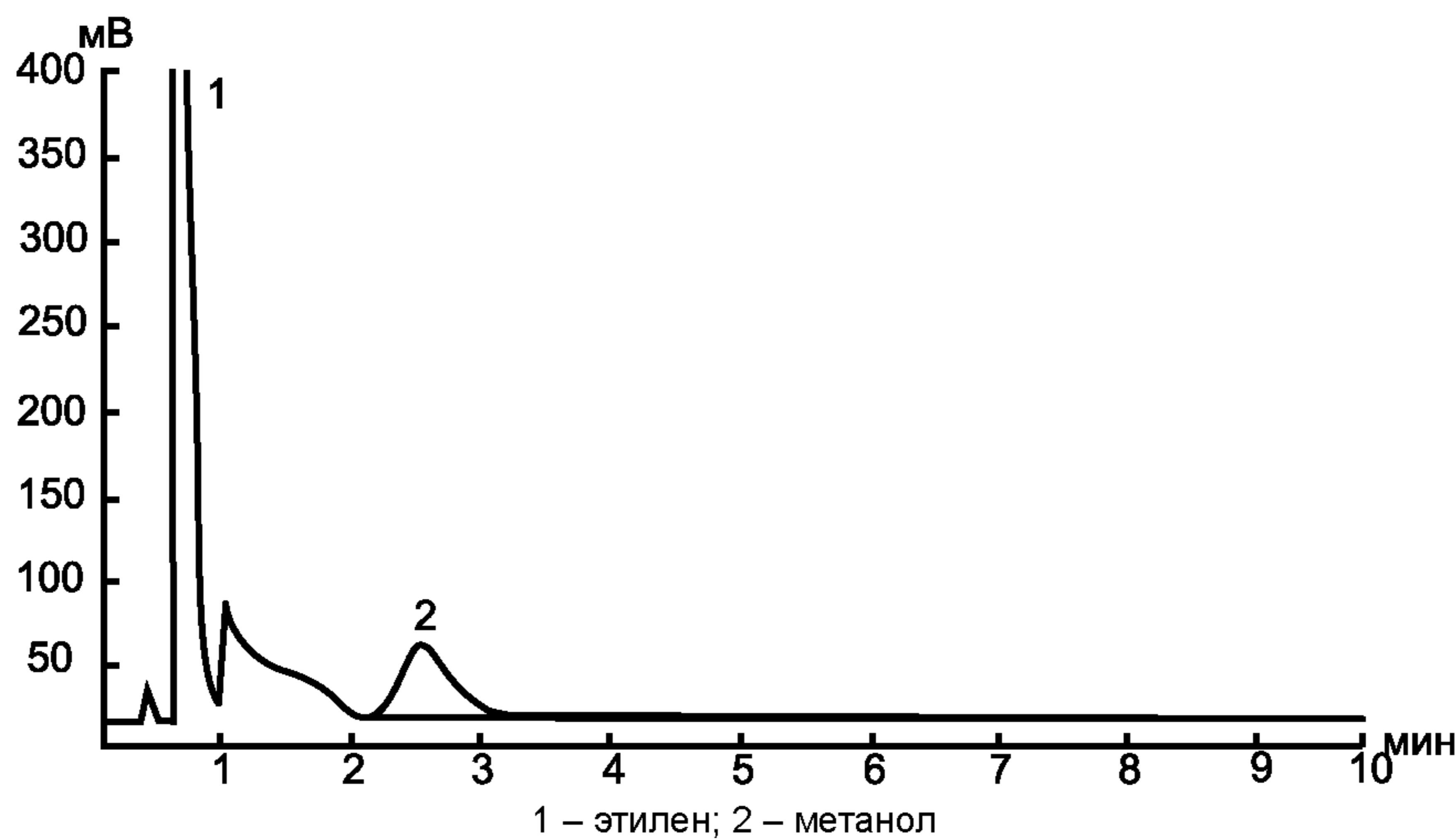
Рисунок 6 – Типовая хроматограмма метанола в этилене (при пропускании этилена через воду)
