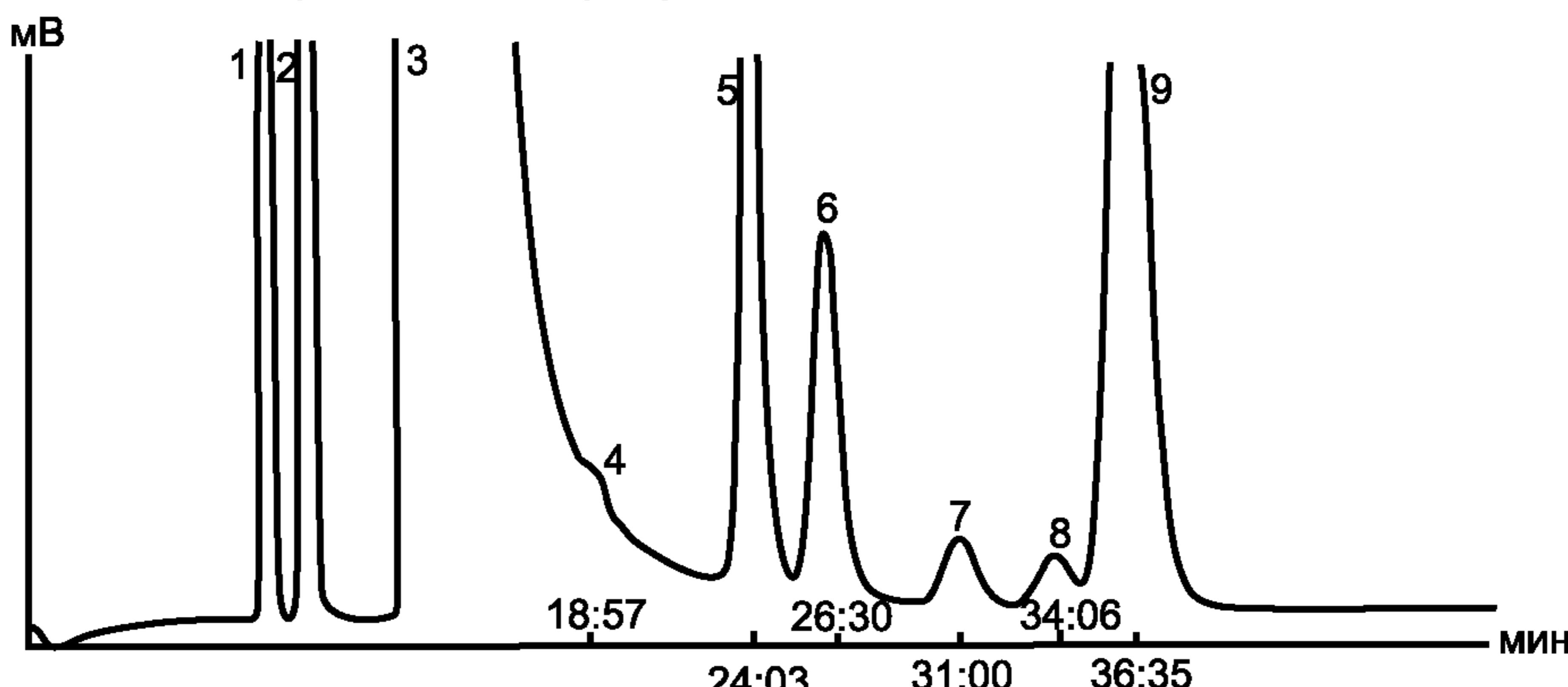
1 – этан; 2 – пропан; 3 – пропилен; 4 – изобутан; 5 – пропадиен; 6 – н-бутан; 7 – метилацетилен; 8 – цис-бутилен; 9 – бутадиен-1,3
