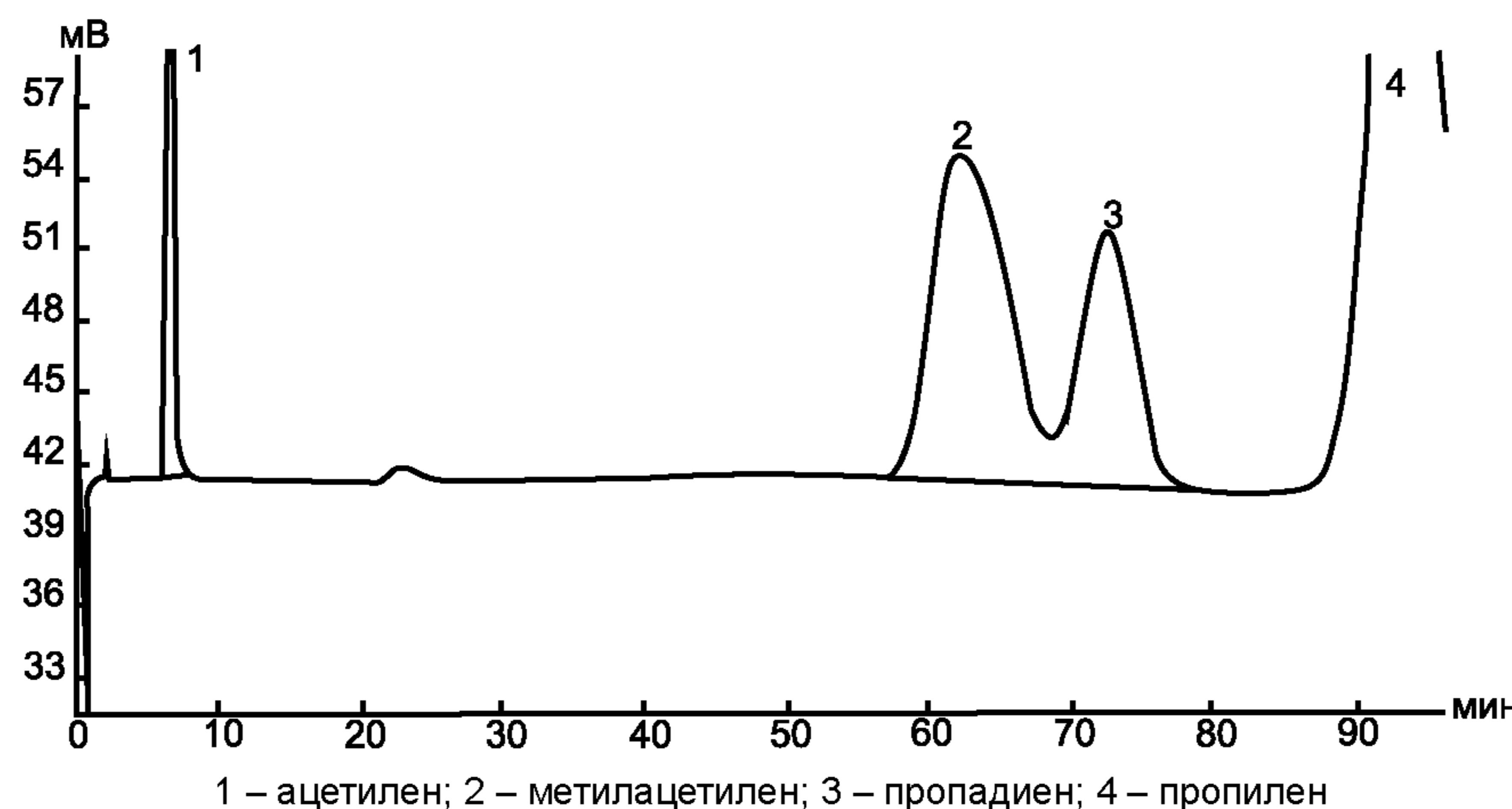
1 – ацетилен; 2 – метилацетилен; 3 – пропадиен; 4 – пропилен
