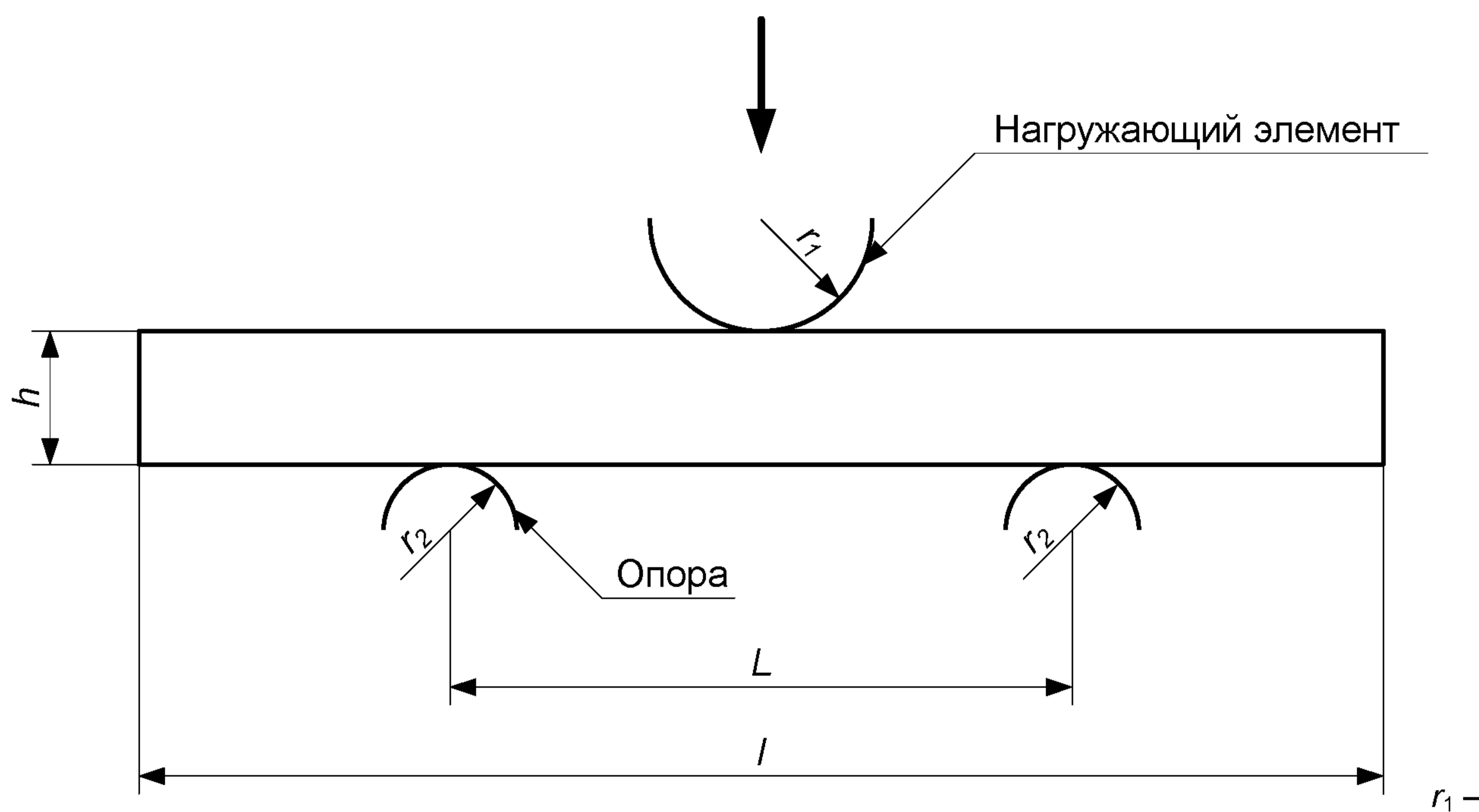
$r_1$  – радиус нагружающего наконечника;  $r_2$  – радиус опор;
