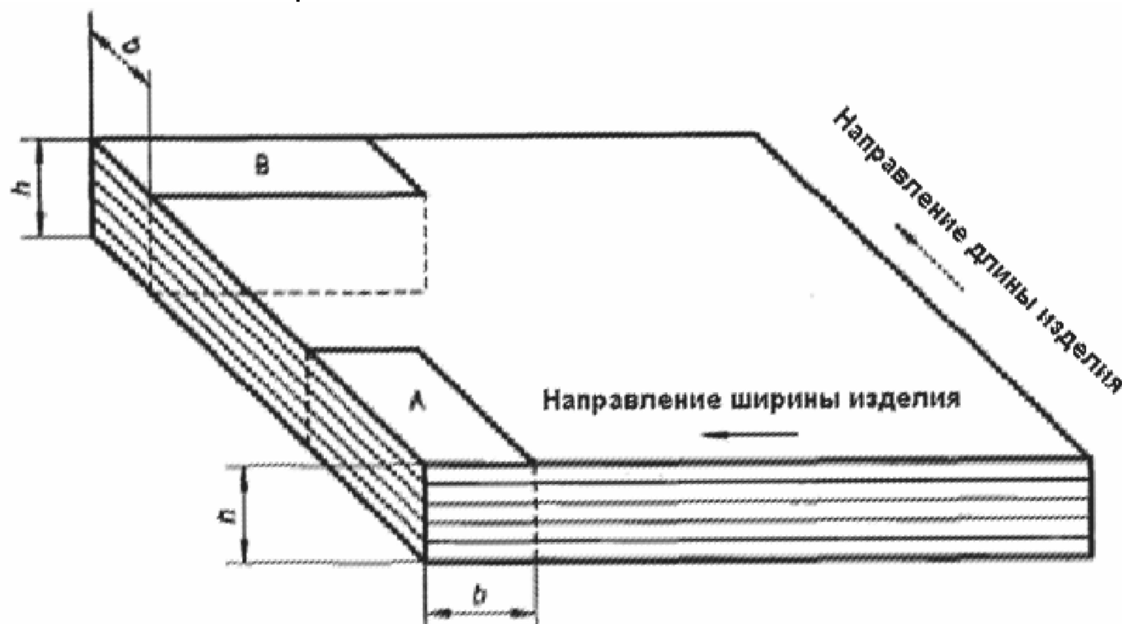
Рисунок 3 — Расположение образцов для испытания
