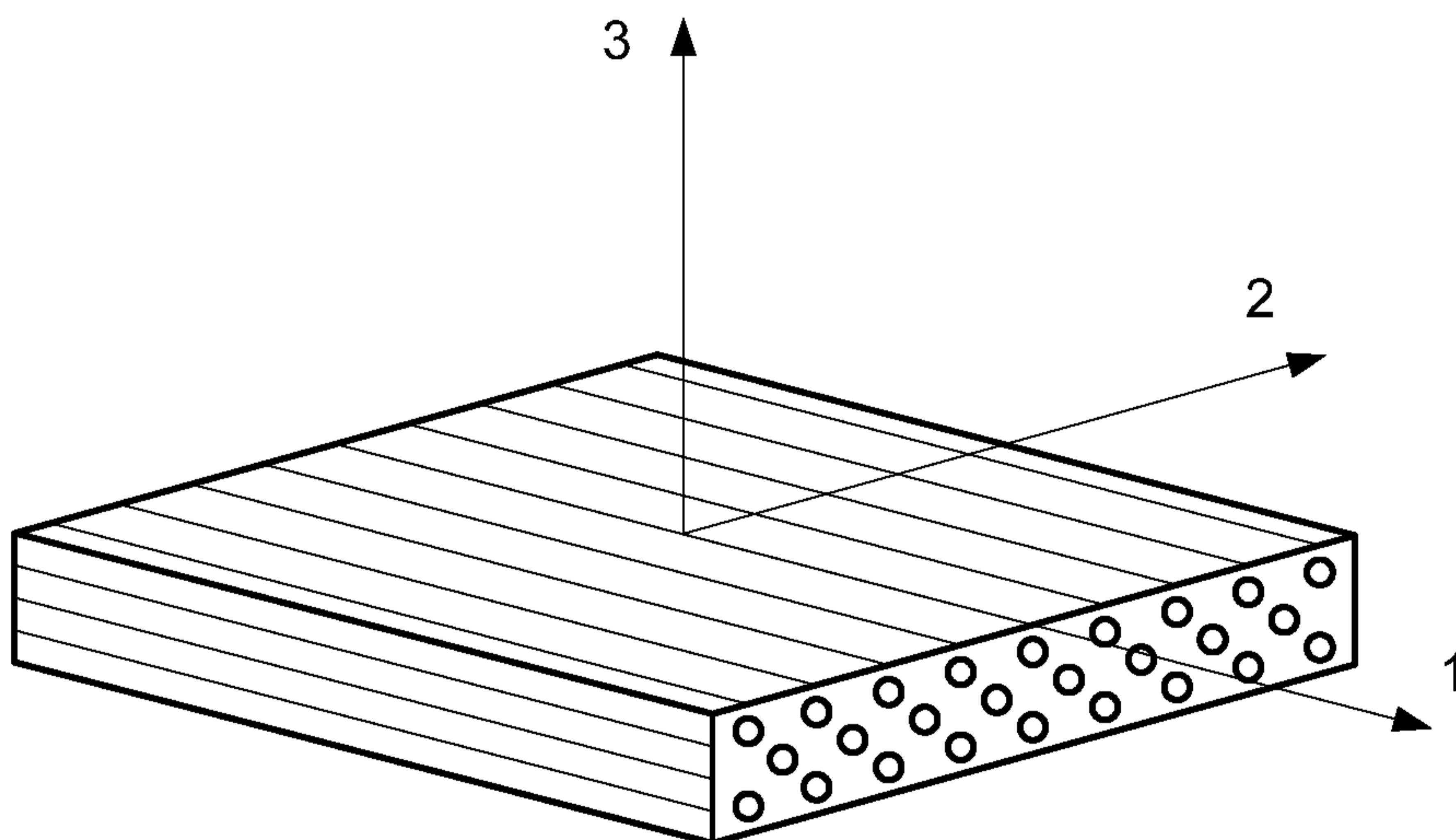
Рисунок 1 – Элемент пластины из композиционного материала, армированного одноравленным волокном с указанием осей симметрии
