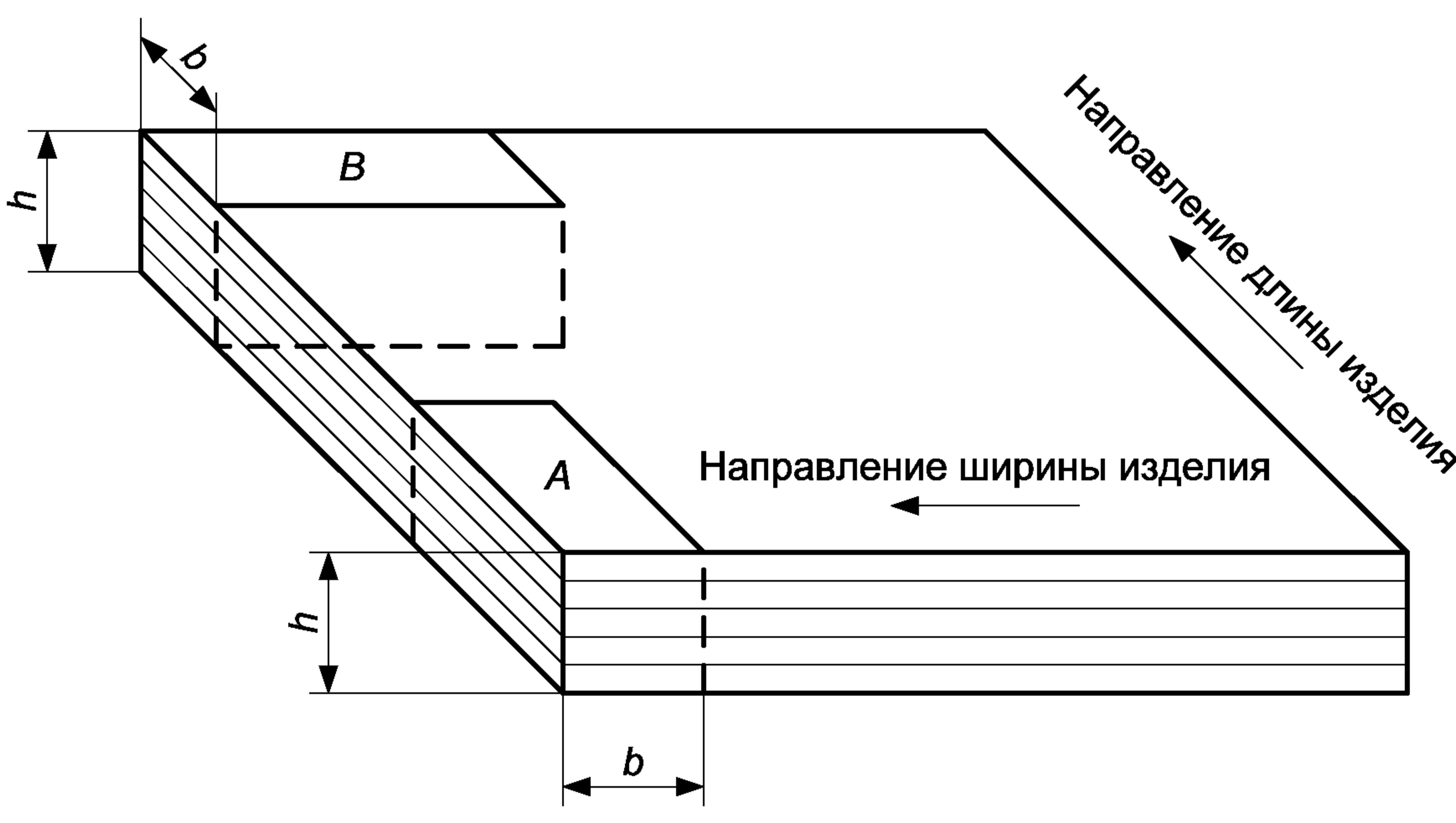
Рисунок 3 – Расположение образцов
