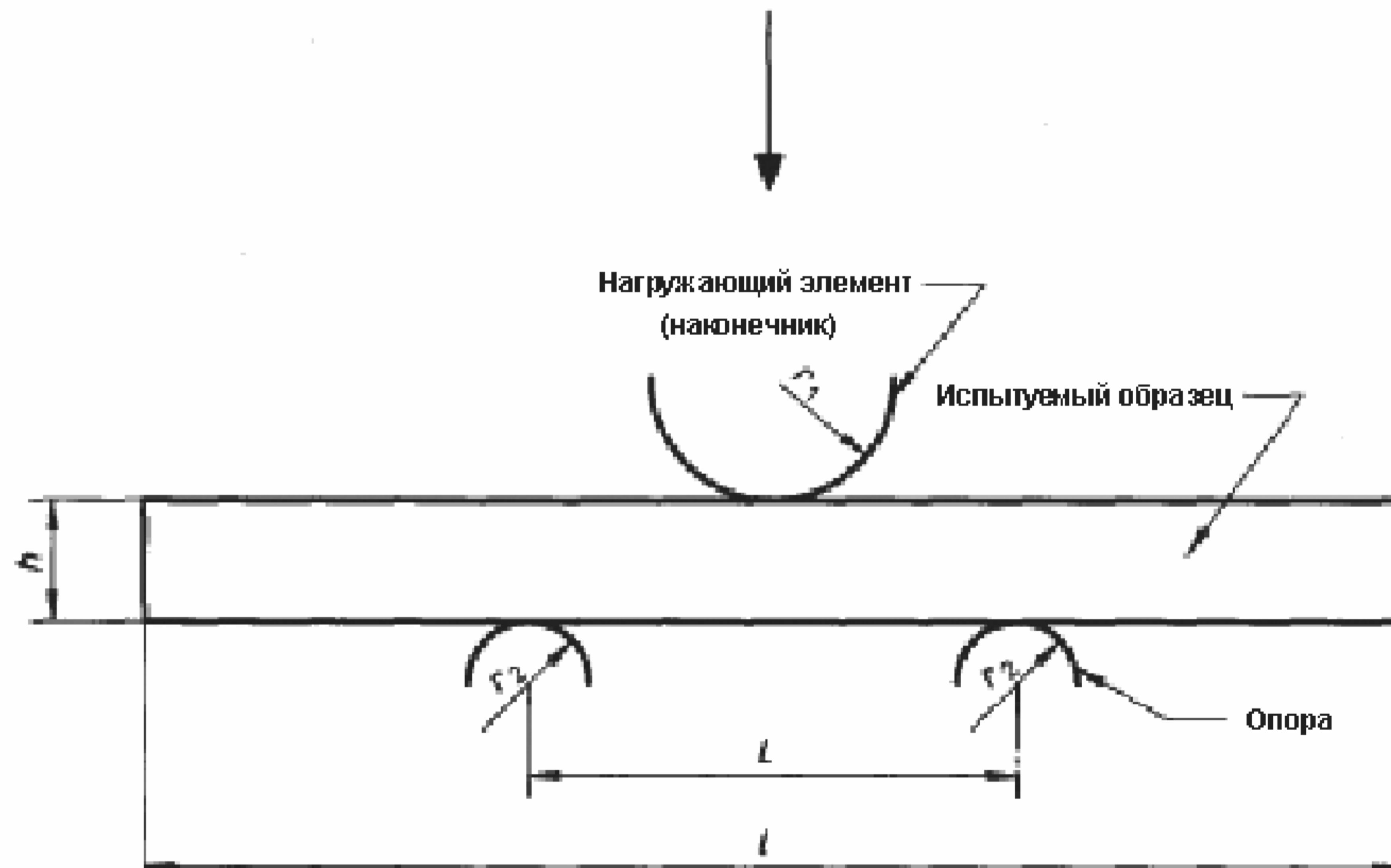
Рисунок 2 — Конфигурация нагружения
