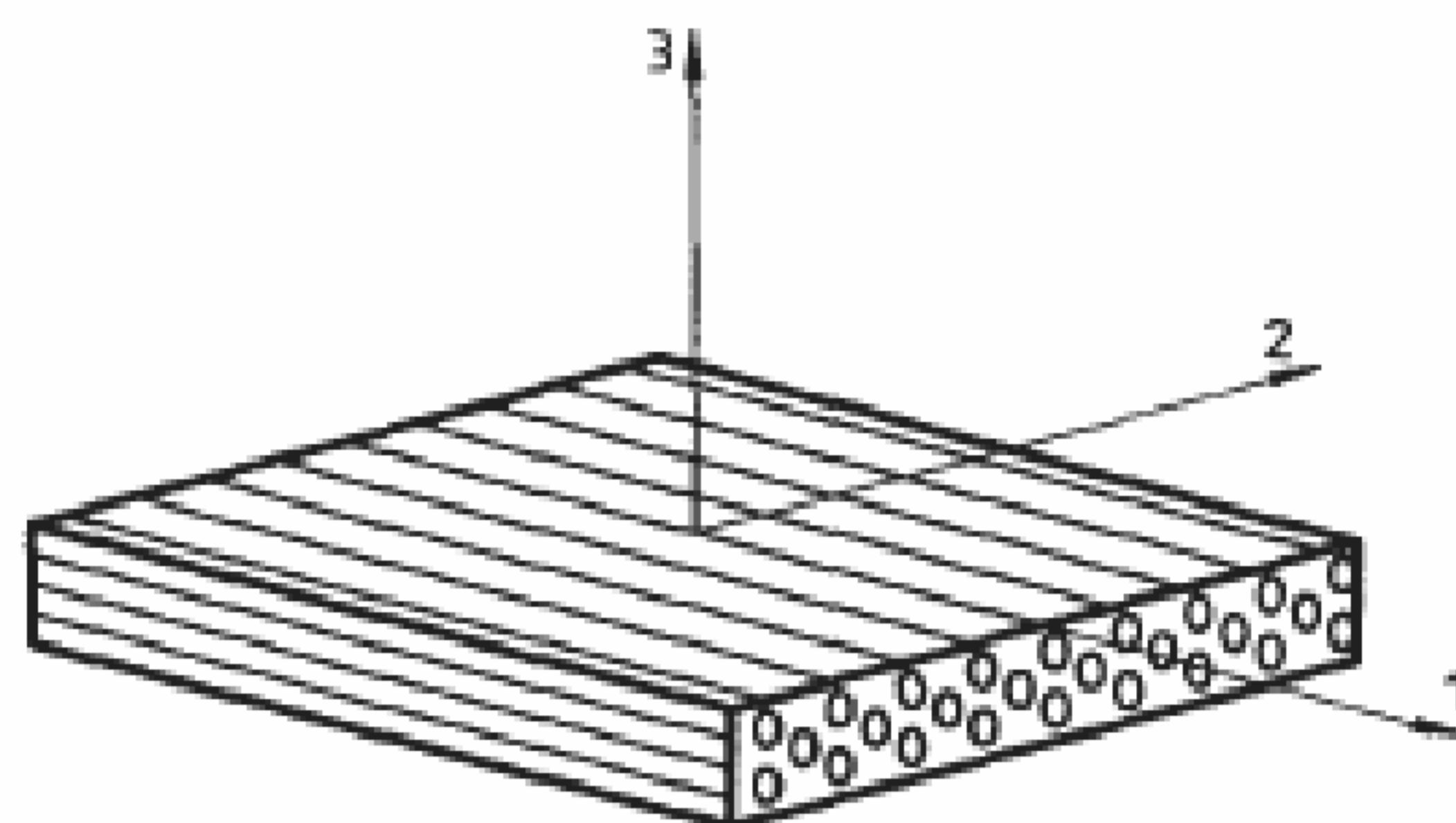
Рисунок 1 — Элемент пластины из композиционного материала, армированного однородным волокном с указанием осей симметрии
