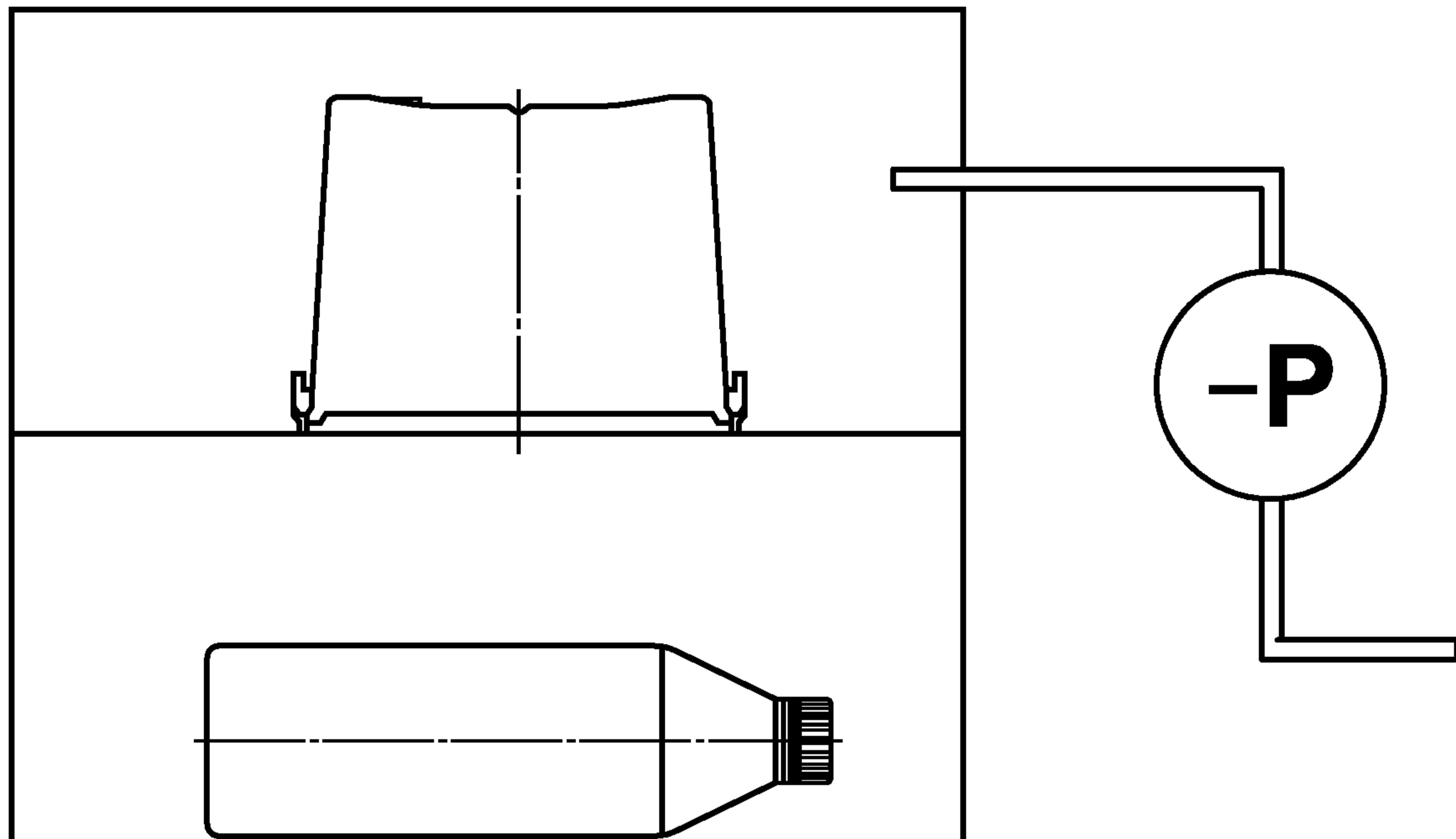
Рисунок 1 — Контроль герметичности тары в вакуумной камере
