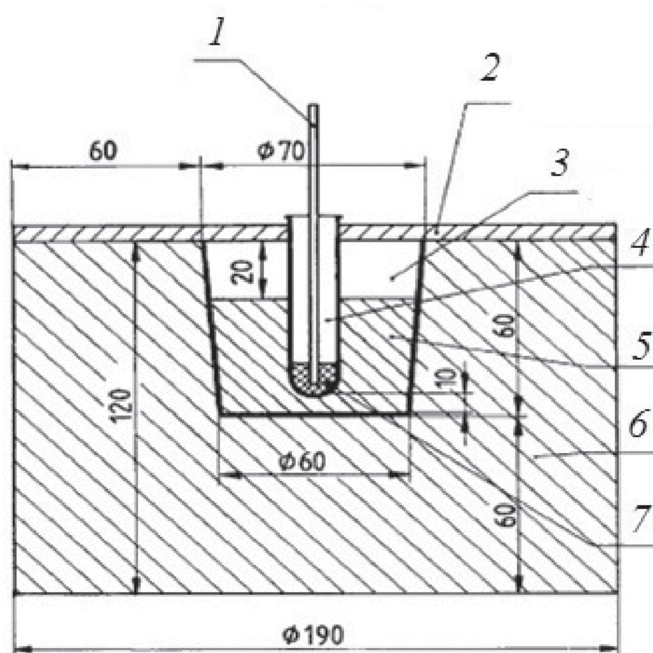
1 — термопара, соединенная с самопищущим регистратором температуры; 2 — крышка для пеноблока; 3 — реакционный сосуд; 4 — пробирка; 5 — реакционная смесь; 6 — пеноблок; 7 — гликоль или другая жидкость
