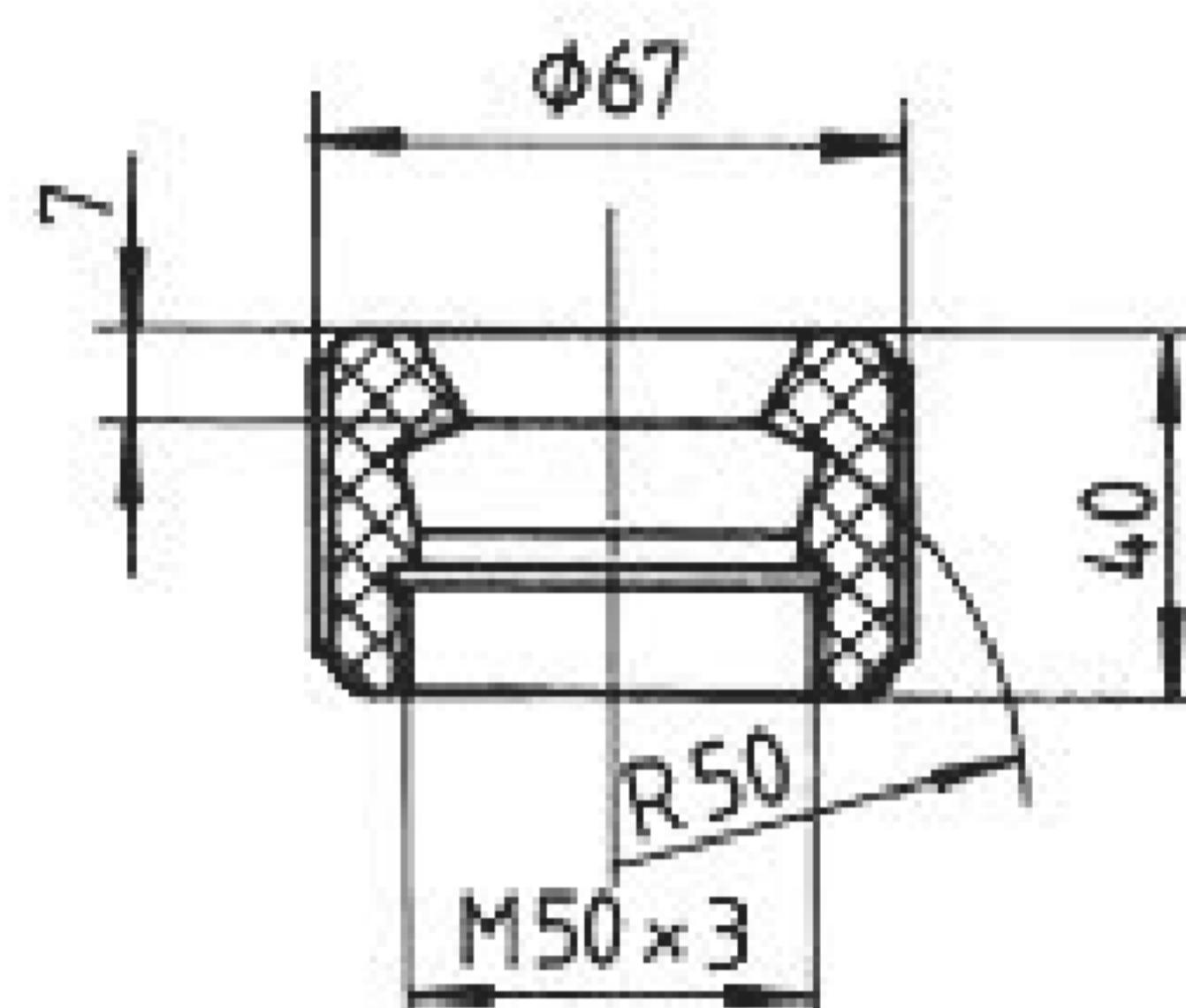
с) Деталь В – устройство сопряжения резьбового соединения с деталью С
