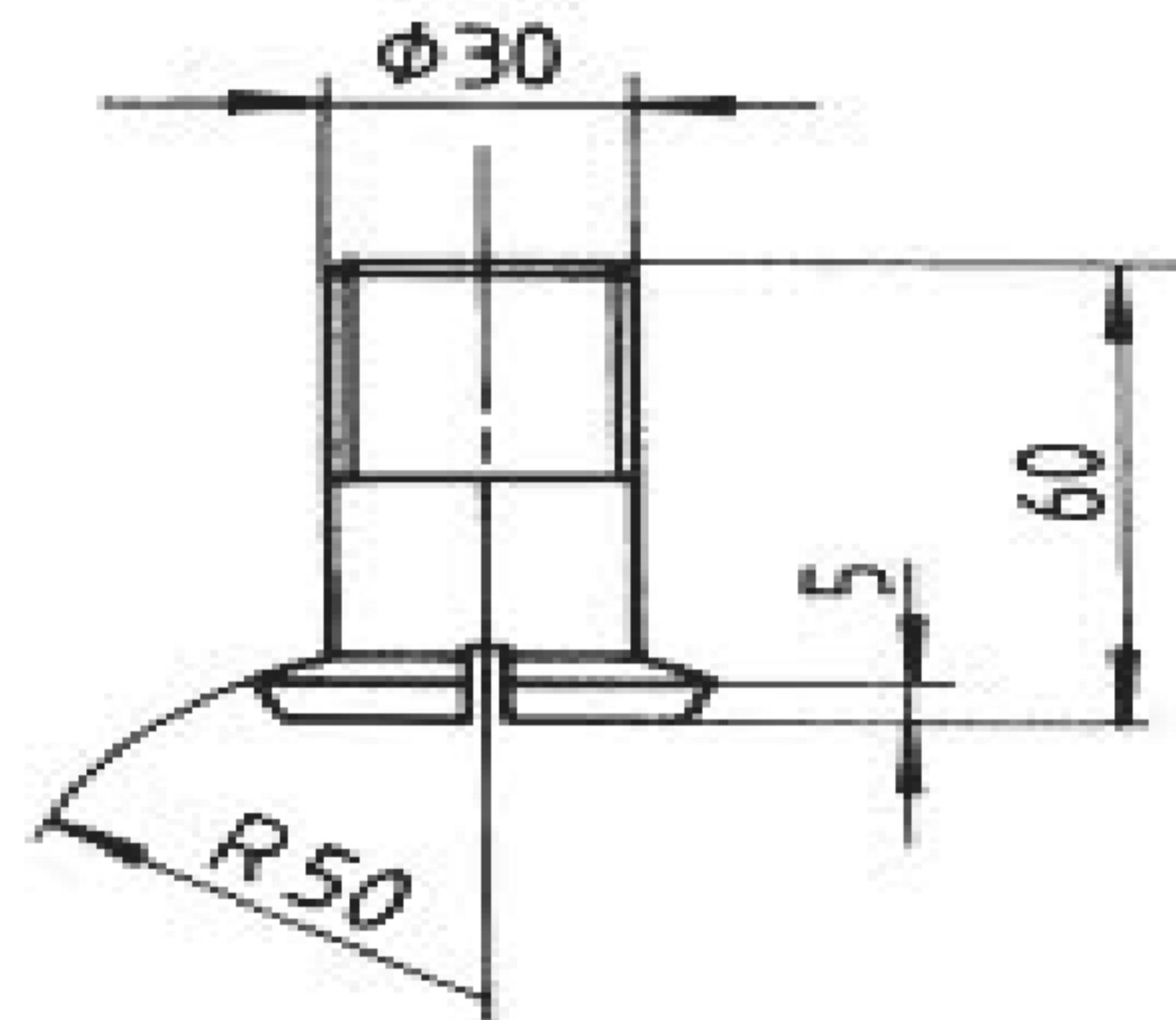
б) Деталь А – хвостовик для крепления в разрывной машине
