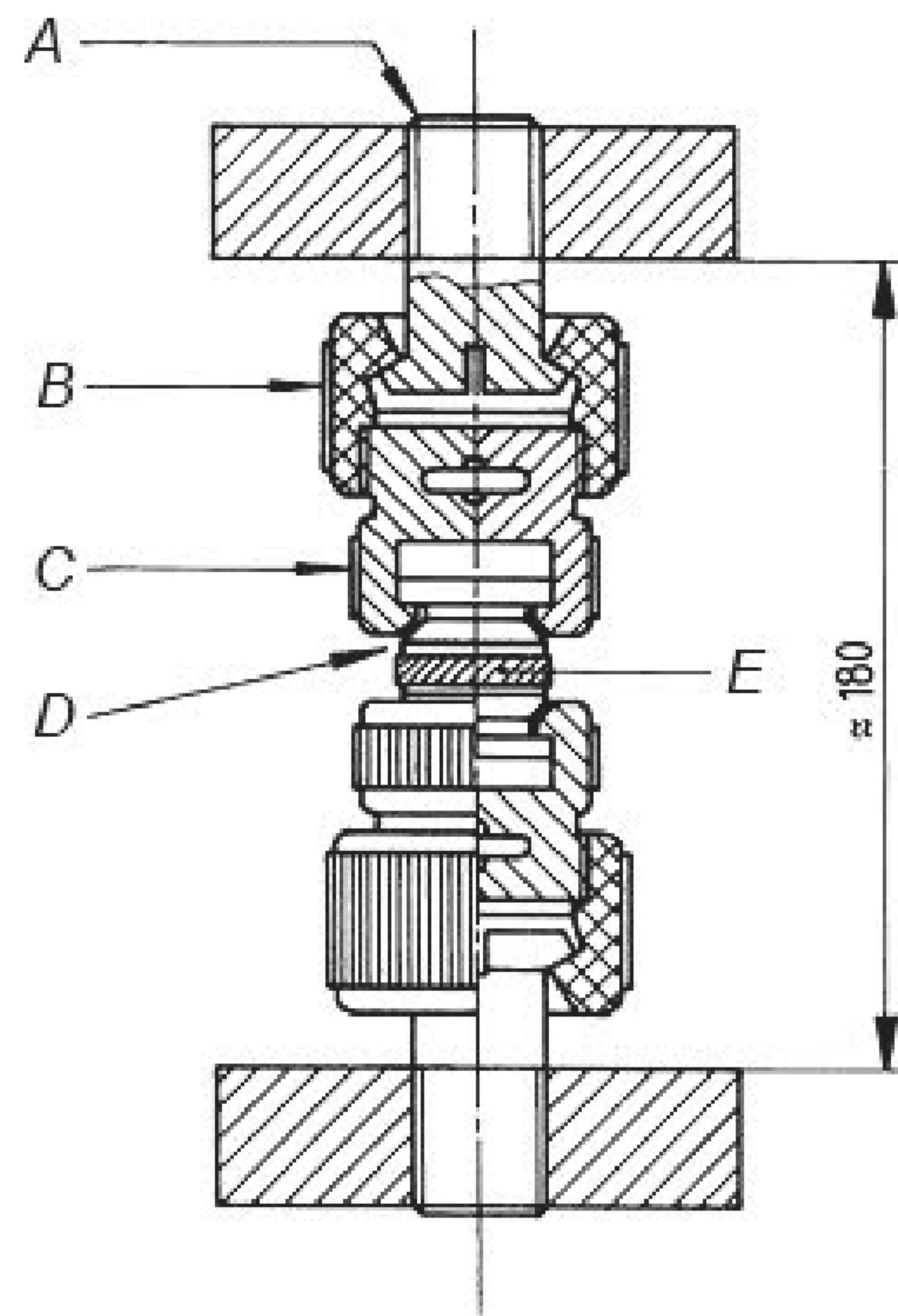
Детали А, В, С приведены ниже, Д – металлическая деталь образца, Е – резина
