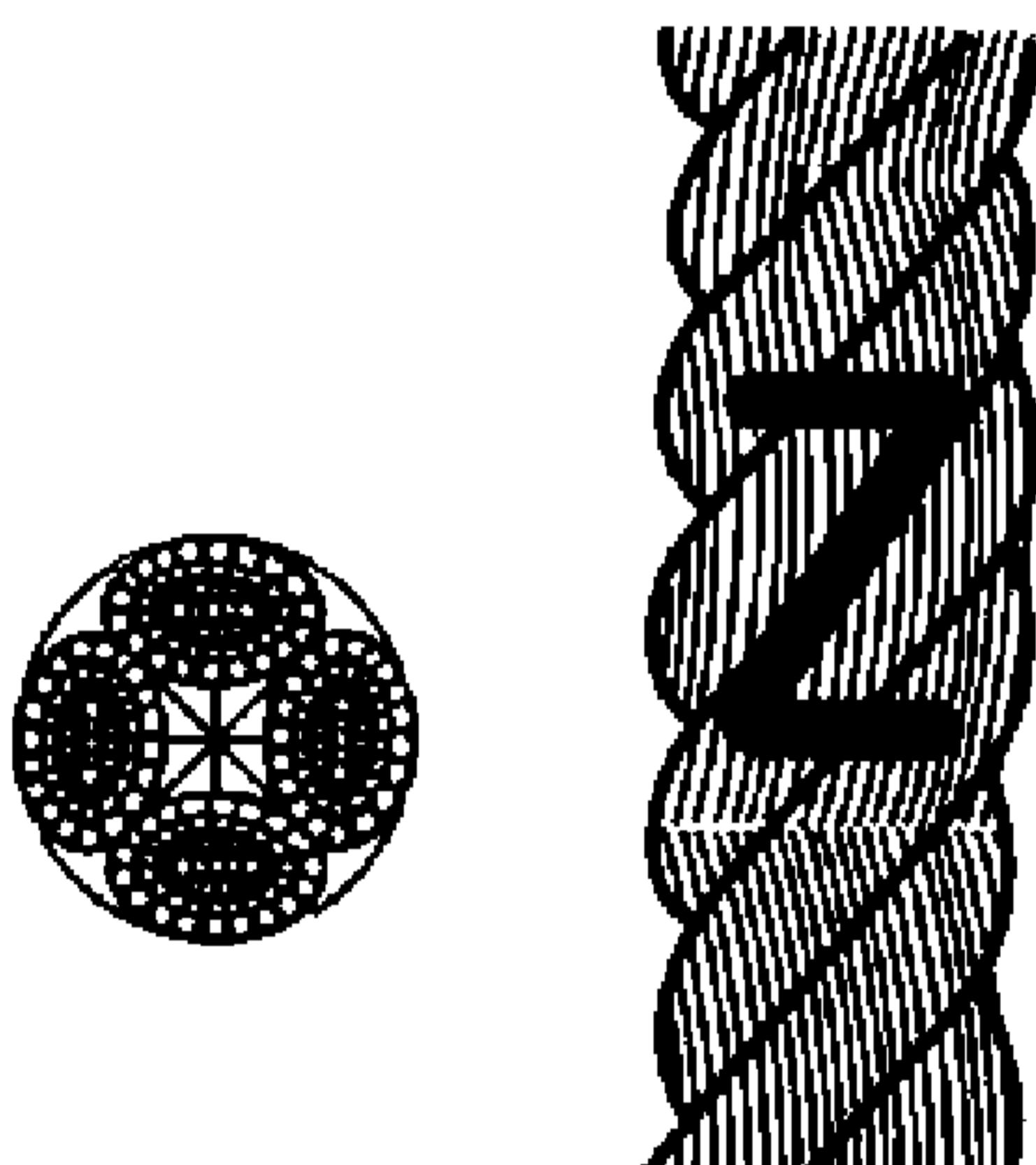
Рисунок 2- Конфигурация 4-прядного кручёного каната (тип В)
