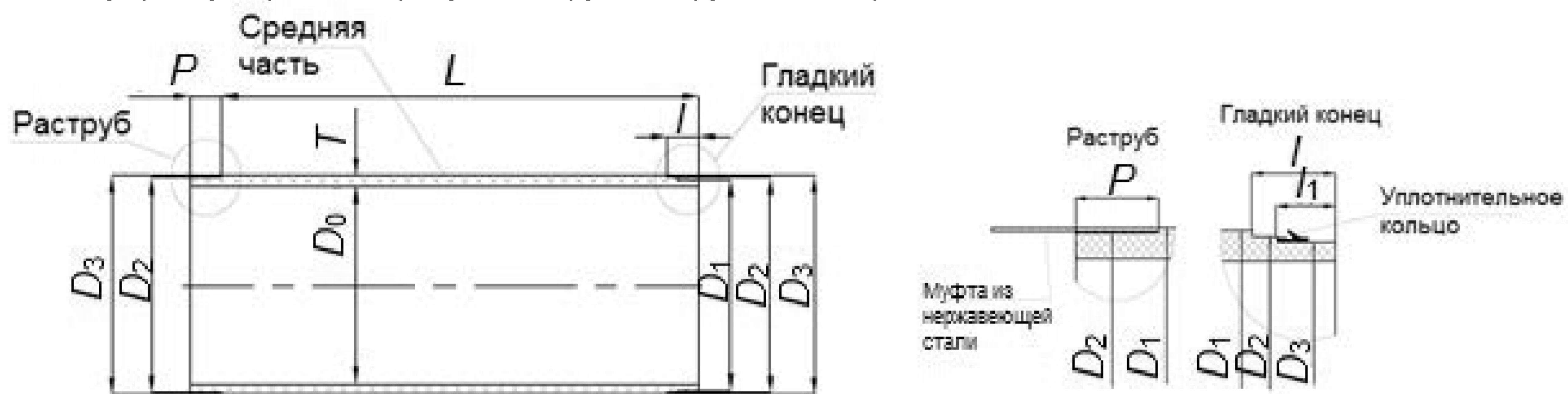
$D_0$  – внутренний диаметр (прямой участок);  $D_1$  – наружный диаметр (средняя часть);  $D_2$  – наружный диаметр;  $D_3$  – наружный диаметр (диаметр уплотняющего кольца);  $L$  – эффективная длина трубы;  $P$  – длина раструба;  $l$  – длина гладкого конца;  $l_1$  – длина паза;  $T$  – толщина стенки трубы
