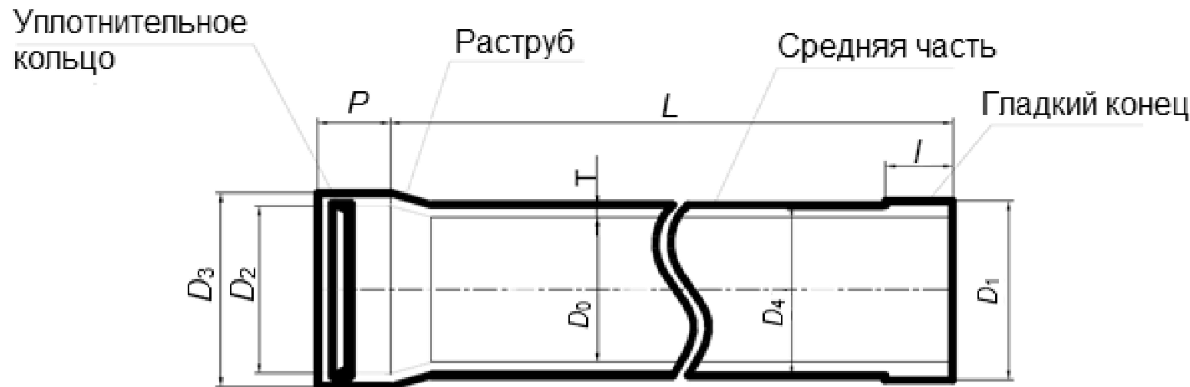
$D_0$  – внутренний диаметр (прямой участок);  $D_1$  – наружный диаметр (вставная часть);  $D_2$  – внутренний диаметр (раstrуб);  $D_3$  – наружный диаметр (раstrуб);  $D_4$  – наружный диаметр (прямой участок);  $L$  – эффективная длина звена трубы;  $P$  – длина раstruba;  $I$  – длина гладкого конца;  $T$  – толщина стенки трубы
