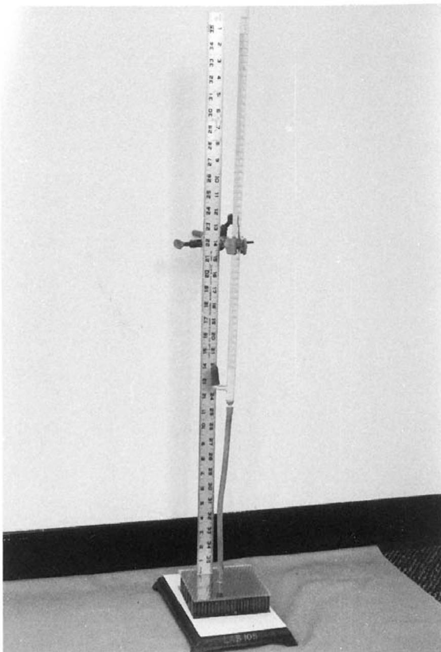
Рисунок 1 — Установка для испытания миграции воды
