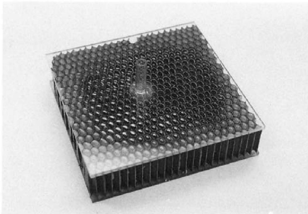
Рисунок 2 — Миграция воды в образце для испытаний
