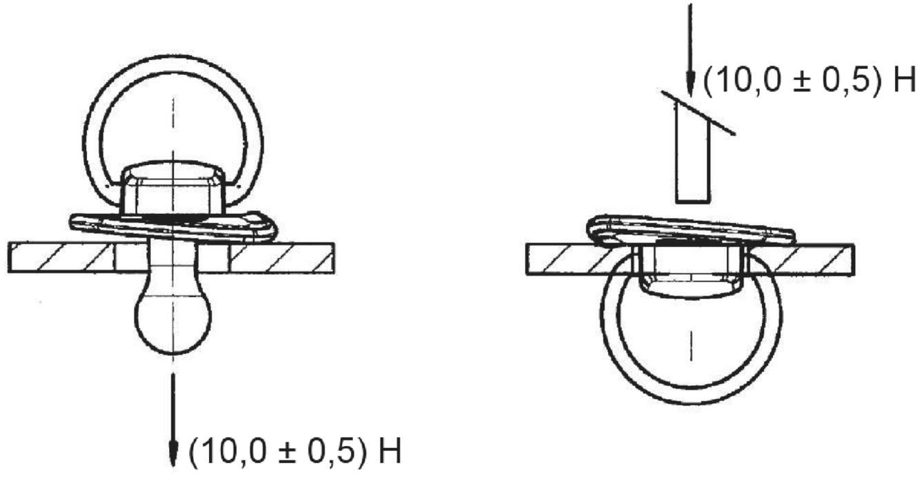
Рисунок 11 – Испытание защитного диска (5.2.3.2)
