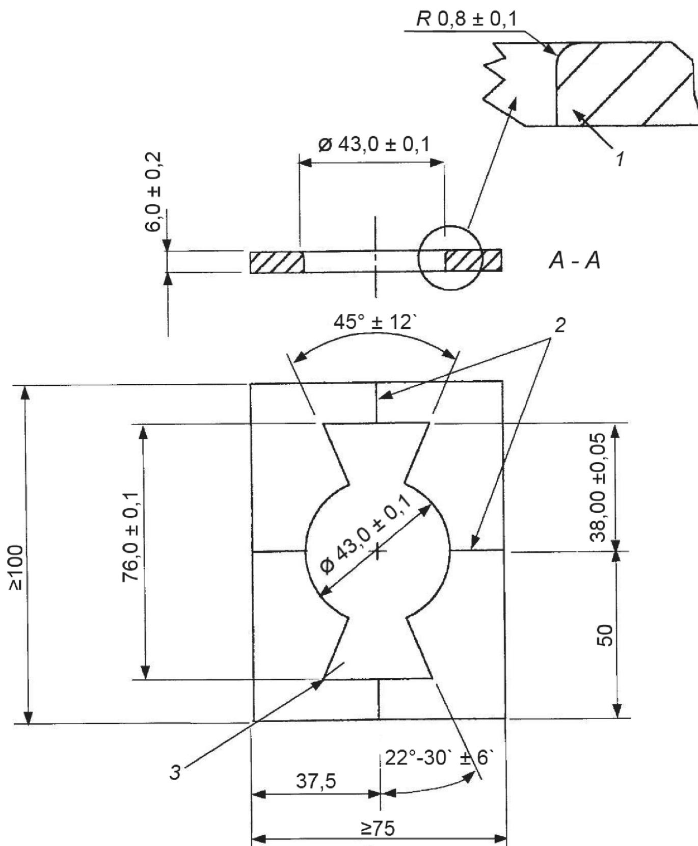
1 – большая часть секции A-A; 2 – постоянные отметки малой и основной осей; 3 – внутренний радиус  $R1$  (4 угла)
