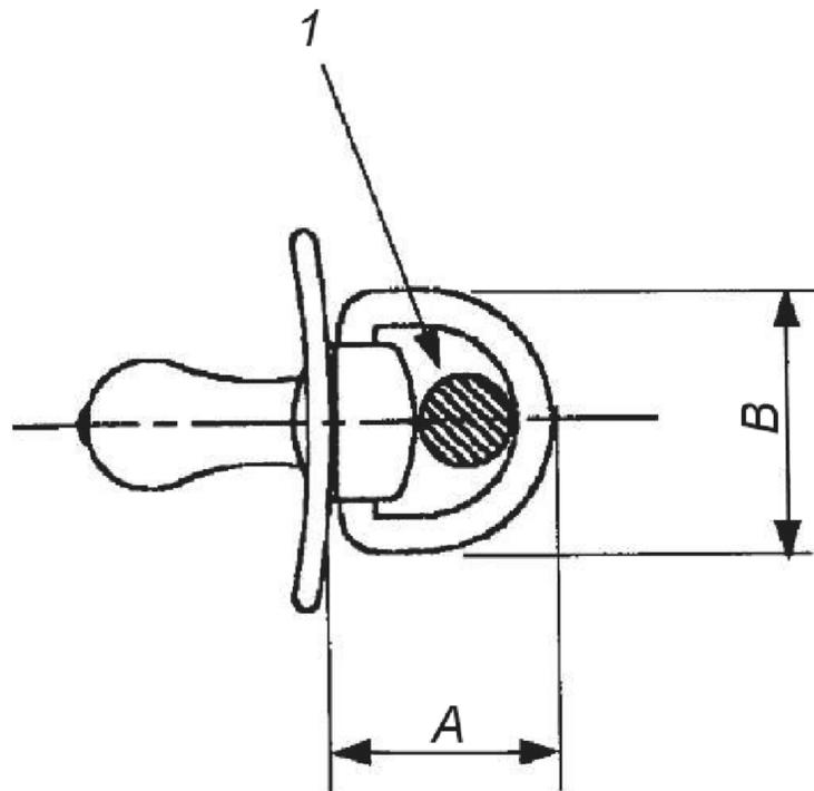
A – размер A; B – размер B; 1 – поперечное сечение стержня диаметром 14 мм
