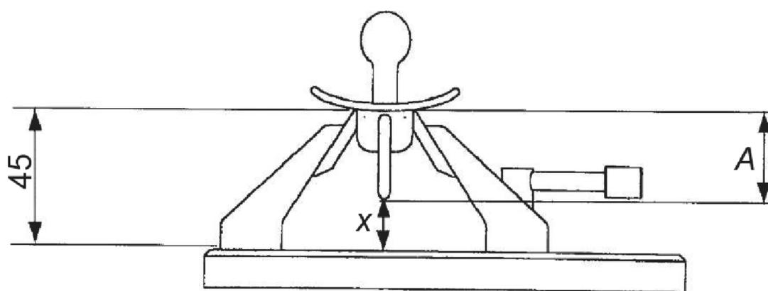
A – размер A; x – расстояние между нижней поверхностью кольца и верхней поверхностью эталонной плитки
