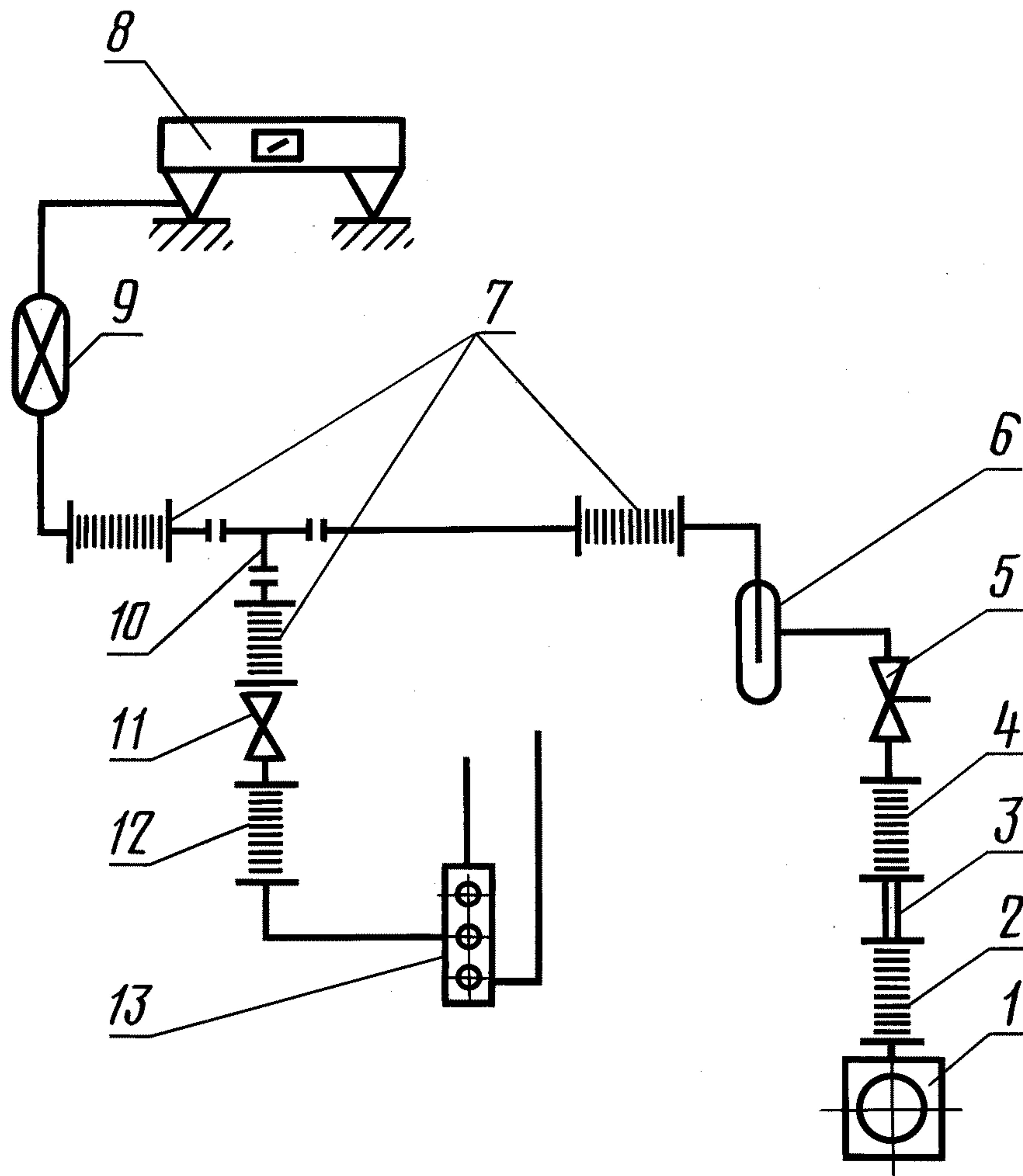
1 — вакуумный насос; 2, 4, 7, 12 — резиновые вакуумные трубы; 3 — металлическая труба; 5 — трехходовой кран; 6 — ловушка; 8 — вакуумметр; 9 — манометрический преобразователь; 10 — тройник; 11 — двухходовой кран; 13 — струбцина
