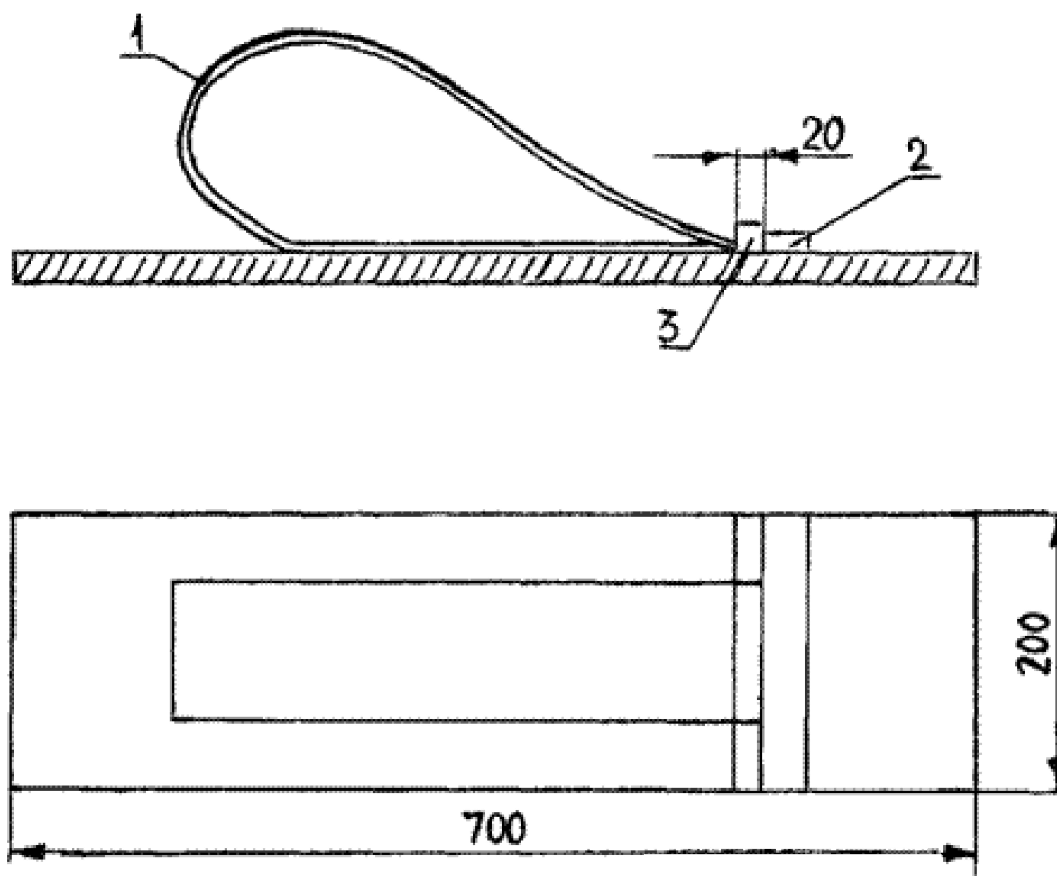
1 – образец для испытания; 2 – заплечик; 3 – стальной бруск
