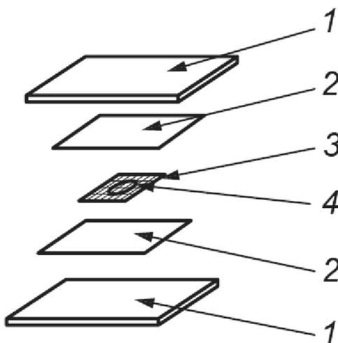
1 — плита пресса; 2 — полиэфирная пленка; 3 — хромникелевая сетка; 4 — образец
