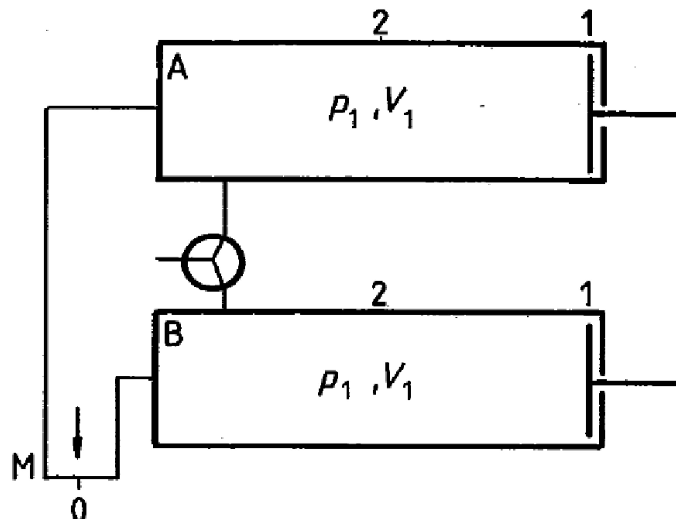
А – камера А; В – камера В; М – манометр;  $p_1$  – атмосферное давление;  $V_1$  – объем камеры;
