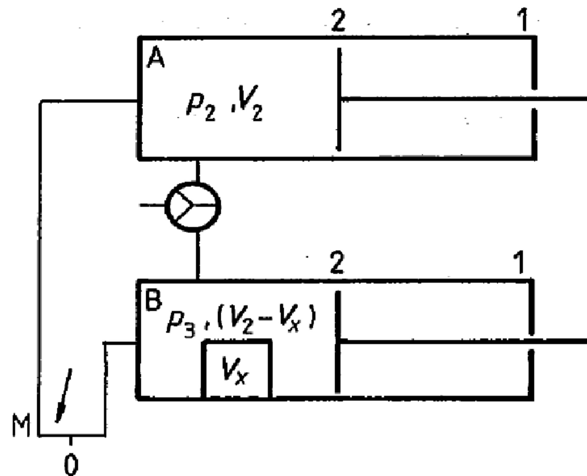
А – камера А; В – камера В; М – манометр;  $p_2$  – давление в камере А;
