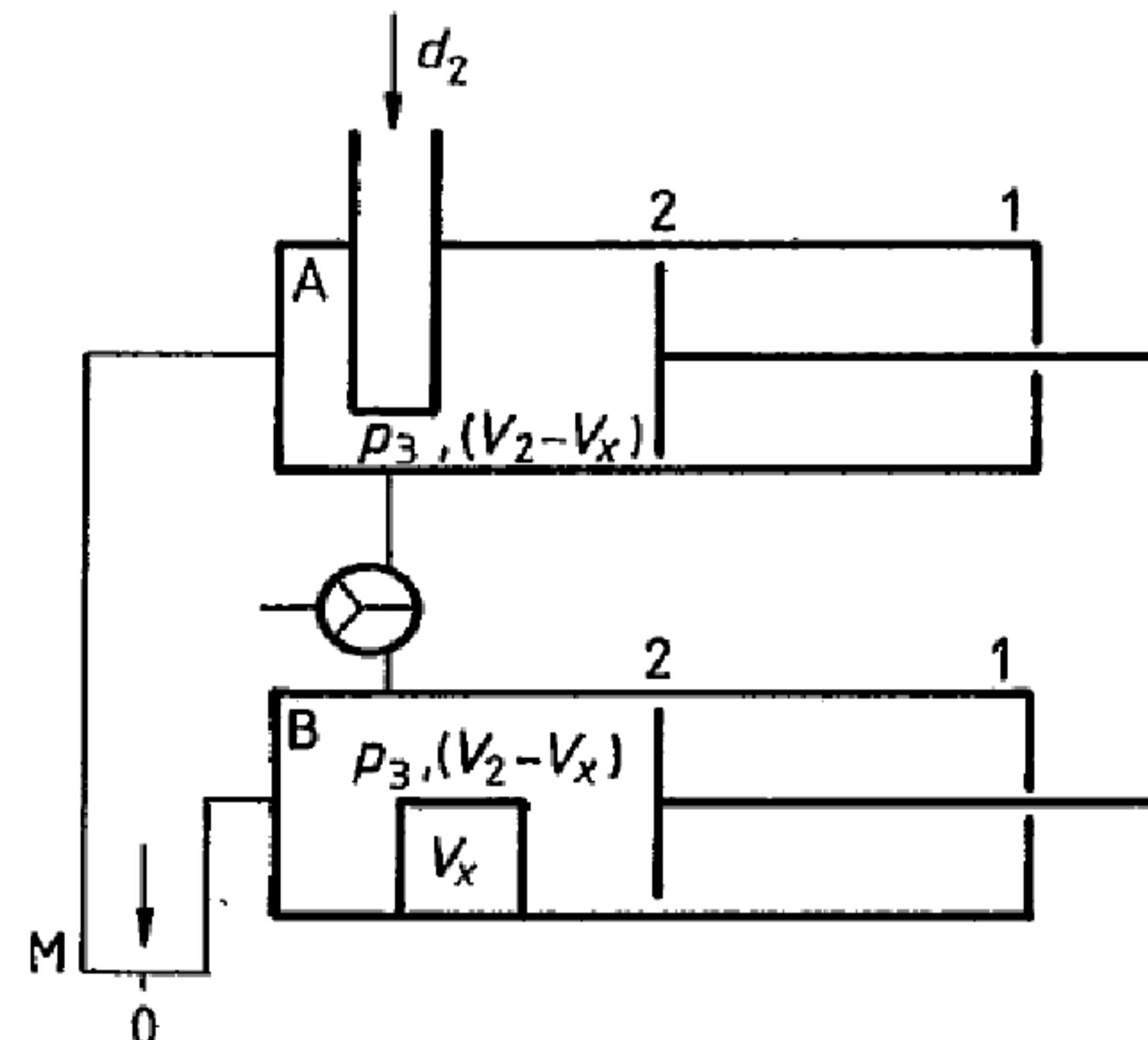
А – камера А; В – камера В; М – манометр;  $p_3$  – давление в камере;  $V_2$  – объем камеры;  $V_x$  – объем образца;
