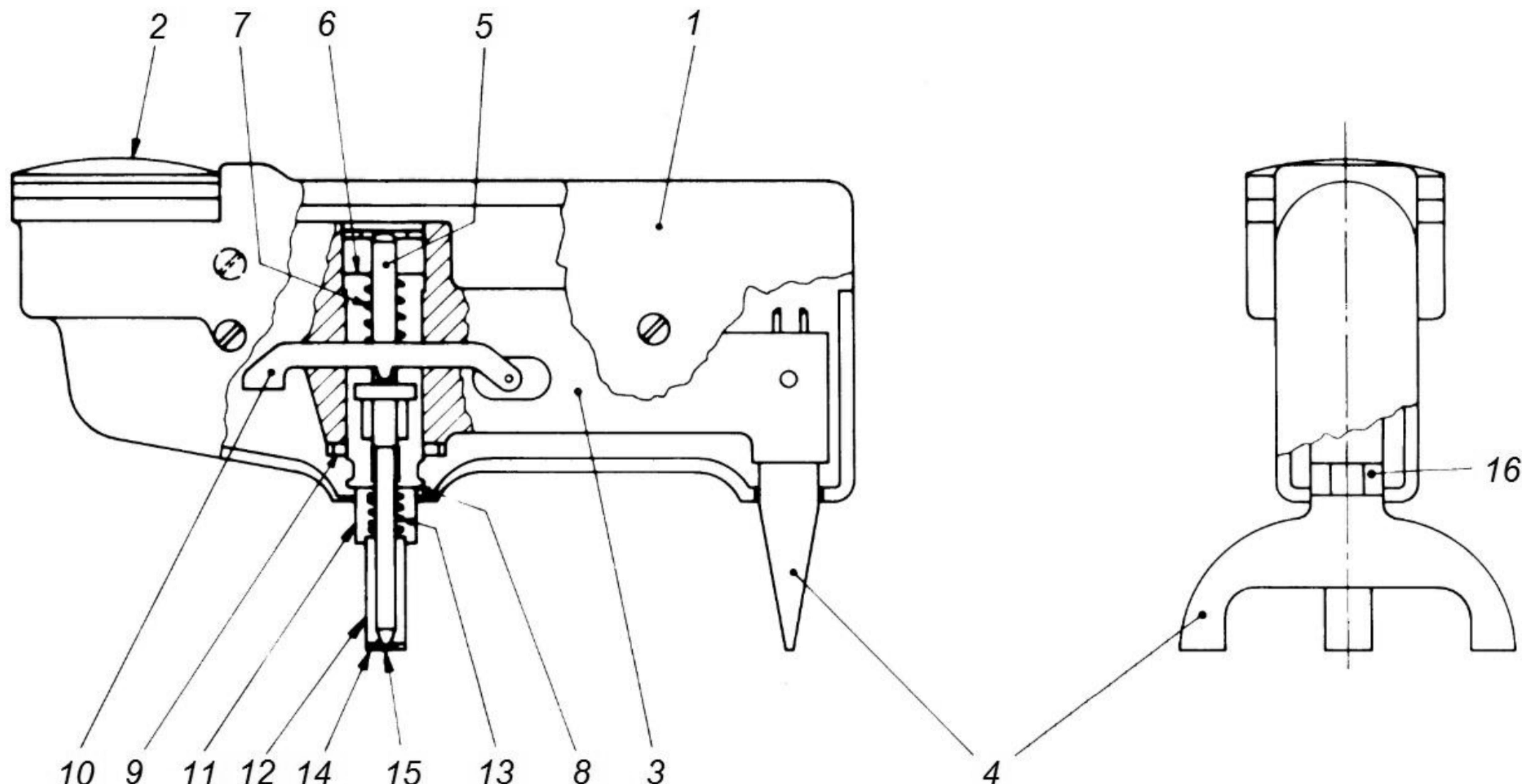
1 – кожух; 2 – индикаторное устройство; 3 – корпус; 4 – опора; 5 – плунжер; 6 – верхняя гайка с направлением плунжера; 7 – пружина; 8 – нижняя гайка с направлением плунжера; 9 – стопорная гайка; 10 – рычаг; 11 – неподвижная втулка; 12 – подвижная направляющая втулка; 13 – пружина подвижной направляющей втулки; 14 – направляющее кольцо; 15 – наконечник индентора; 16 – регулировочное кольцо
