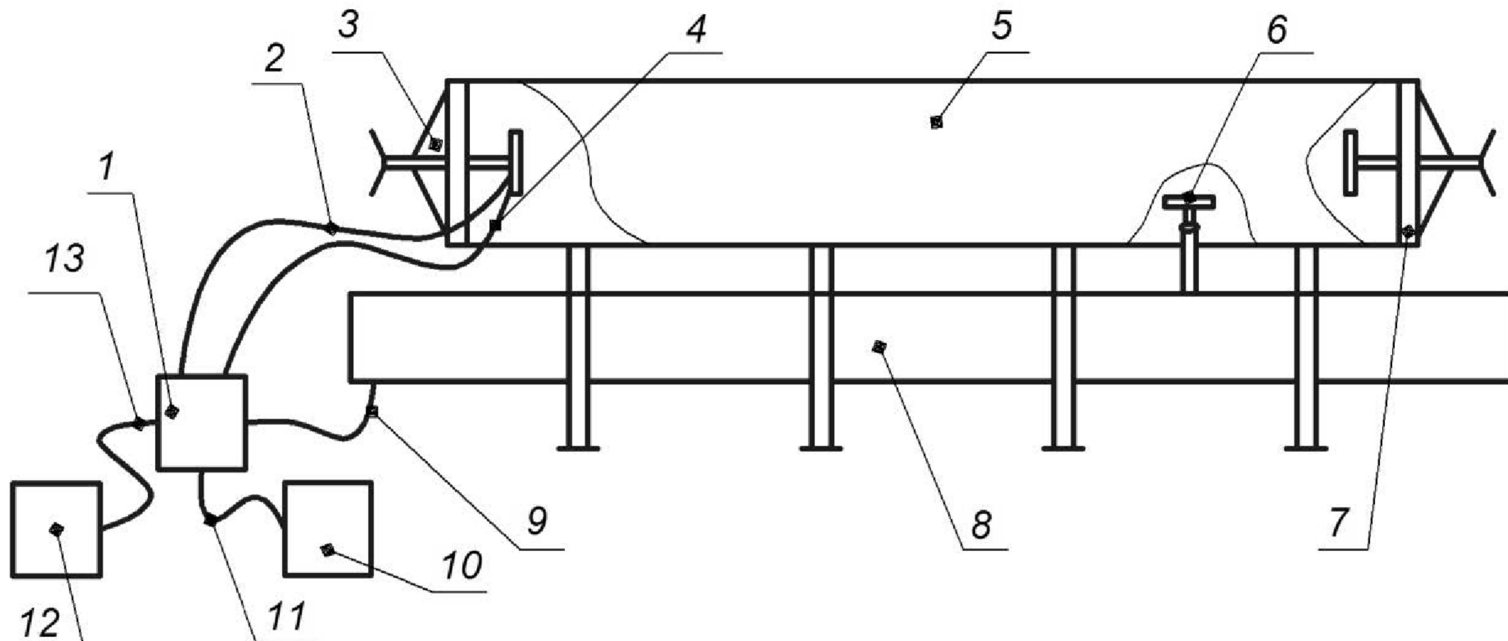
1 – гидропульт; 2 – рукав высокого давления; 3 – неподвижная опора с узлом зажима; 4 – рукав низкого давления; 5 – бронекамера; 6 – опорный люнет; 7 – подвижная опора с узлом зажима; 8 – бак; 9 – циркуляционный рукав; 10 – насос низкого давления; 11 – рукав низкого давления; 12 – насос высокого давления; 13 – рукав высокого давления
