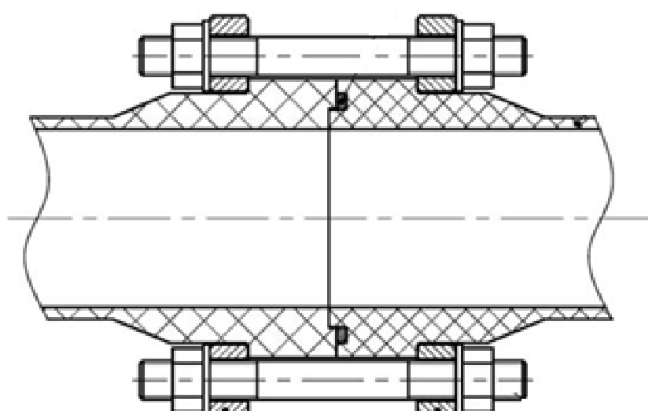
Рисунок А.6 – Вариант фланцевого соединения труб
