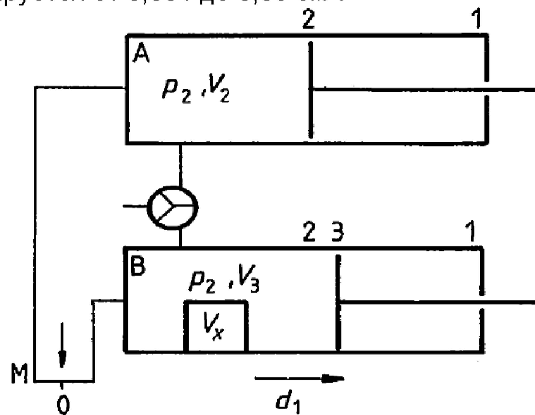
А – камера А; В – камера В; М – манометр;  $p_2$  – давление;  $V_2$  – объем камеры А;  $V_3$  – объем камеры В;  $V_x$  – объем образца;
