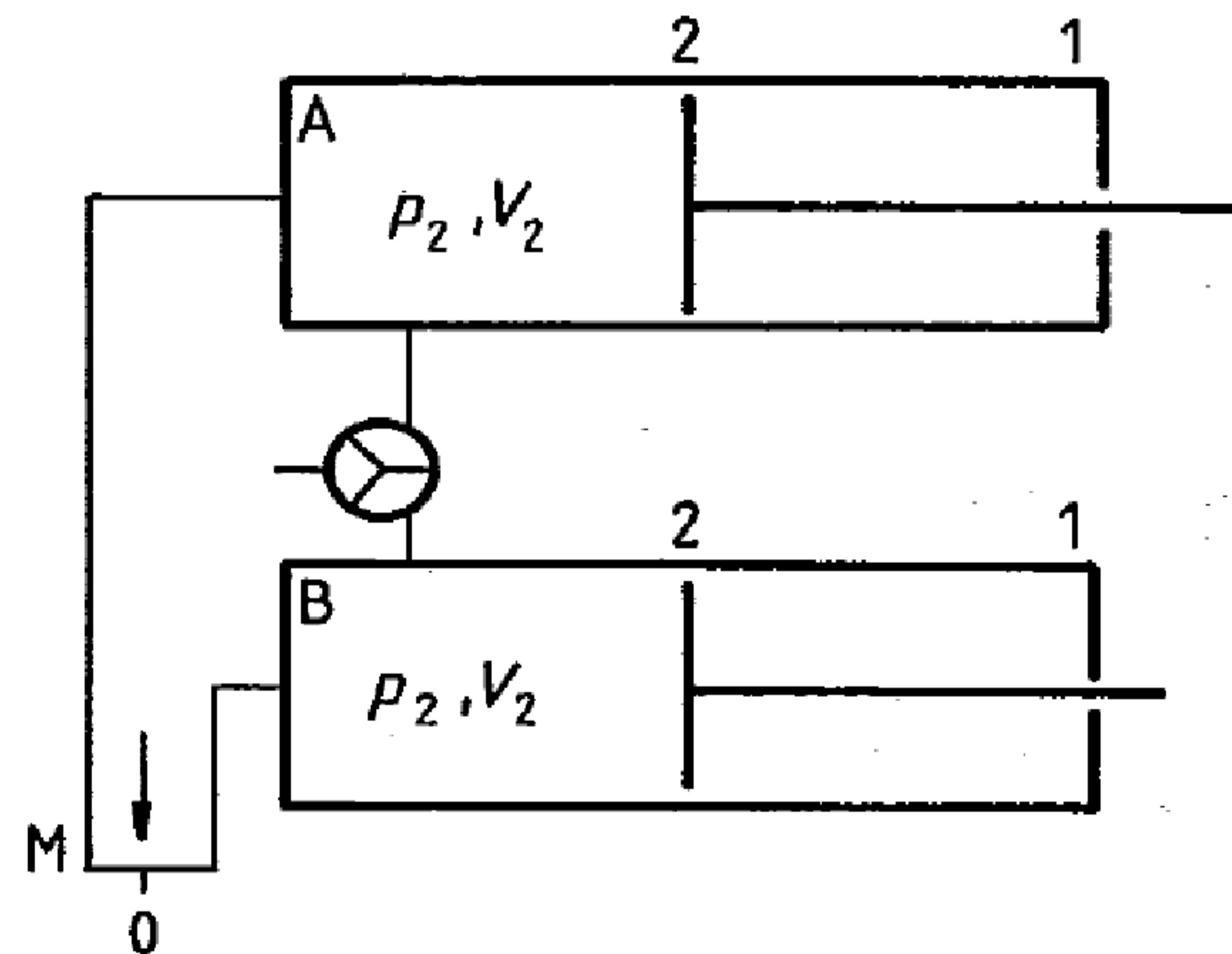
А – камера А; В – камера В; М – манометр;  $p_2$  – давление;  $V_2$  – объем камеры;
