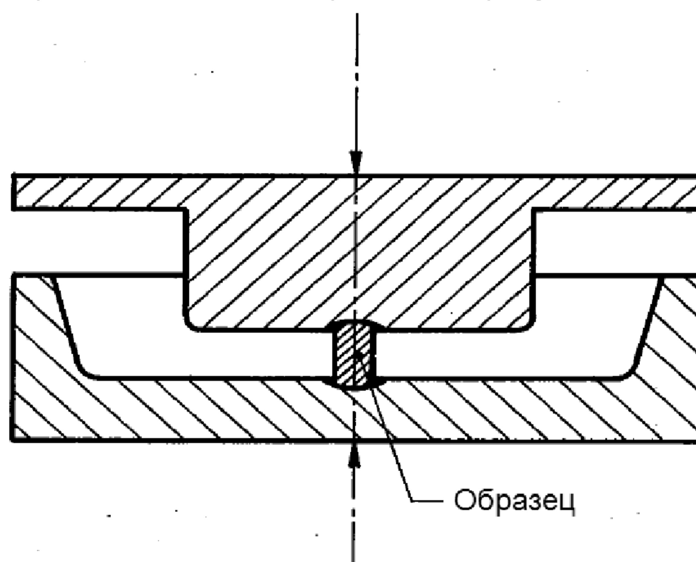
Рисунок В.1 – Штамповка для измельчения
