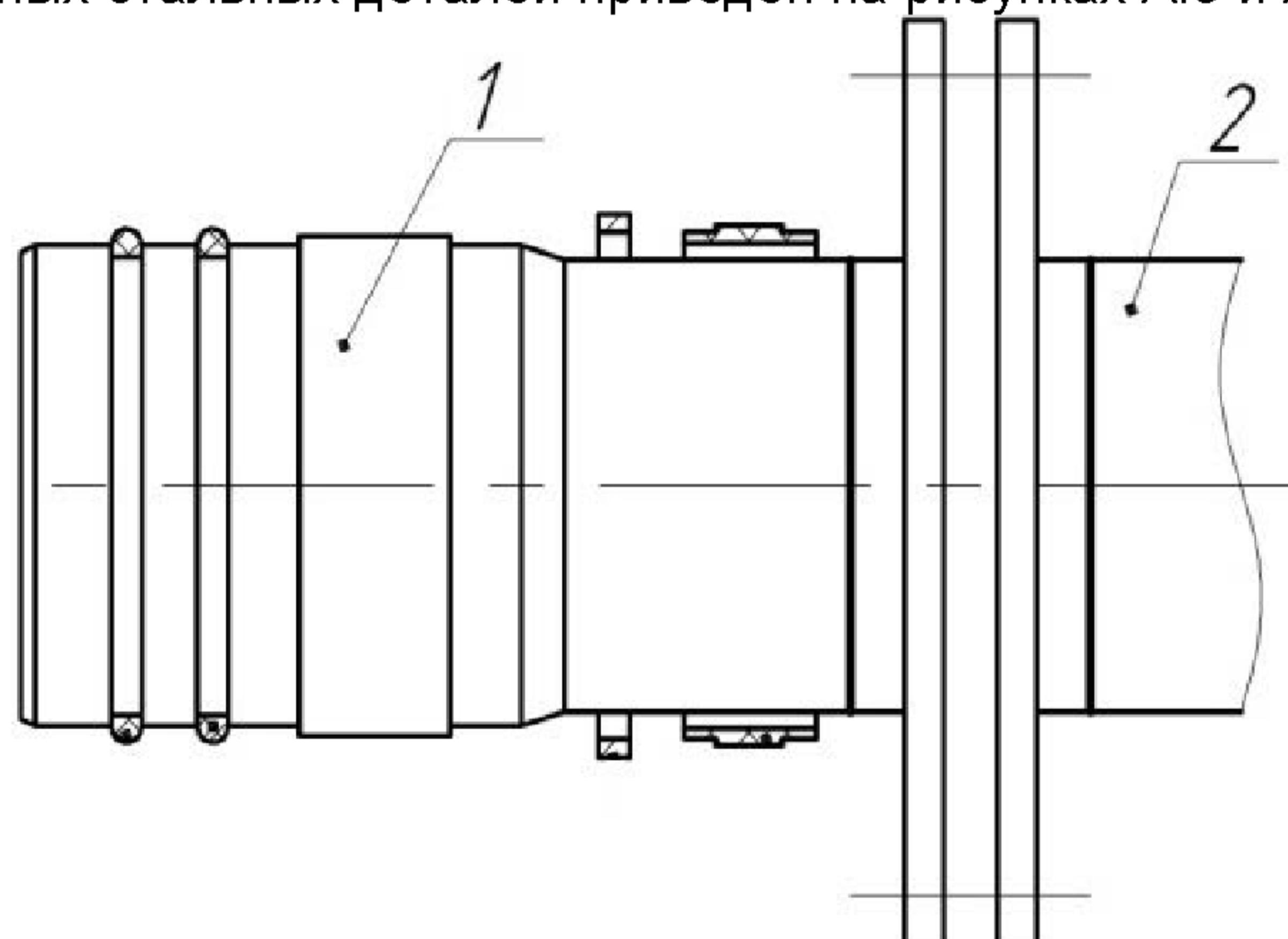
1 – переходная деталь; 2 – фитинг или переходная деталь трубопровода с приварным фланцем
