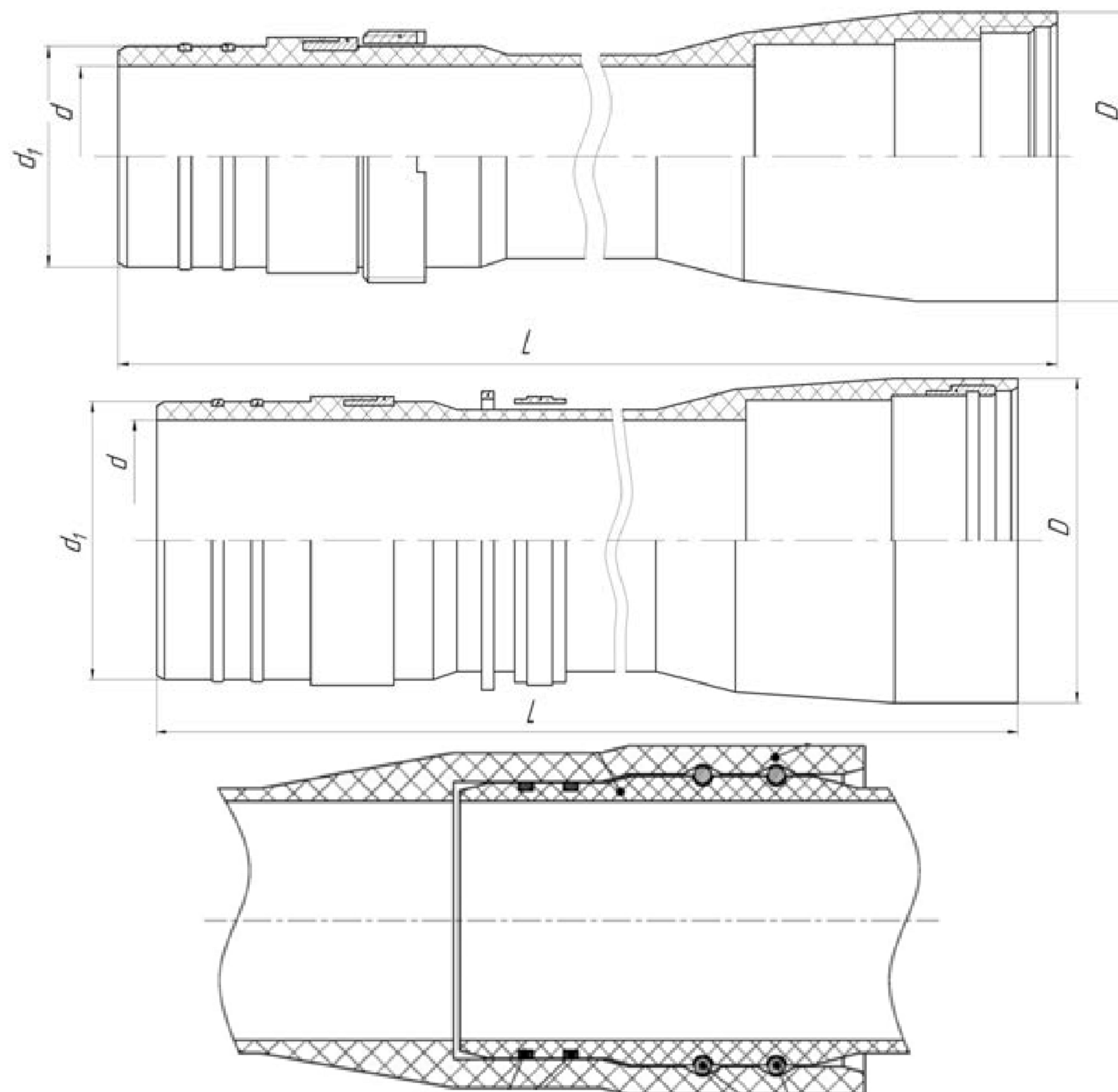
$d$  – номинальный диаметр трубы;  $d_1$  – диаметр ниппельной части трубы;
