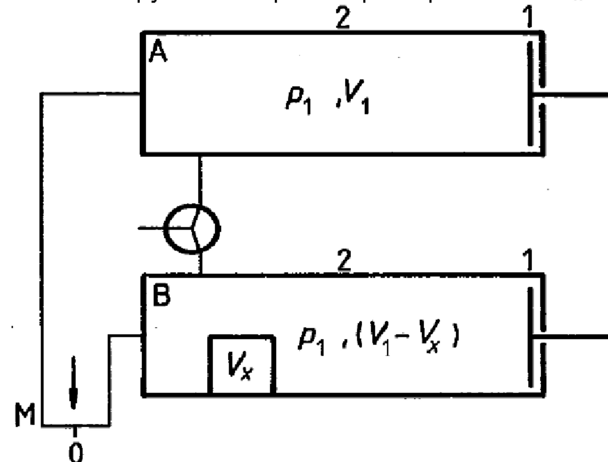
А – камера А; В – камера В; М – манометр;  $p_1$  – атмосферное давление;
