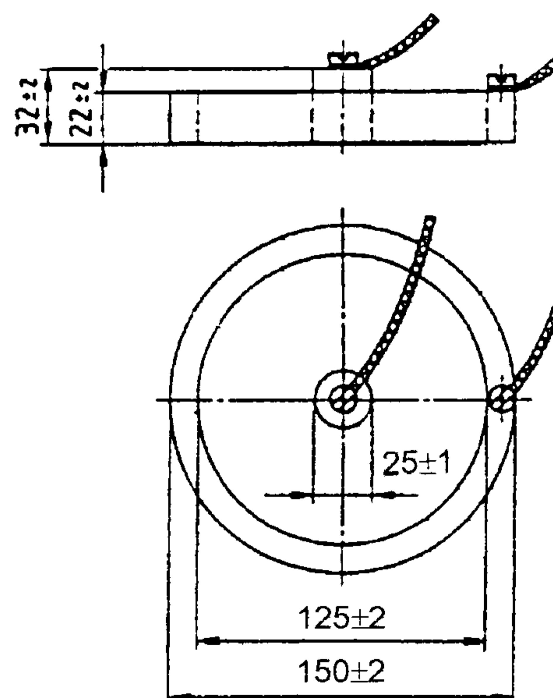
Рисунок Б.1 – Схема размещения электродов при испытании
