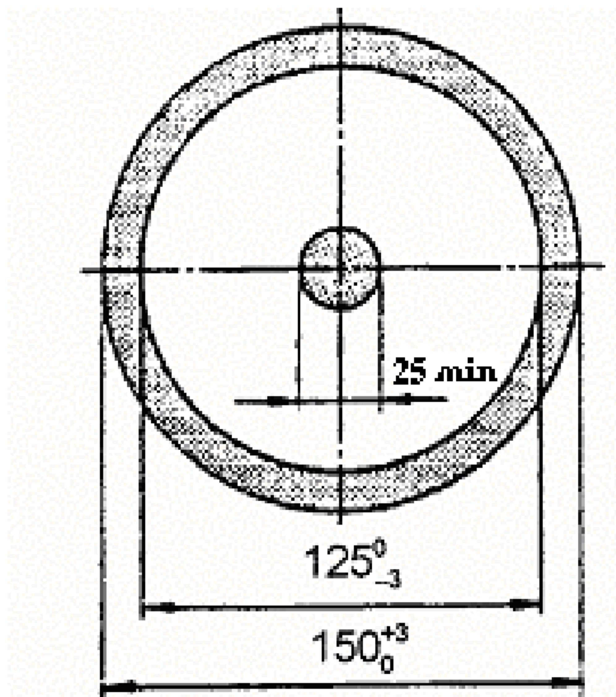
Рисунок Б.2—Схема шаблона
