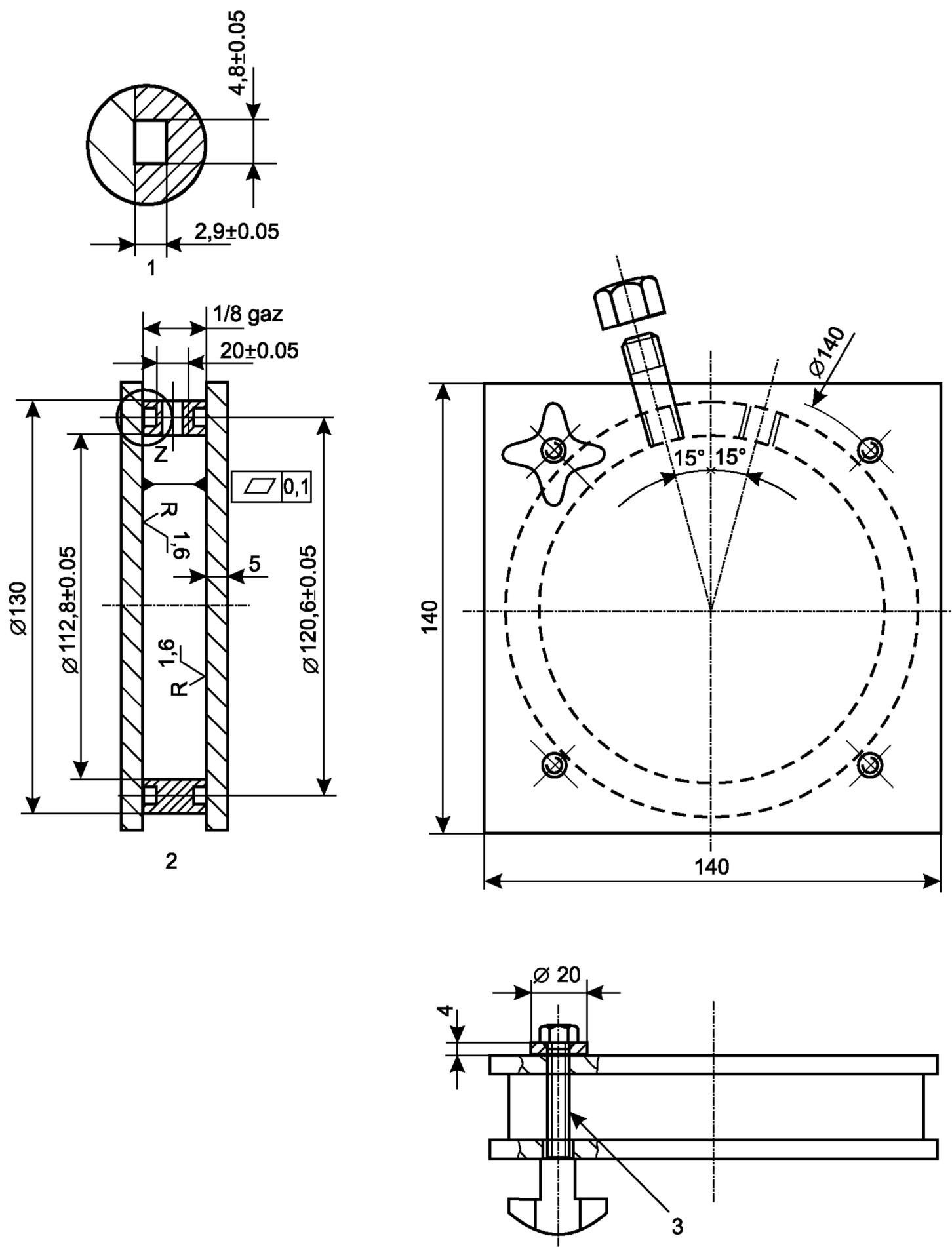
1 – деталь Z; 2 – уплотнительное кольцо  $\varnothing 117,07 / 124,13 / 3,53$ ; 3 – винт НМF-50
