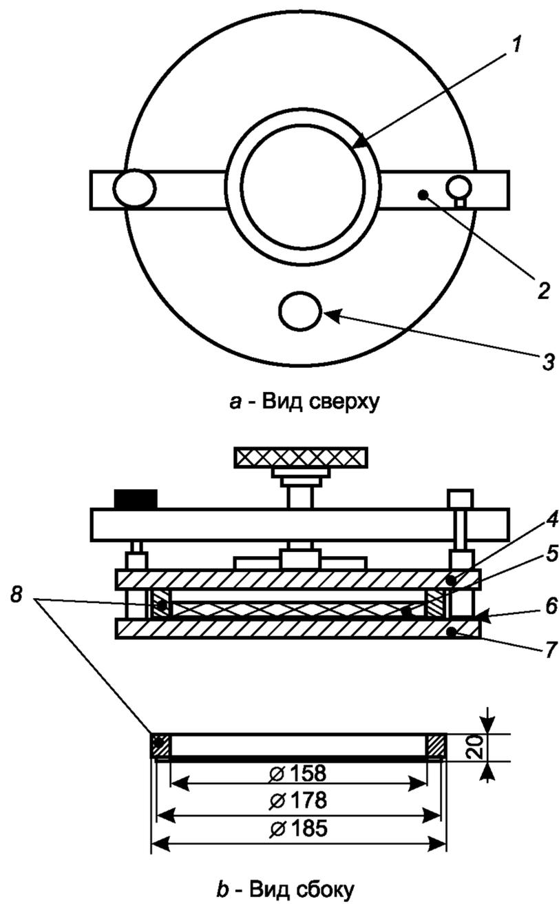
1 – зажимной винт; 2 – прижимная планка; 3 – пробка заливного отверстия; 4 – крышка; 5 – имитатор пищевого продукта;
