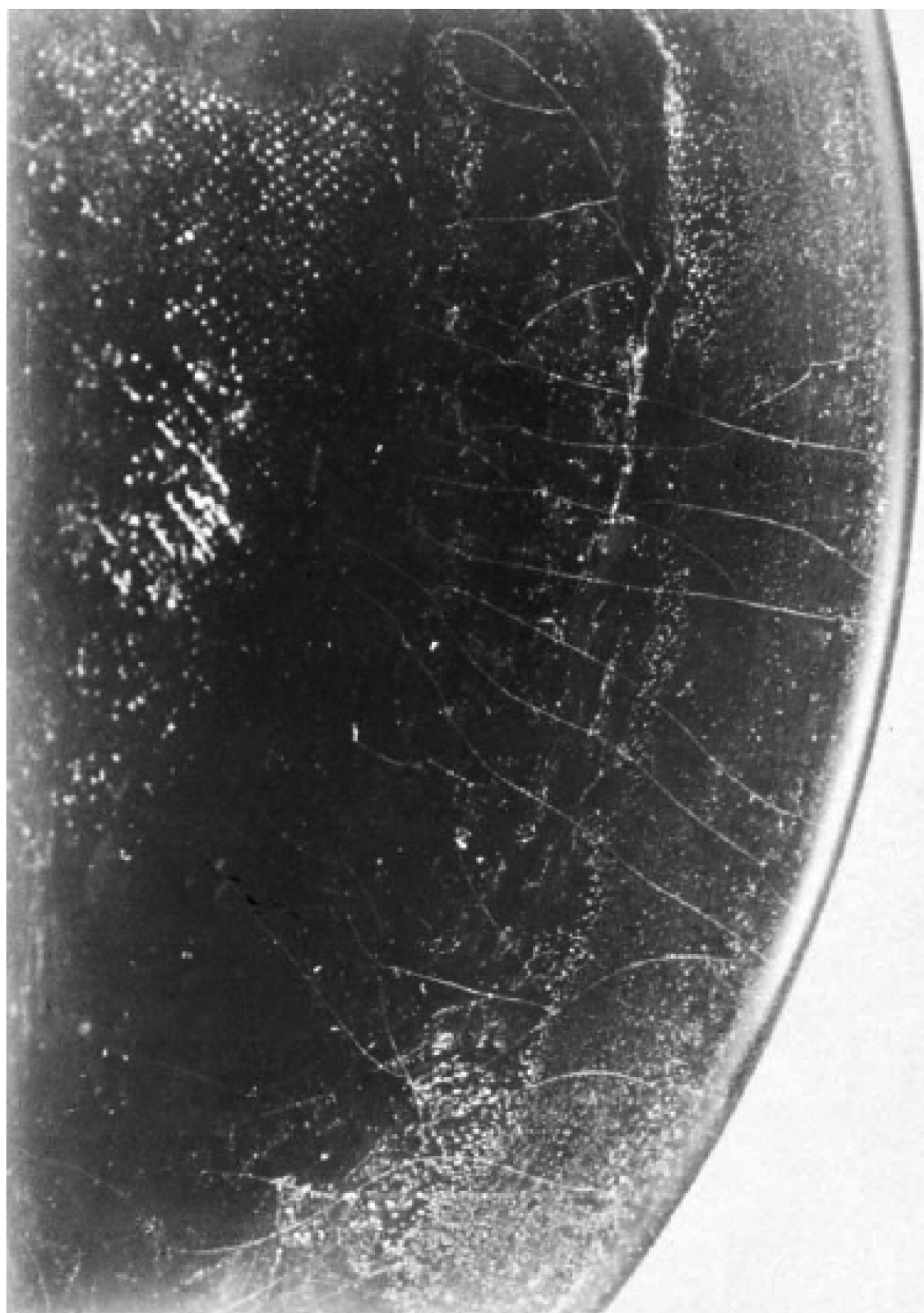
Рисунок А.2 — Волосая трещина
