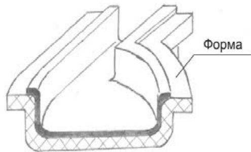
Рисунок А.1 – Формовой способ изготовления корпуса вентилятора
