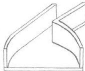
Рисунок А.2 – Сборный способ изготовления корпуса вентилятора
