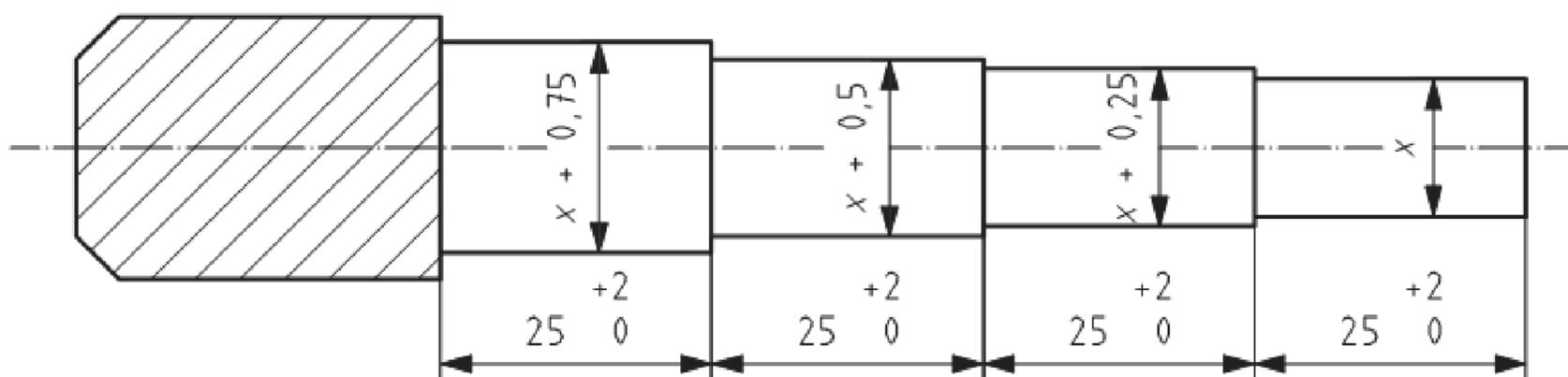
Рисунок 1 — Калибры-пробки
