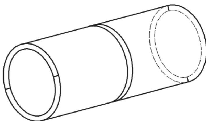
б) Образец, разрезанный пополам
