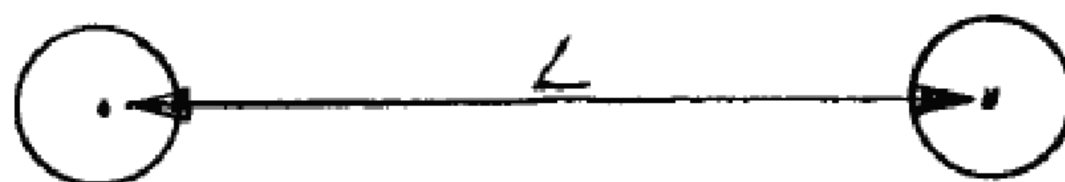
Рисунок A2.2 — Маркировки на вращающихся опорах образца
