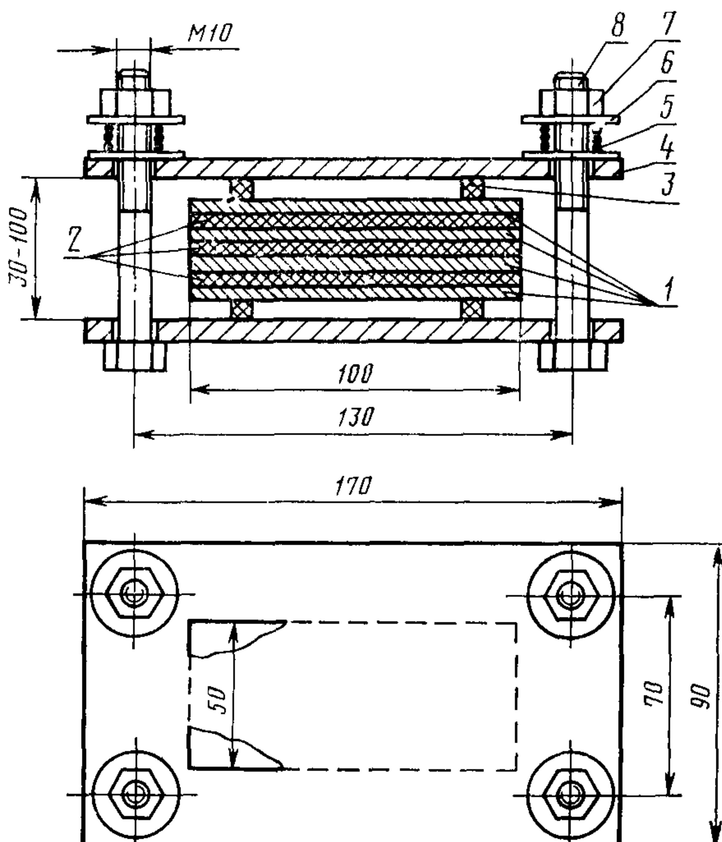
1—образцы металла; 2—образцы полимерного материала; 3—бруск 5×5 мм из коррозионно-неагрессивного материала, например, из титанового сплава марки ОТ 4—1 по ГОСТ 19807—74; 4—металлическая пластина струбцины; 5—пружина по ГОСТ 13770—68; 6—шайба по ГОСТ 11371—78; 7—гайка по ГОСТ 5915—70; 8—болт по ГОСТ 7798—70.
