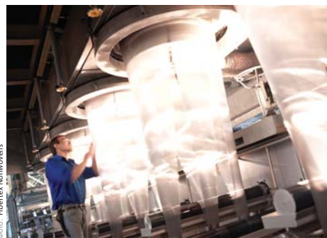
Экструзия нетканых материалов на заводе датской компании Fibertex Nonwovens A/S
