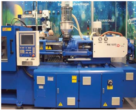
Термопластавтоматы Haitian серии ТПА PL-1600 используют для производства хозяйственно-бытовых изделий
