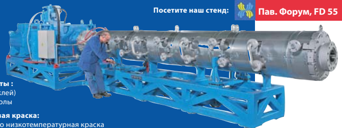
Самый большой в мире планетарный вальцевый экструдер для эластомеров TP-WE4005/5600-M4
